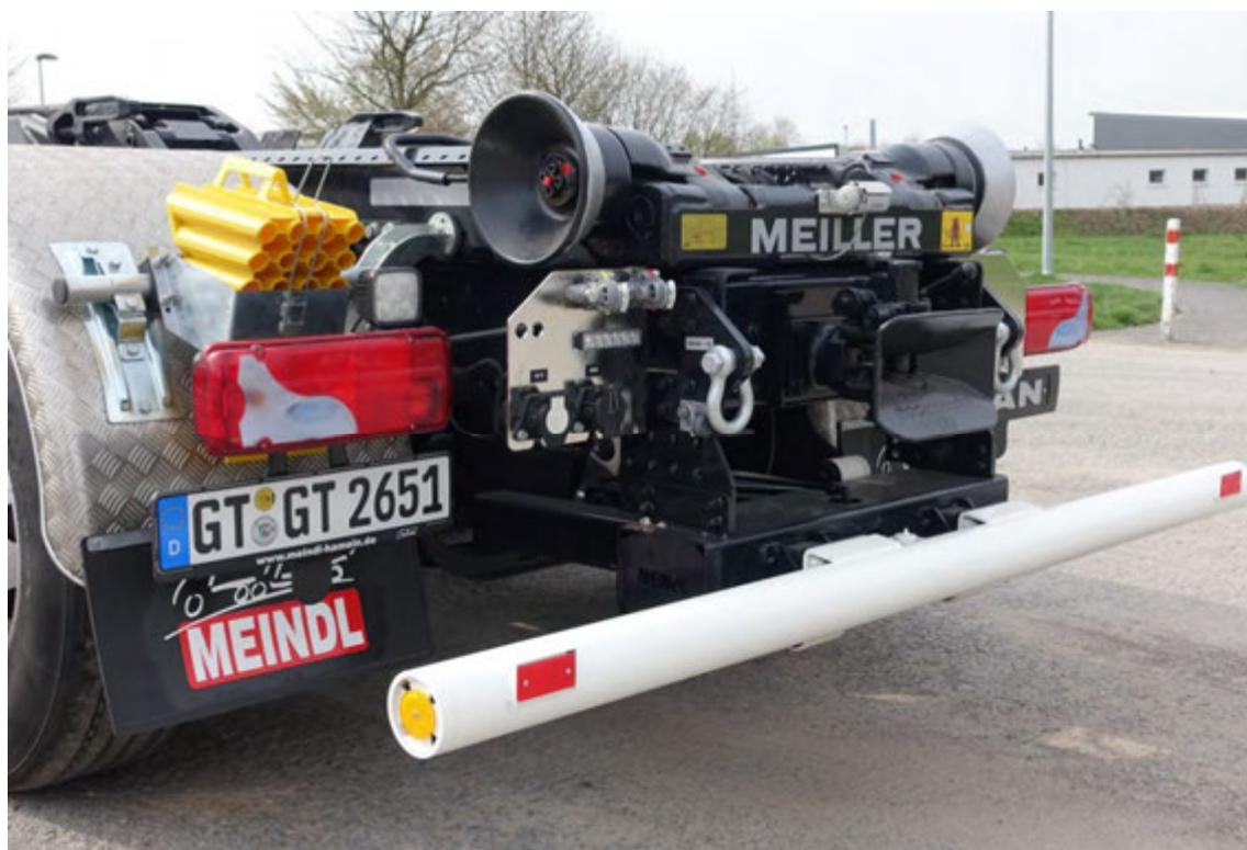
Abbildung 14: Detail – Heckansicht: Heckblitzer Hänsch Sputnik SL, integriert in MEINDL-Edelstahl-Halterungen.
