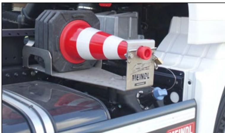
Abbildung 49: Leitkegelhalterung, flexibel am Fahrzeug positionierbar.
