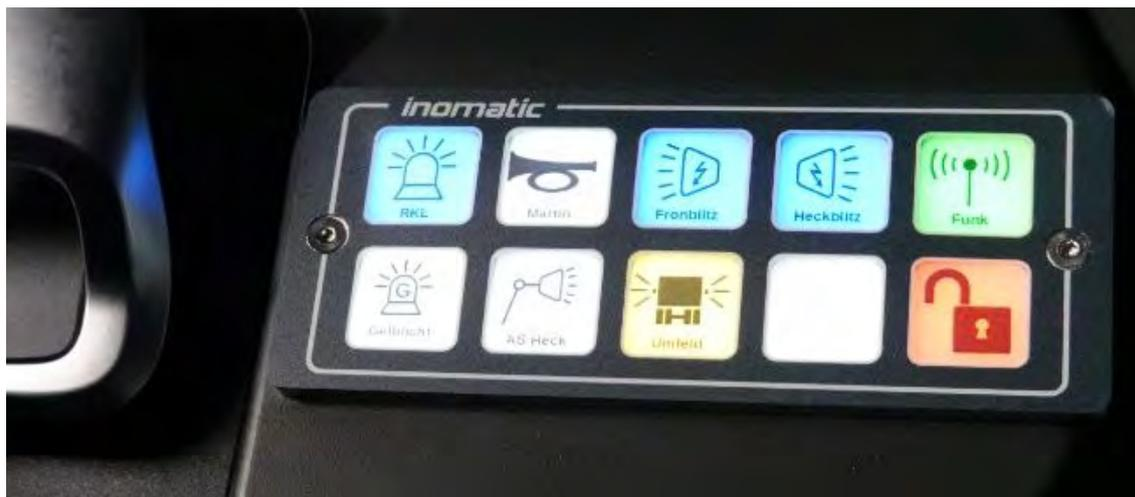
Abbildung 25: Options-Bedienteil WLF (hier im Armaturenbrett integriert montiert).
