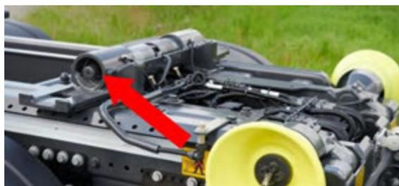
Abbildung 47: Zusätzliche hydraulische Innenverriegelung.
