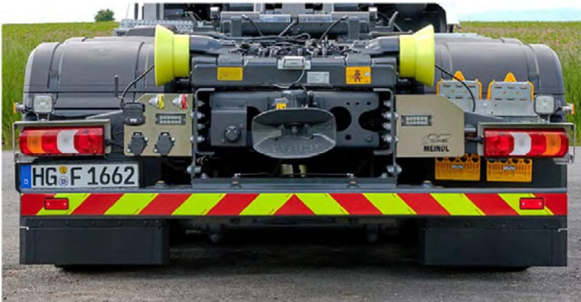
Abbildung 64: Fahrzeugmarkierung (hier Heckmarkierung gelb, schraffiert).
