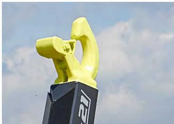
Abbildung 45: Aufnahmehaken mit Schwerlastsicherung.
