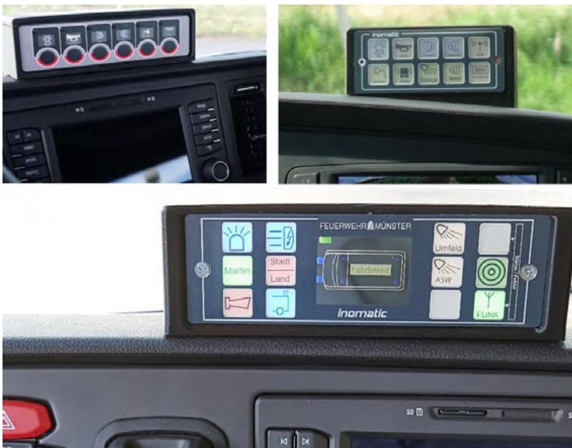
Abbildung 18: Detail – Verschiedene Bedienteile in fahrzeugspezifischen MEINDL-Halterungen auf dem Armaturenbrett aufgesetzt montiert.
