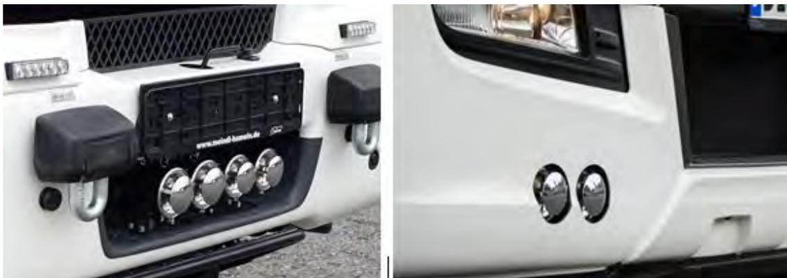
Abbildung 37: MARTIN-HORN®-Schallbecher in der Frontstoßstange integriert. Unterschiedliche Anordnungen je nach Fahrzeugtyp.
