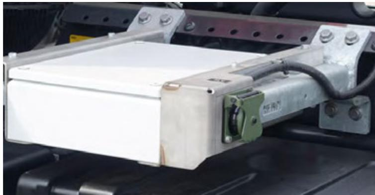
Abbildung 22: Zentralelektrik – Standard: Anordnung seitlich am Fahrgestellrahmen an verzinkten Halterungen und entsprechenden Edelstahlaufnahmen, kombiniert mit der Stromversorgung für den AB nach VG 96923-3, DIN 14505.
