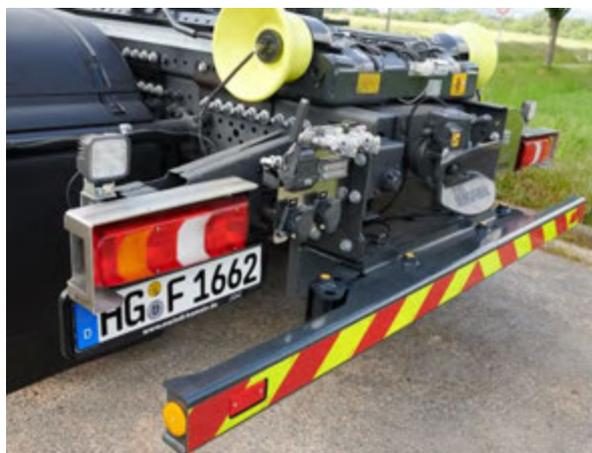
Abbildung 48: Hydraulisch verstellbarer Heck-Unterfahrschutz, hier eingefahren.
