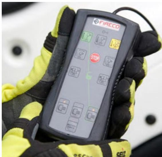
Abbildung 55: Fernbedienung für alle Lichtmastfunktionen.
