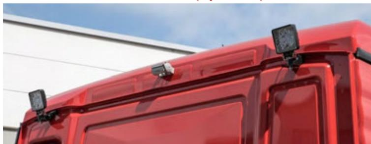
Abbildung 53: LED-Arbeitsstellenscheinwerfer hinten oben am Fahrerhaus.
