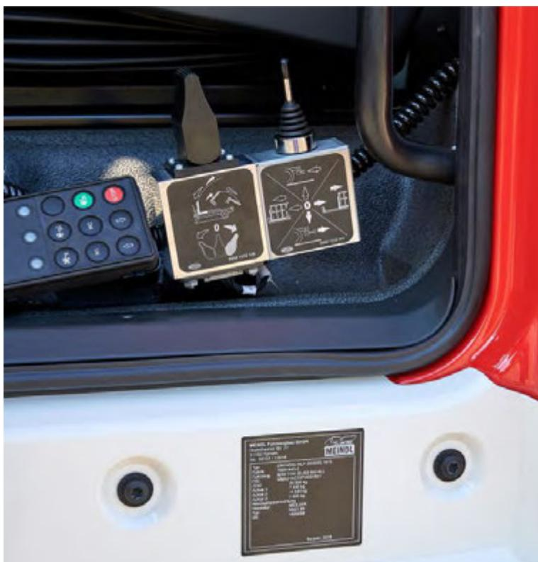
Abbildung 16: Detail – Bedienteil der Wechsellader-Anlage fest neben dem Fahrersitz eingebaut (hier MEILLER-Wechsellader-Anlage).
