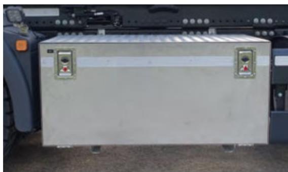
Abbildung 57: Staukasten – Edelstahl mit Klappe.
