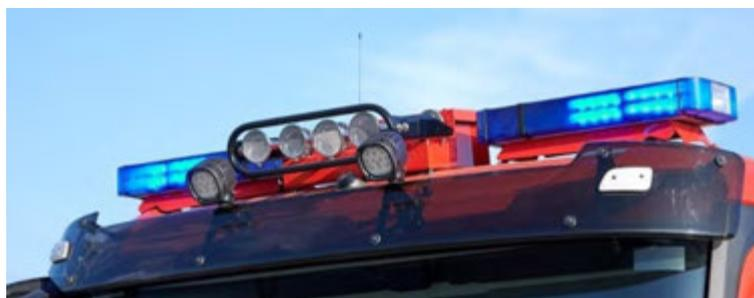
Abbildung 52: LED-Arbeitsstellenscheinwerfer vorne oben am Fahrerhaus.
