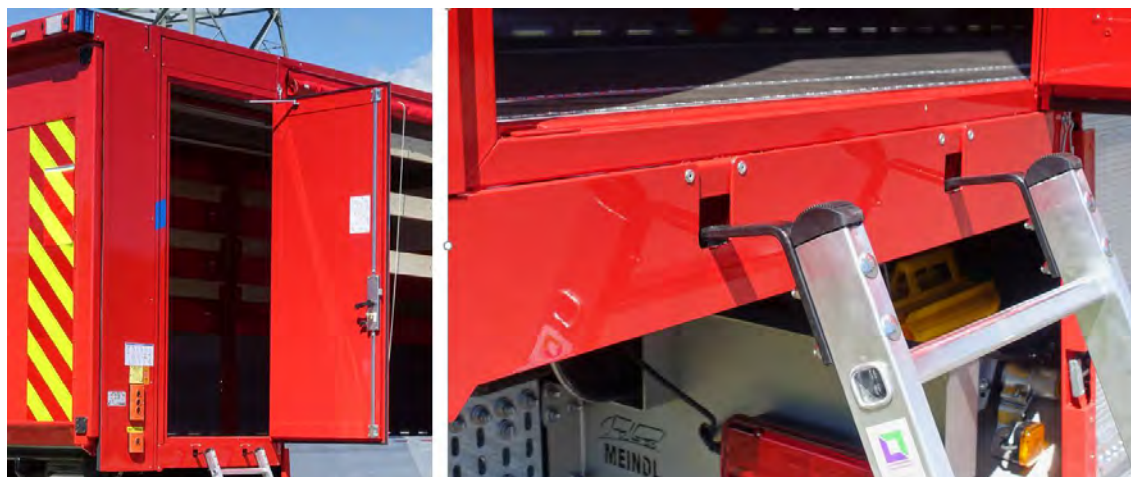
Abbildung 37: Seitentür hinten rechts, einhängbare Auftrittleiter.
