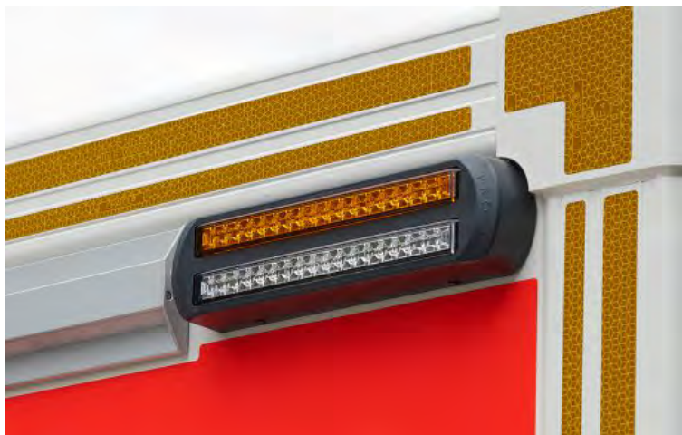
Abbildung 30: Die Positions- und Blinkleuchten sind separat schaltbar.
