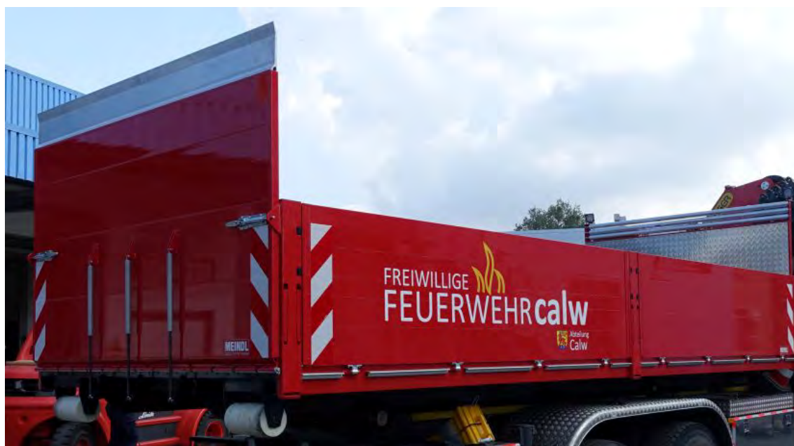
Abbildung 3: AB Transport als offener Pritschenaufbau. Hier: Heckansicht mit Gasfeder-unterstützter Auffahrrampe.
