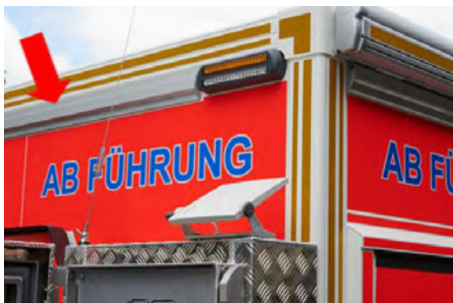
Abbildung 43: LED-Lichtstreifenelement Fabr. LDR, vorn und seitlich.
