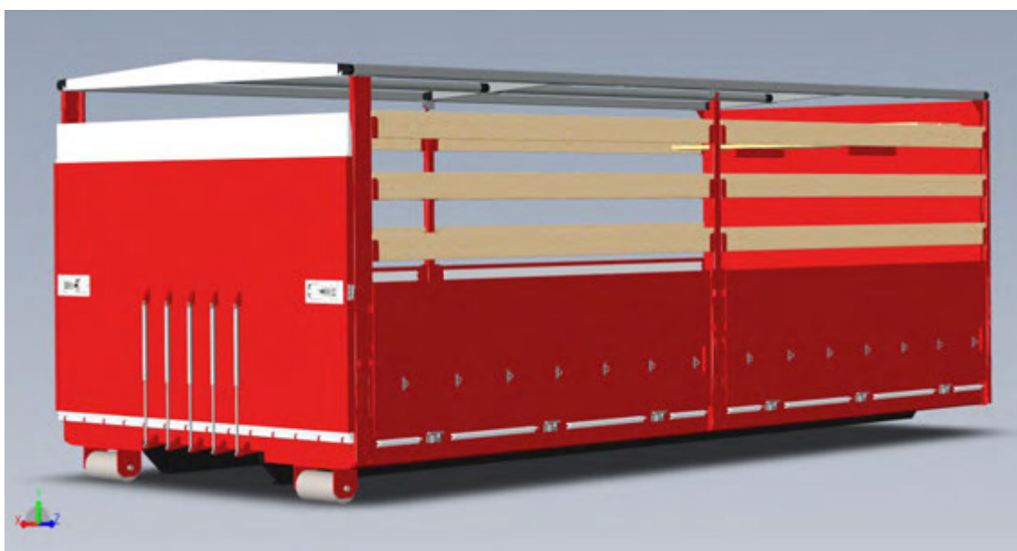
Abbildung 6: AB Transport als geschlossener Pritschenaufbau. 3D-Entwurfszeichnung.
