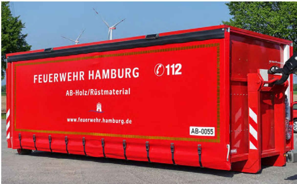
Abbildung 7: AB Transport als geschlossener Pritschenaufbau in Ausführung mit seitlicher Schiebefläche, hier ohne zusätzliche seitliche Bordwände.
