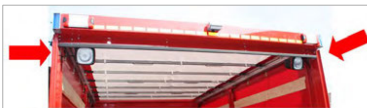
Abbildung 39: LED-Arbeitsstellenscheinwerfer im Heckportal, schwenkbar.
