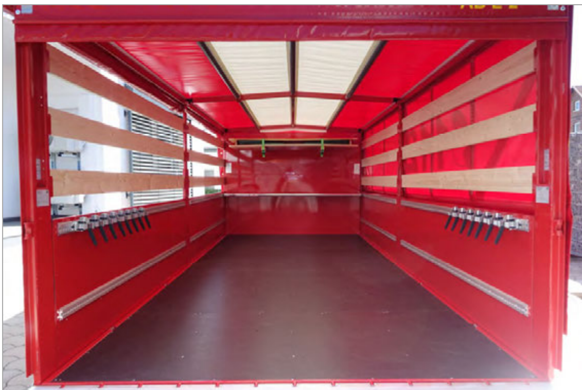
Abbildung 13: Detail – AB Transport, Innenansicht (hier mit alternativem Ladungssicherungskonzept), 2 Reihen Zurrschienen (Kombi-Schiene) an den Seitenwänden, passend auch für JF-Schnellspanner KERL JF. Ausführung des Plandaches mit Dachneigung.
