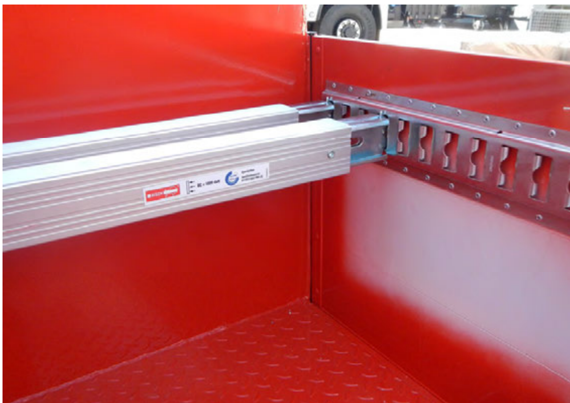
Abbildung 14: Detail – Alternative Ladungssicherung mit Sperrbalken.
