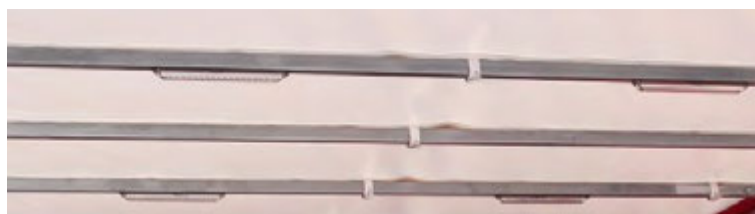
Abbildung 40: LED-Laderaumbeleuchtung (hier bei Ausführung Planendach).
