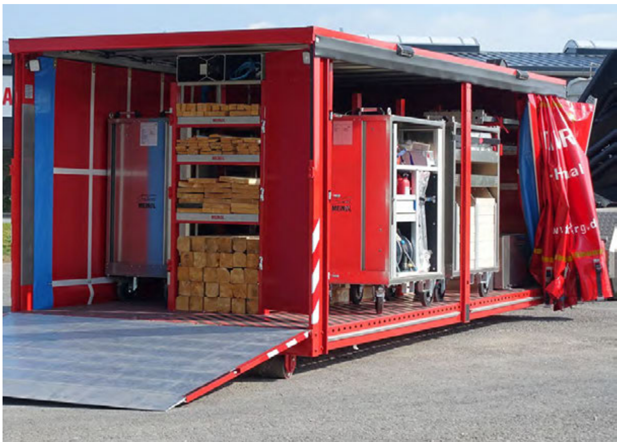
Abbildung 8: Sehr gute Zugänglichkeit durch die geöffnete Heckklappe und die seitlich geöffnete Schiebefläche.
