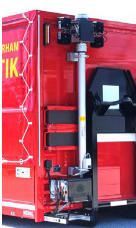
Abbildung 45: Lichtmast (hier zusätzlich mit LED-Blitzleuchte, grün). Ausführung mit Elektro-Druckluftheizer. Fernsteuerung für den Lichtmast.
