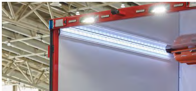
Abbildung 41: LED-Laderaumbeleuchtung (hier bei Ausführung Kofferaufbau).
