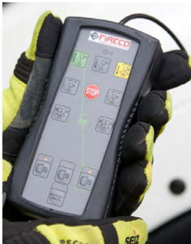
Abbildung 45: Lichtmast (hier zusätzlich mit LED-Blitzleuchte, grün). Ausführung mit Elektro-Druckluftheizer. Fernsteuerung für den Lichtmast.
