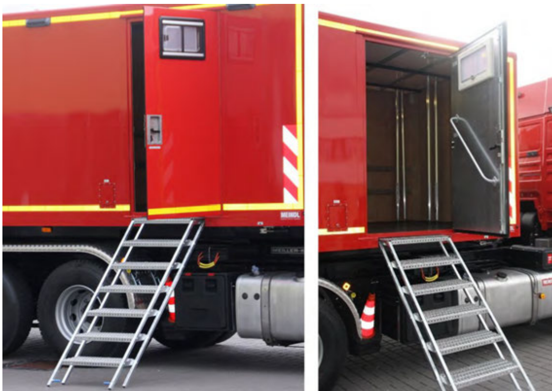
Abbildung 38: Seitentür vorne rechts, Schiebetreppe mit Podest und Handlauf in der Tür.
