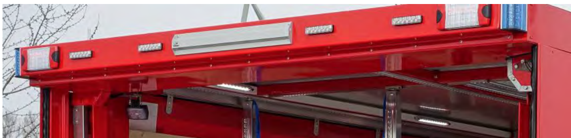
Abbildung 44: LED-Lichtstreifenelement Fabr. LDR, hinten.
