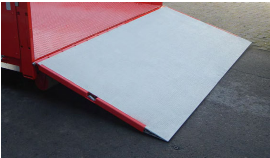
Abbildung 12: Detail – Auffahrrampe Rutschfestigkeitsklasse >R11.
