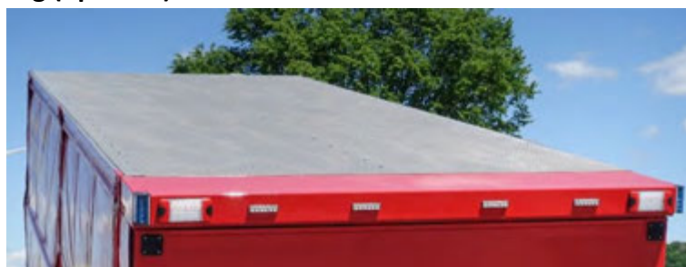
Abbildung 24: Festes Aluminiumdach in Alu-Gerstenkorn.
