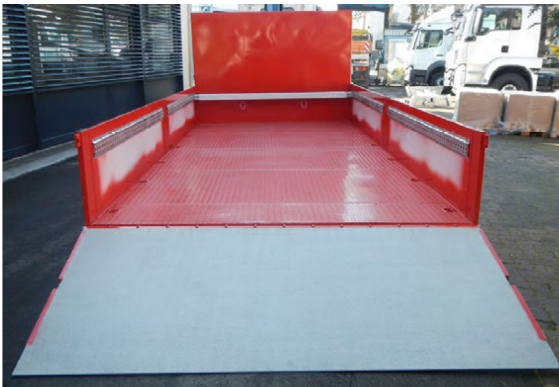
Abbildung 11: Detail – Auffahrrampe abgeklappt, Ladeflächenboden in Stahl-Warzenblech.
