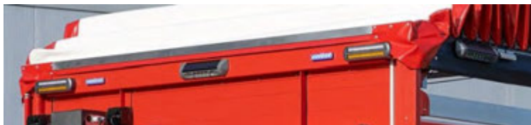
Abbildung 31: Frontblitzer, hier bei Planenausführung mit Schiebedachanlage.
