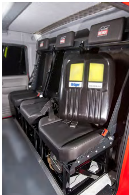
Abbildung 4: Detail – MEINDL-Sitze für Kreislaufatemgerät mit Dreipunktgurt.
