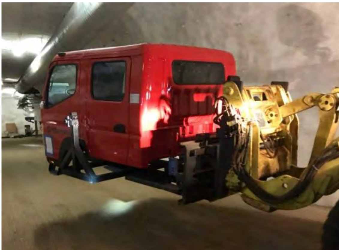
Abbildung 7: Transport des Segmentes „Fahrerhaus“ unter Tage.
