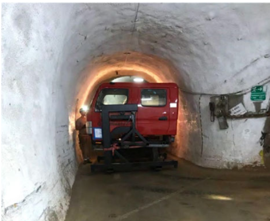
Abbildung 6: Transport des Segmentes „Fahrerhaus“ unter Tage.
