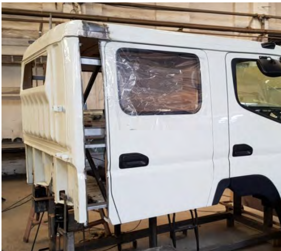
Abbildung 3: Detail – Verlängerung des Fahrerhauses, erforderlich zur Montage von 5 Stück MEINDL-Sitzen mit Dreipunktgurt und Lagermöglichkeit für Kreislaufatemgeräte.
