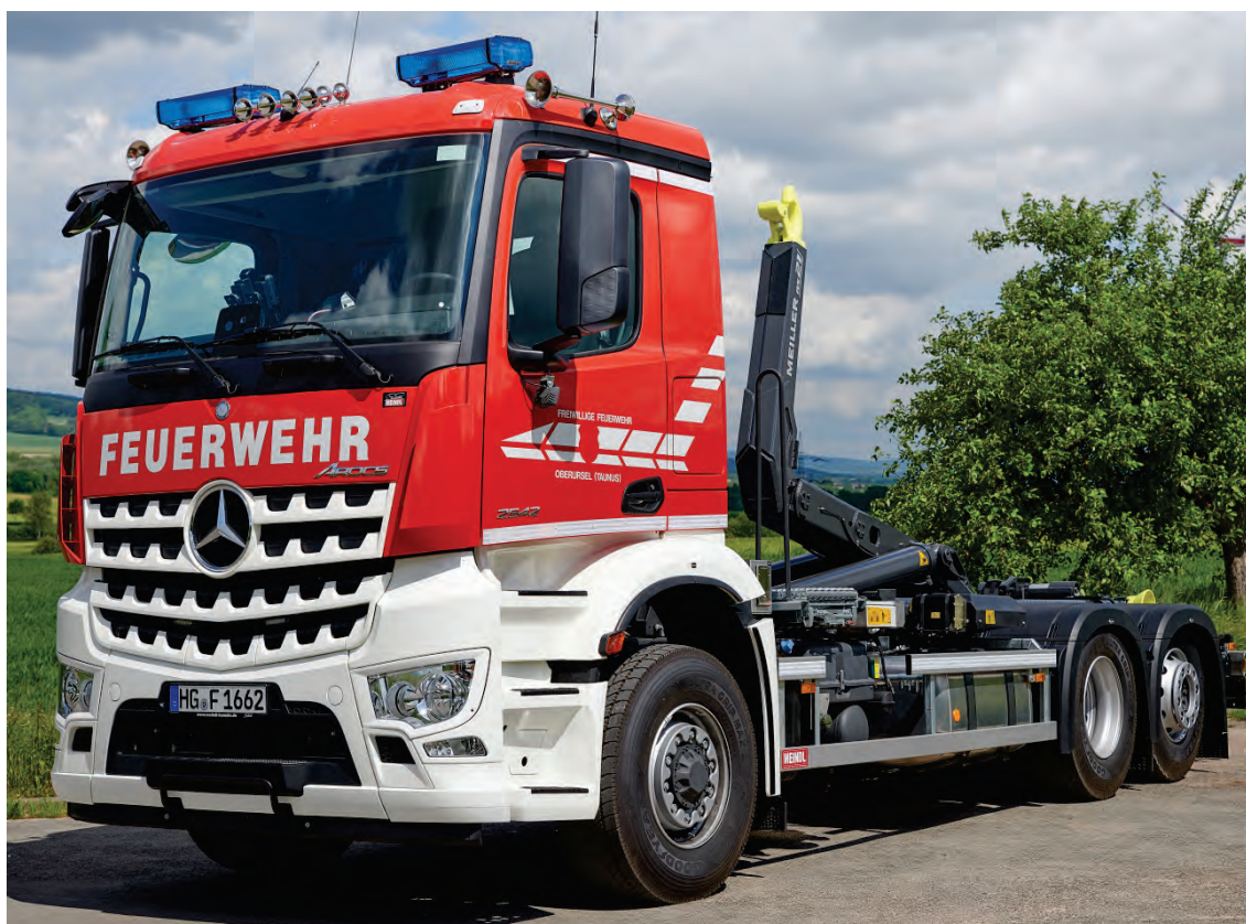
Abbildung 10: WLF 26/6900 auf Mercedes-Benz Arocs-Fahrgestell mit HAD (1. Achse hydraulisch angetrieben).
