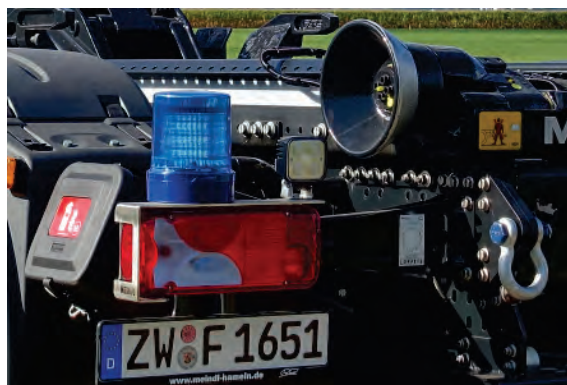
Abbildung 65: Heck-Rundumkennleuchte auf MEINDL-Edelstahlhalterung.
