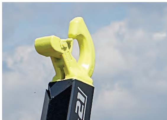
Abbildung 75: Aufnahmehaken mit Schwerlastsicherung.
