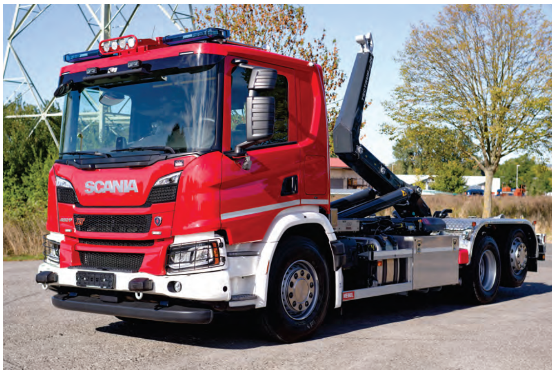
Abbildung 11: WLF 26/6900 auf SCANIA-XT-Fahrgestell, geteilter Dachwarnbalken und Kompressor der MARTIN-HORN®-Anlage im Dachkasten.
