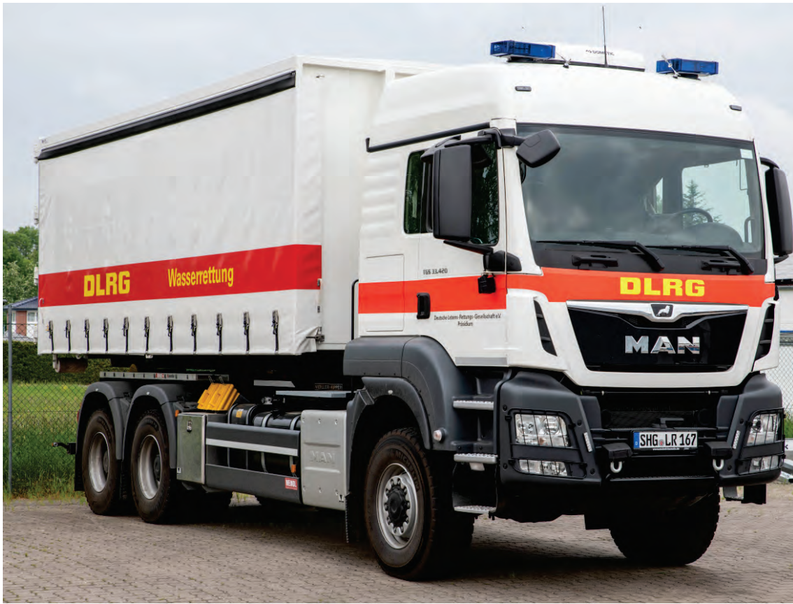
Abbildung 5: WLF 26/6900 auf MAN TGS 6x6-Fahrgestell (DLRG).
