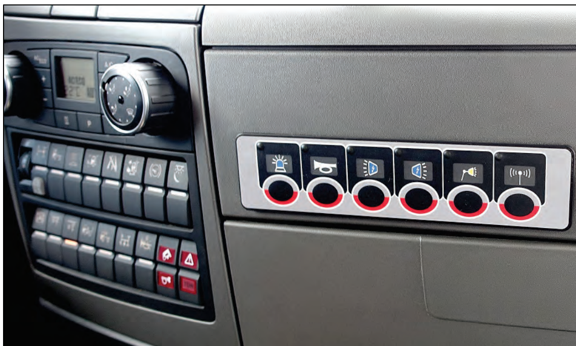
Abbildung 47: Detail – WLF Standard-Bedienteil für MEINDL CAN-BUS-System in der Armaturentafel integriert.
