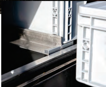
Abbildung 40: Detail – Oben: Warnleuchten an der Klappe und LED-Innenbeleuchtung automatisch beim Öffnen der Klappe geschaltet. Rechts: Lagerung der Euroboxen in Aluminium-Schienen.
