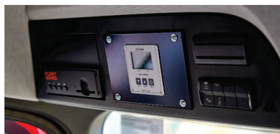
Abbildung 91: Ladezustandsanzeige, hier im Fahrerhaus oberhalb der Windschutzscheibe integriert.
