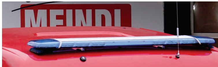
Abbildung 60: Warnbalken Hänsch DBS 5000 LED in besonders niedriger Bauhöhe.
