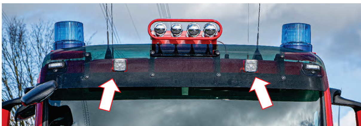
Abbildung 33: Detail – Front-Zusatzscheinwerfer auf dem Dach, nachträglich in die Sonnenblende des Fahrzeugs integriert.
