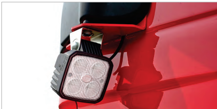
Abbildung 81: LED-Manövrierscheinwerfer an den Außenspiegelhalterungen.
