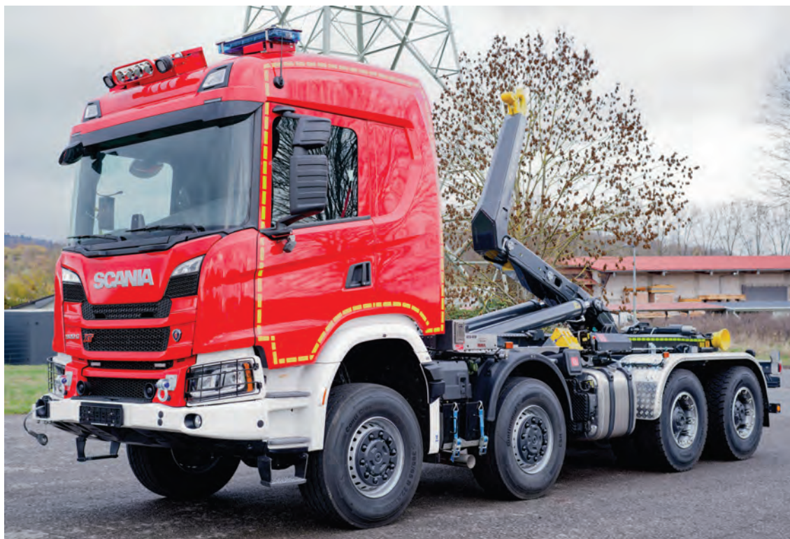
Abbildung 19: WLF 32/6900 auf SCANIA-XT-Fahrgestell mit Allradantrieb, hier in niedriger Ausführung ohne Hilfsrahmen ausgeführt (möglich durch eine spezielle Anordnung und Sonderausführung der Wechselladeranlage). Maschinelle Zugeinrichtung ROTZLER TREIBMATIC TR 030 ( \geq 50 kN Nennzugkraft).
