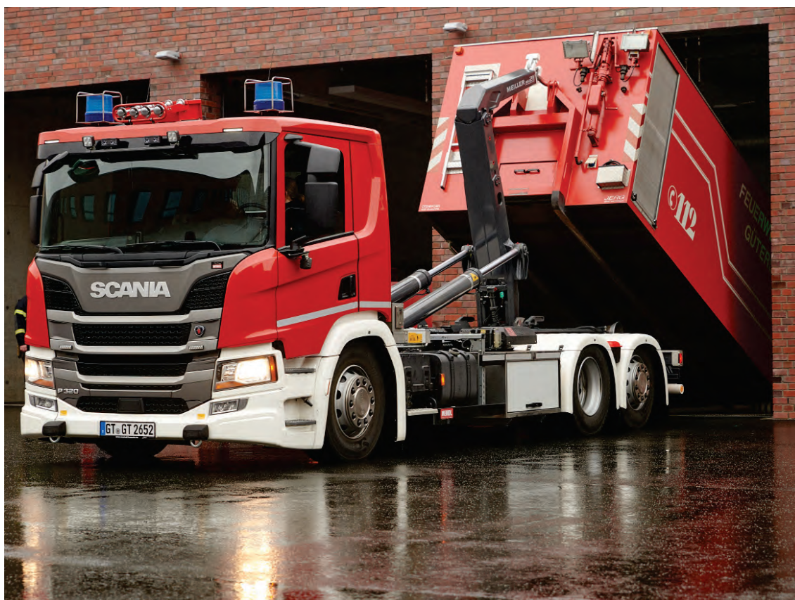
Abbildung 14: WLF 26/6900 auf SCANIA-Fahrgestell.
