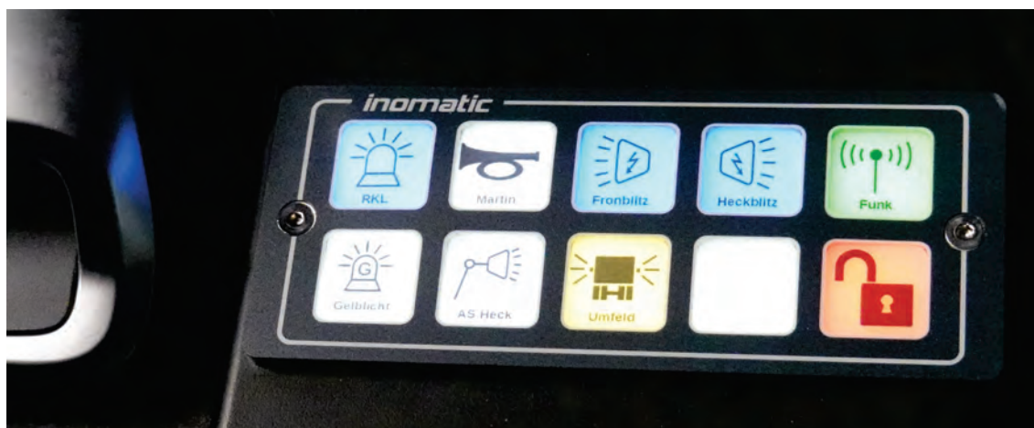
Abbildung 55: Options-Bedienteil WLF (hier im Armaturenbrett integriert montiert).
