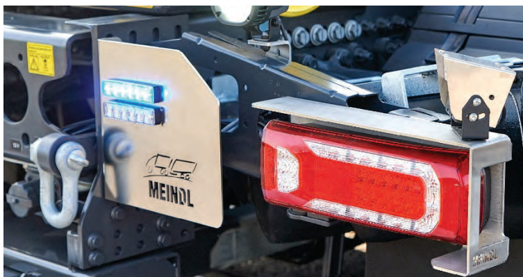
Abbildung 64: Heckblitzer Hänsch Sputnik SL (hier je einmal gelb und blau).
