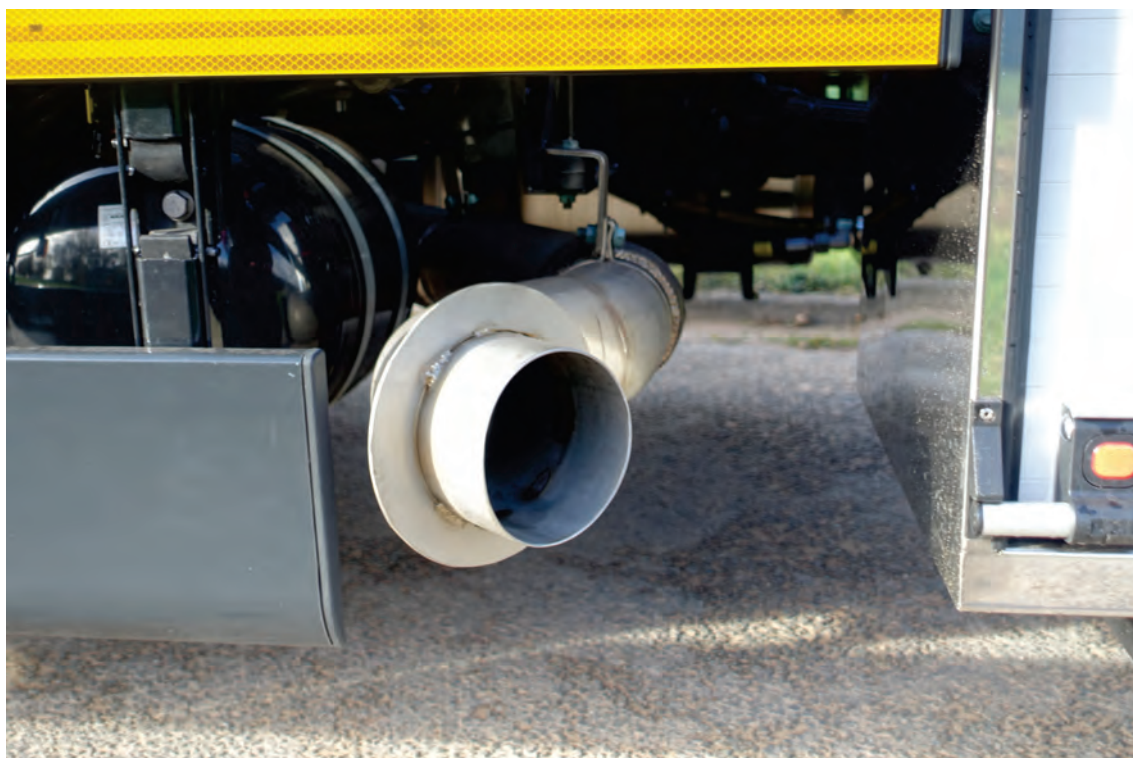
Abbildung 44: Detail – Abgasführung in Edelstahlausführung auf der linken Fahrzeugseite in Richtung Hinterrad verlegt. Ausführung für den Anschluss an eine Abgas-Absauganlage (diese Lösung ist nicht bei allen Fahrzeugtypen verfügbar).
