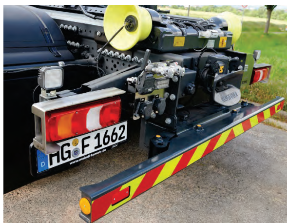
Abbildung 78: Hydraulisch verstellbarer Heck-Unterfahrschutz, hier eingefahren.
