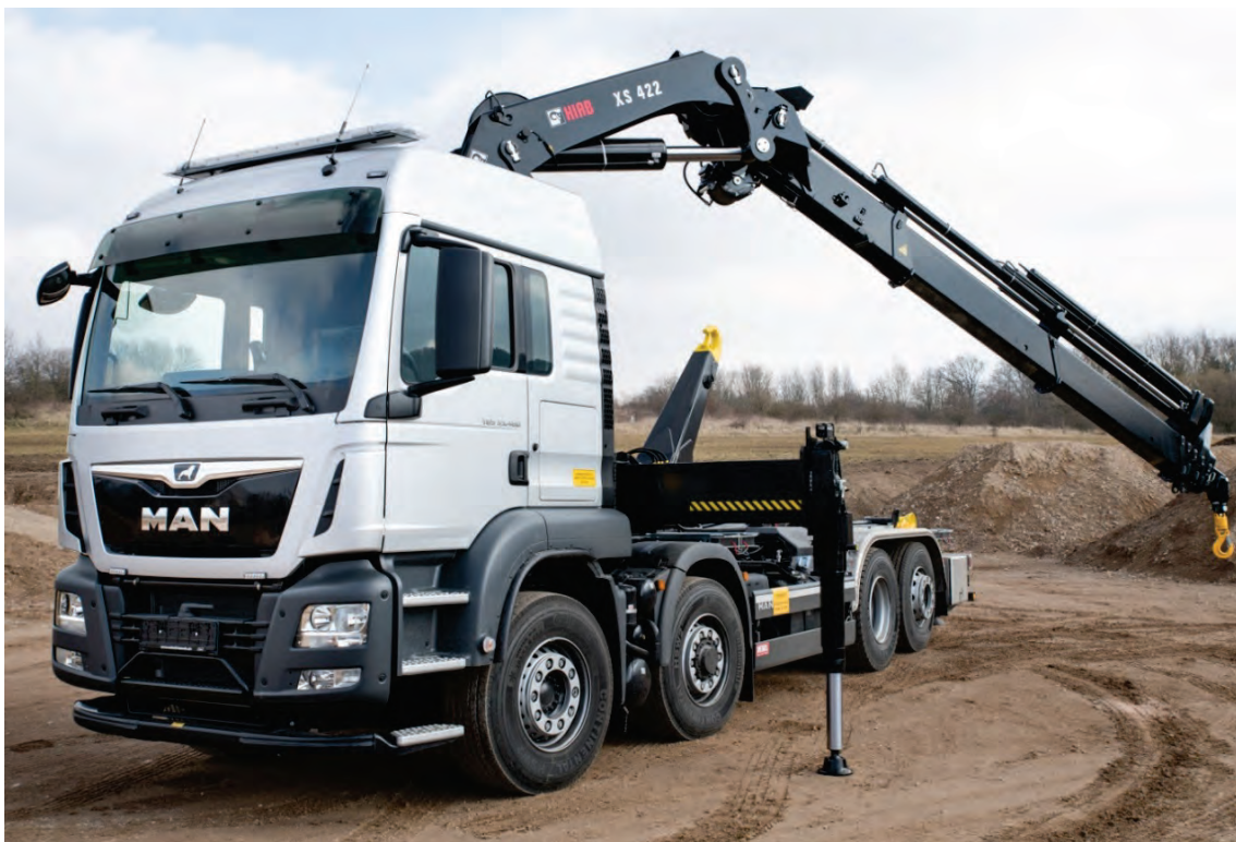
Abbildung 6: WLF 32/6900 auf MAN TGS 8x4H-6-Fahrgestell (2. Achse hydraulisch angetrieben, 1., 2. und 4. Achse gelenkt), 42 tm Ladekran, Wechsellader-Anlage in Schiebe-Knick-Ausführung zur niedrigen Behälteraufnahme in Tiefgaragen (Polizei).
