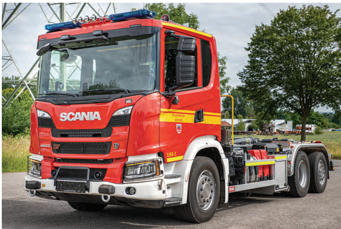
Abbildung 16: WLF 26/6900 auf SCANIA-XT-Fahrgestell, WLF-Ausstattung passend für Hytrans® Fire System-Behälter.
