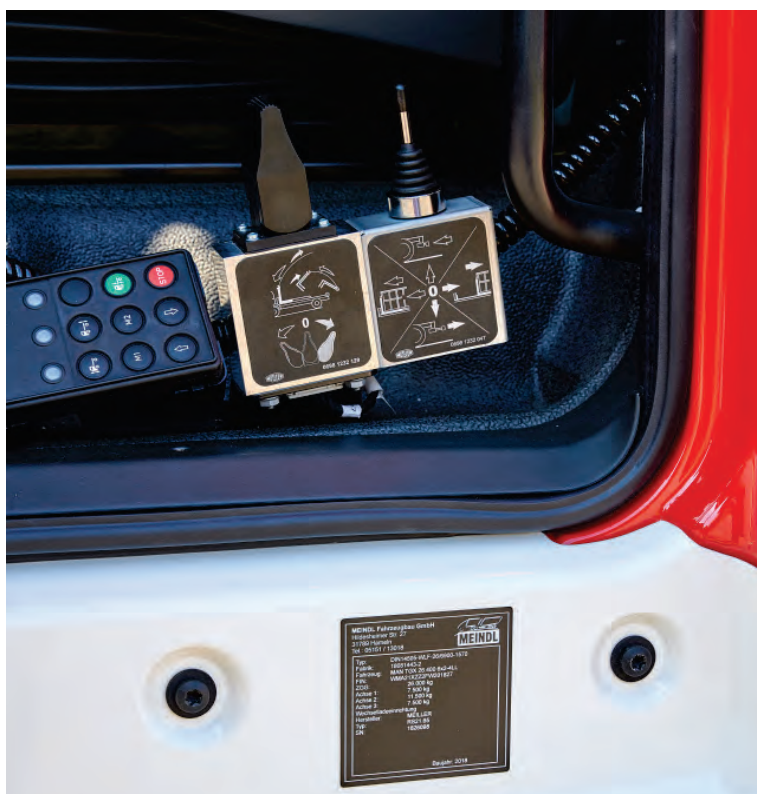
Abbildung 22: Detail – Bedienteil der Wechsellader-Anlage fest neben dem Fahrersitz eingebaut (hier MEILLER-Wechsellader-Anlage).
