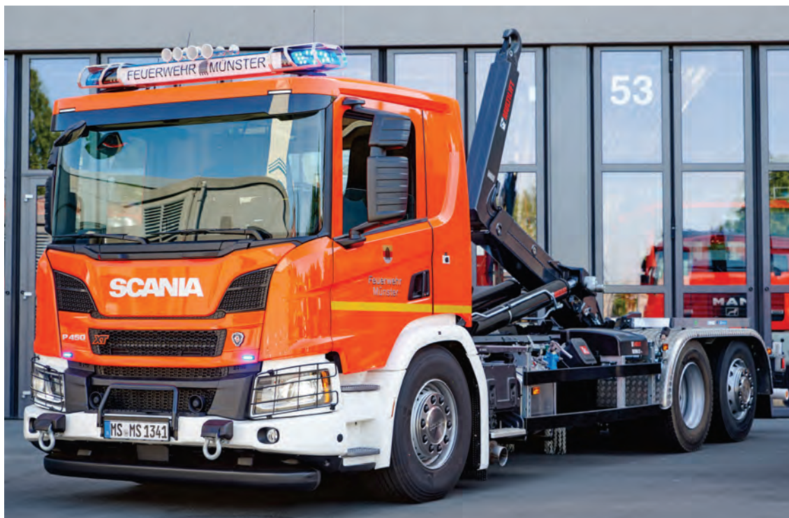
Abbildung 13: WLF 26/6900 auf SCANIA-XT-Fahrgestell, Dachwarnbalken mit MEINDL-Edelstahl-Astschutz.
