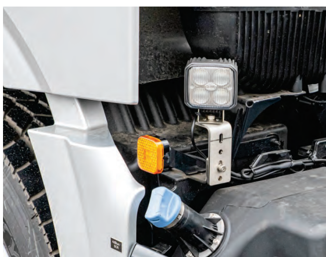
Abbildung 34: Detail – Links: Manövrierscheinwerfer hinten oben an der Tür montiert (bei einigen Fahrzeugen sind an den Spiegelsokeln Abbiegesensoren verbaut, wodurch die Montageposition an den Spiegelhalterungen nicht möglich ist). Rechts: Manövrierscheinwerfer hinter dem Fahrerhaus unten angeordnet.
