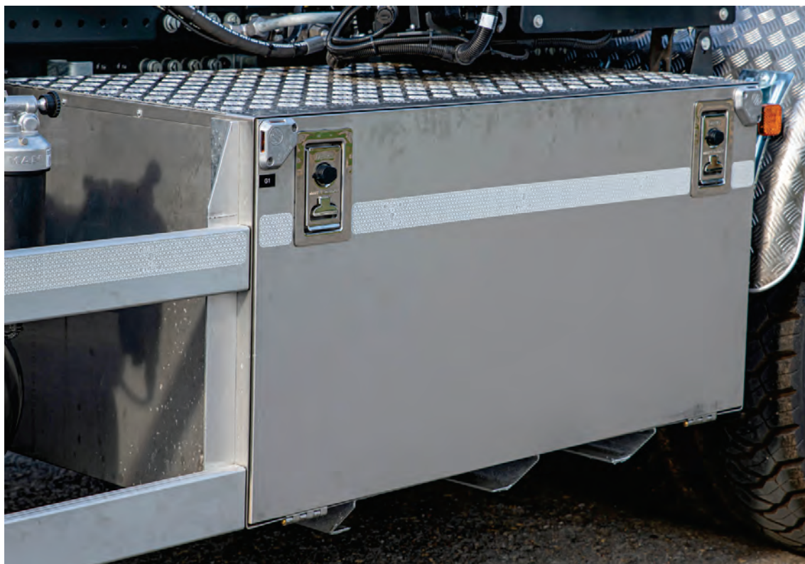
Abbildung 39: Detail – Edelstahl-Staukasten mit Klappe, untergreifende stabile Befestigung (Tragfähigkeit 250 kg).
