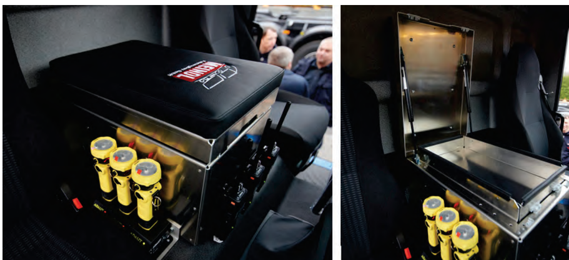
Abbildung 56: Konsolenkasten für Zentralelektrik (hier Alu natur), Oberdeckel in Kunstleder bezogen und gepolstert.
