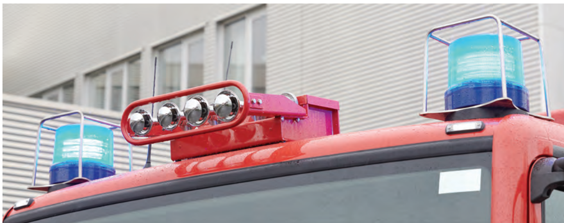
Abbildung 66: MARTIN-HORN® 2298 GM-Anlage auf dem Fahrzeugdach montiert. Kompressor im MEINDL-Dachkasten integriert.
