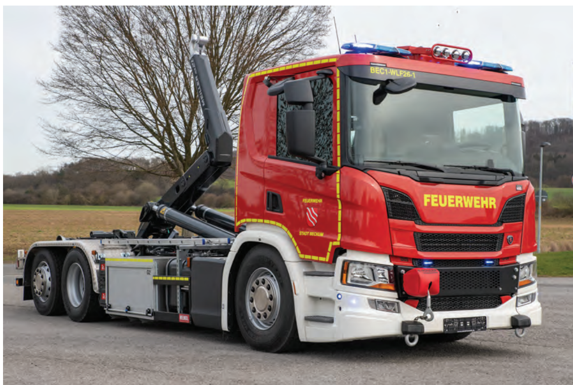
Abbildung 12: WLF 26/6900 auf SCANIA-Fahrgestell mit maschineller Zugeinrichtung Typ ROTZLER TREIBMATIC TR 030 ( \geq 50 kN Nennzugkraft). Spezielle MEINDL-Anordnung der Seil-Speichertrommel, sodass noch die Montage eines Staukastens möglich ist.
