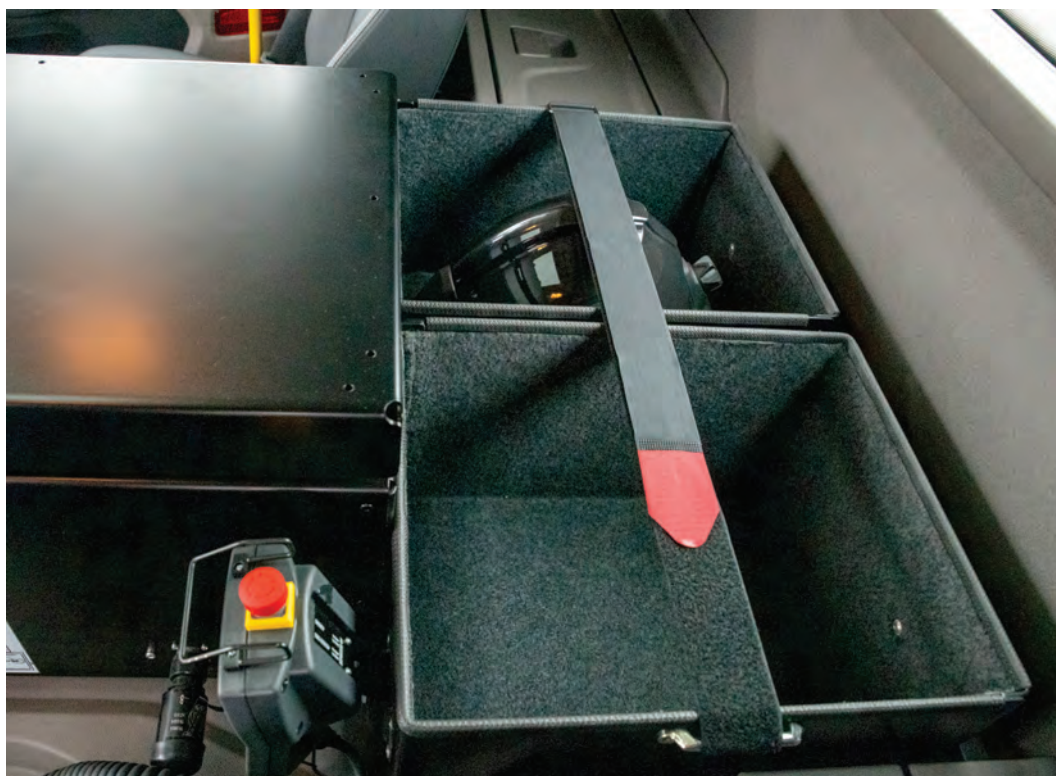
Abbildung 36: Detail – Helmhalterungen in Form von universellen Ablageschalen.
