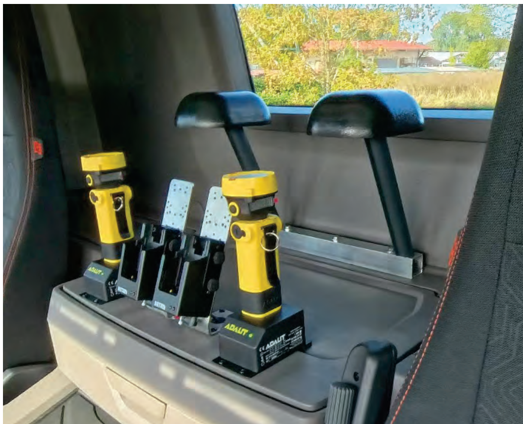
Abbildung 35: Detail – Helmhalter, Adalit-Ladeschalen und Ladeschalen für HRT.
