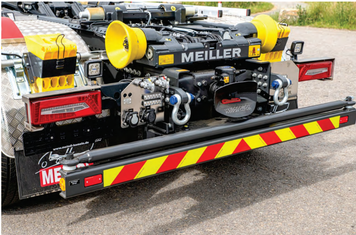
Abbildung 46: Detail – Heckansicht: Heckblitzer Hänisch Sputnik SL und Heckwarnanlage, integriert in MEINDL-Edelstahl-Halterungen. Heckunterfahrerschutz mit gelb-rot schraffierter Heckmarkierung, Aufnahmen für Abschleppstange.
