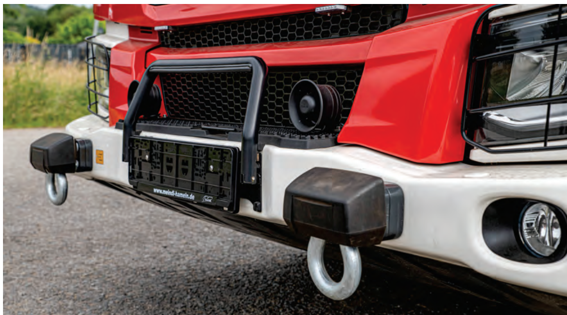
Abbildung 27: Detail – Fahrzeugfront mit integrierter elektronischer Tonfolgeanlage.
