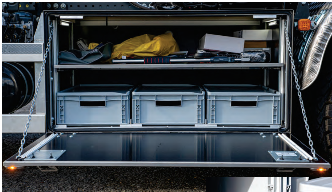
Abbildung 40: Detail – Oben: Warnleuchten an der Klappe und LED-Innenbeleuchtung automatisch beim Öffnen der Klappe geschaltet. Rechts: Lagerung der Euroboxen in Aluminium-Schienen.
