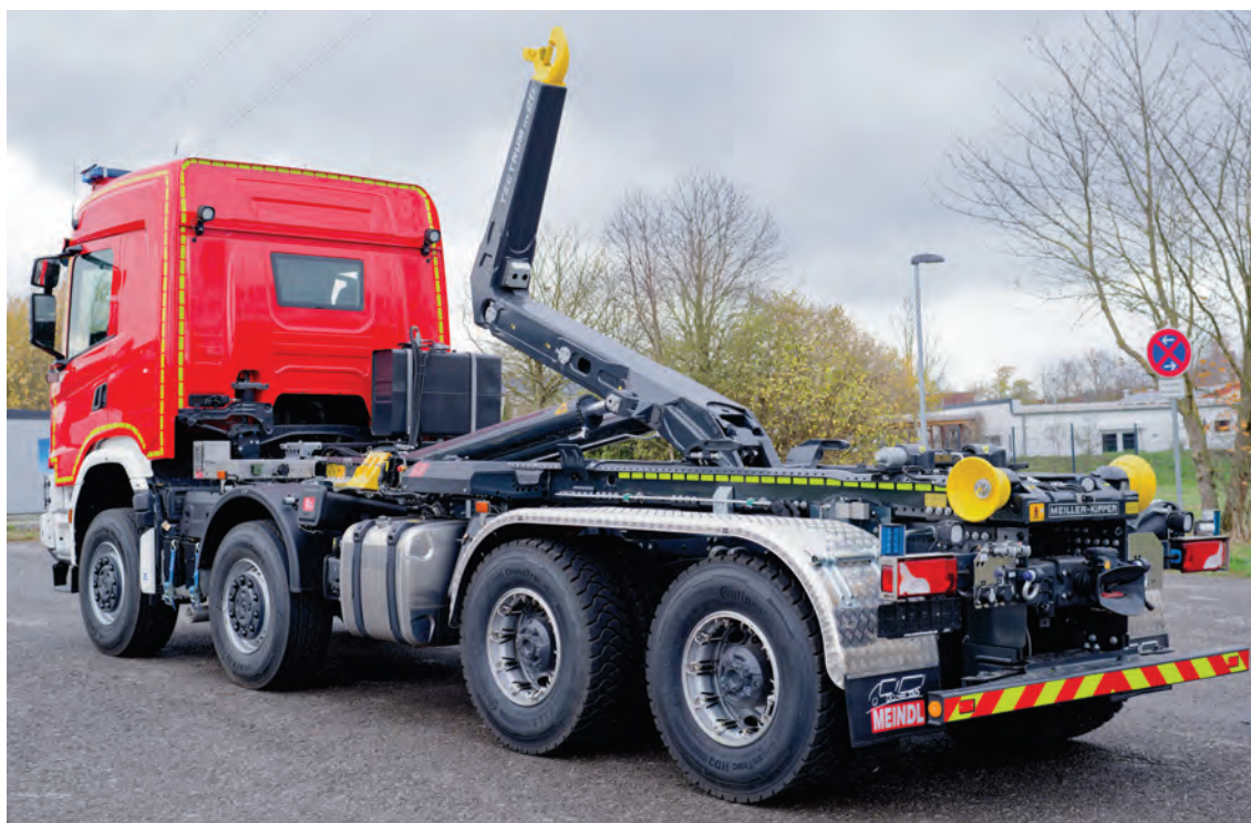
Abbildung 20: WLF 32/6900 auf SCANIA-XT-Fahrgestell mit Allradantrieb, Heckansicht, hier aus Platzgründen mit stehendem Hydrauliköltank hinter dem Fahrerhaus.
