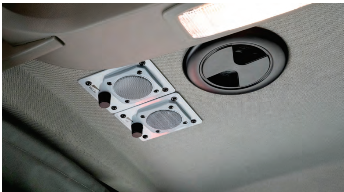
Abbildung 31: Detail – 2 Stück regelbare Zusatzfunklautsprecher in der Fahrzeugdachverkleidung eingelassen. Daneben Revisionsöffnung für die Funkantenne. Auf Wunsch kann bei einigen Fahrzeugtypen auf eine separate Revisionsöffnung verzichtet werden – so können vorhandene Deckenleuchten mit direkt darüber montierten Antennen als Revisionsöffnungen verwendet werden.
