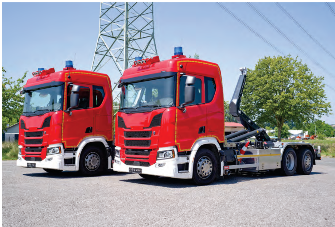
Abbildung 15: WLF 26/6900 auf SCANIA-Fahrgestellen mit langen Fahrerhäusern in Fahrschulausstattung (3 Sitzplätze sind mit Pedalen ausgestattet).
