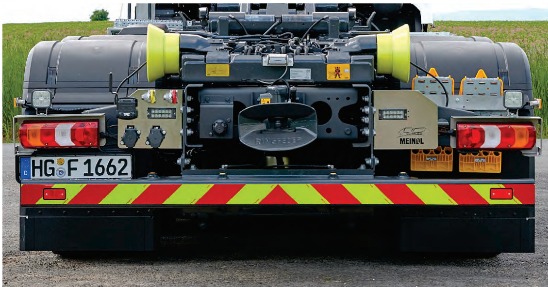
Abbildung 97: Fahrzeugmarkierung (hier Heckmarkierung gelb, schraffiert).
