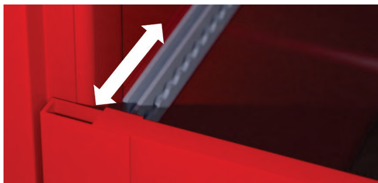
Abbildung 20: Bündige Stirnwand – ohne in die Ladefläche hineinragende Stirnrungen für optimale Be- und Entladung z.B. mit einem Gabelstapler.
