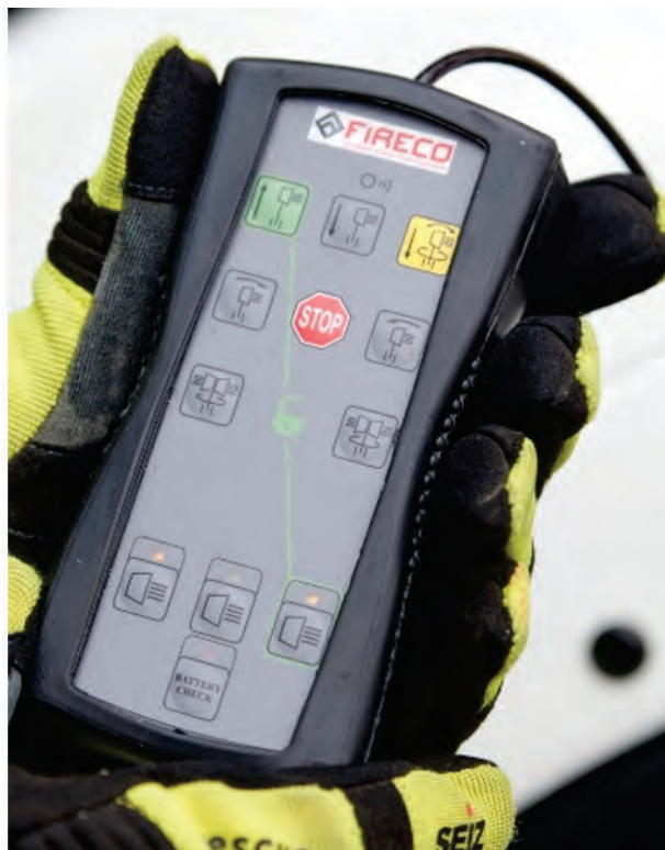
Abbildung 46: Lichtmast (hier zusätzlich mit LED-Blitzleuchte, grün). Ausführung mit Elektro-Druckluftheizer. Fernsteuerung für den Lichtmast.
