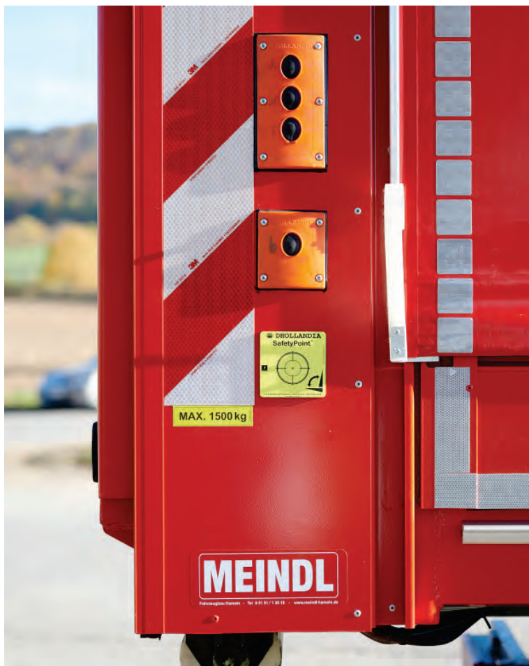
Abbildung 16: Detail – Hand-Bedienung des Vertikallifts hinten im Heckportal (Serie).
