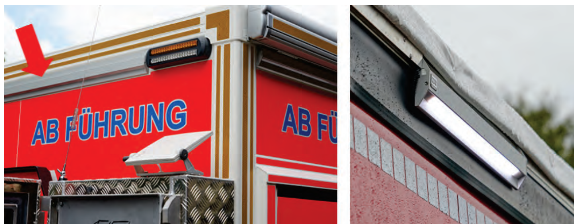
Abbildung 44: LED-Lichtstreifenelement Fabr. LDR, vorn und seitlich.
