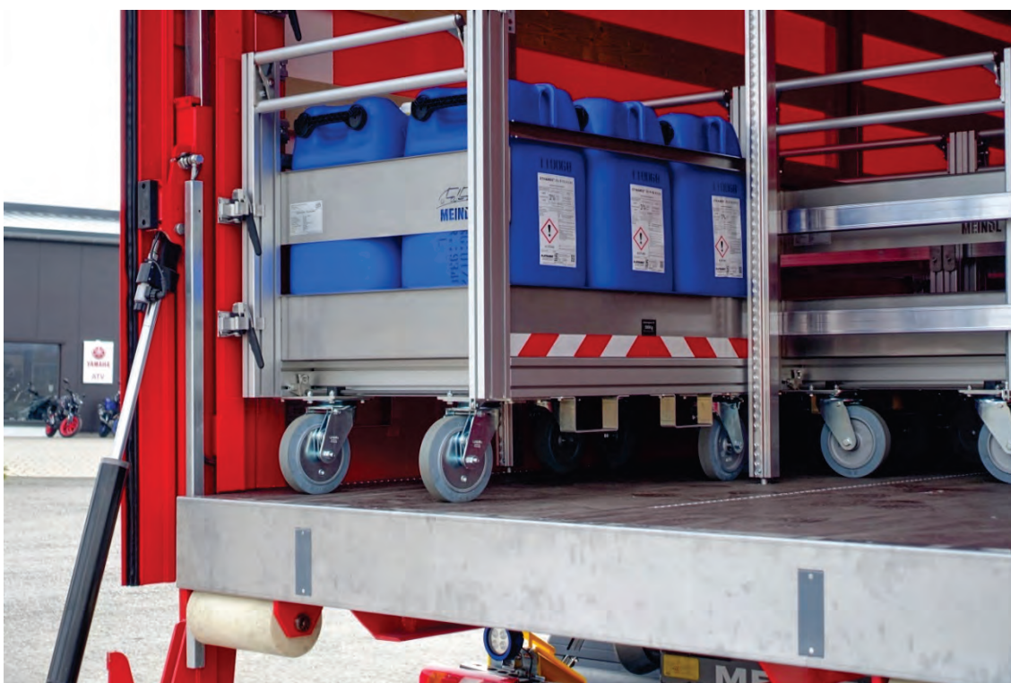
Abbildung 12: Detail – Glatter Edelstahl-Bodenabschluss, Heckportal, Kunststoff-Ablaufrollen.
