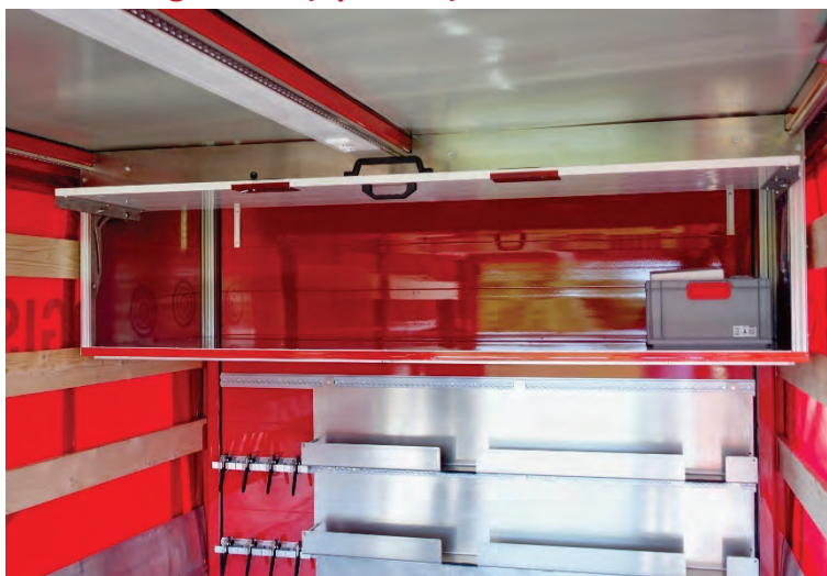
Abbildung 49: Stirnwandeinbauten: Regal und Aufnahme für Bierzeltgarnitur.
