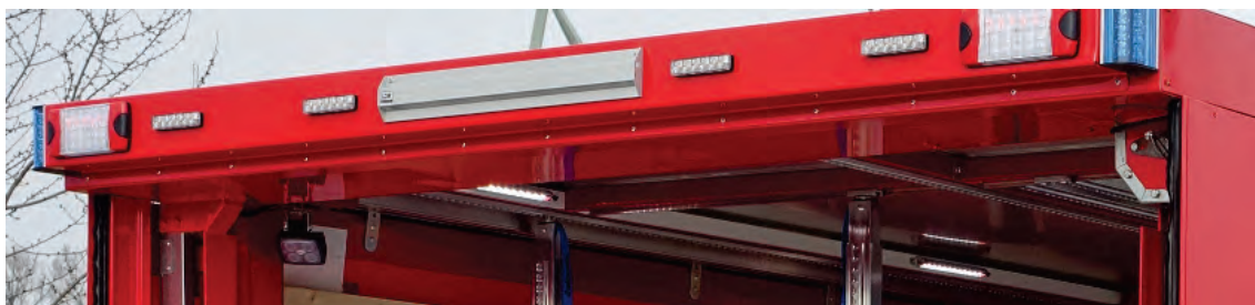
Abbildung 45: LED-Lichtstreifenelement Fabr. LDR, hinten.
