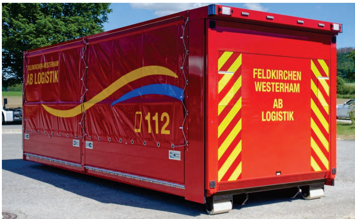
Abbildung 8: Durch seitliche Rollplane bedingt (anders als bei Schiebepanelen) kein glattes Erscheinungsbild der Plane.
