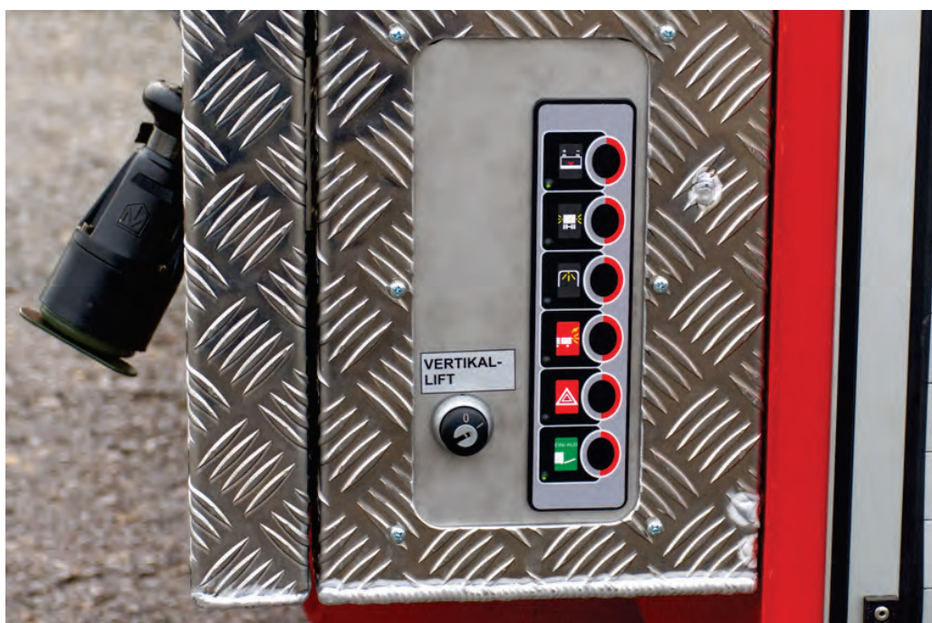
Abbildung 15: Detail – CAN-BUS gesteuerte Zentralelektrik, Standard-Bedienteil mit Notbedienfunktion bei Unterspannungsauslösung für den Vertikallift, Steuerung für Beleuchtung und ggf. zusätzliche Verbraucher.
