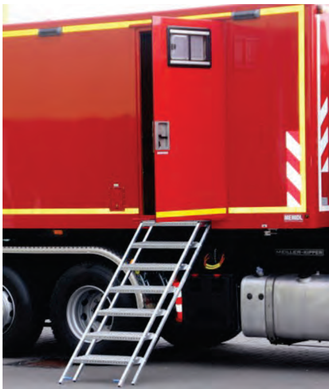
Abbildung 39: Seitentür vorne rechts, Schiebetreppe mit Podest und Handlauf in der Tür.
