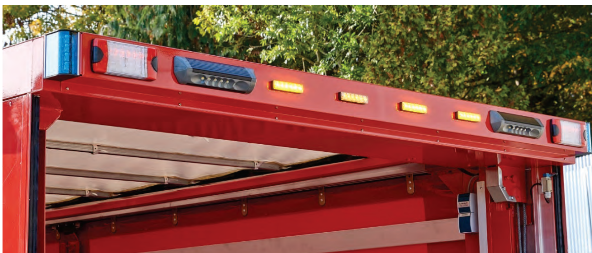
Abbildung 33: Heckleuchtenkonsole (hier mit voller Bestückung, jedoch ohne Rückfahrkamera).
