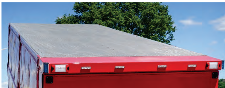
Abbildung 24: Festes Aluminiumdach in Alu-Gerstenkorn.
