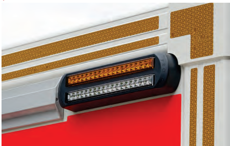
Abbildung 31: Die Positions- und Blinkleuchten sind separat schaltbar.
