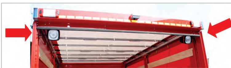
Abbildung 40: LED-Arbeitsstellenscheinwerfer im Heckportal, schwenkbar.
