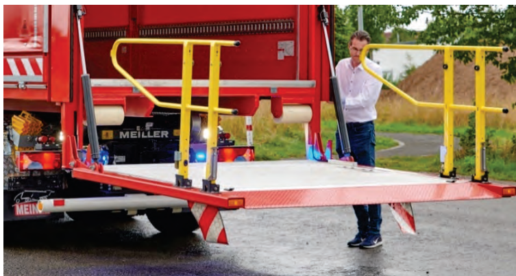
Abbildung 47: Absturzsicherung am Vertikallift, klappbar.
