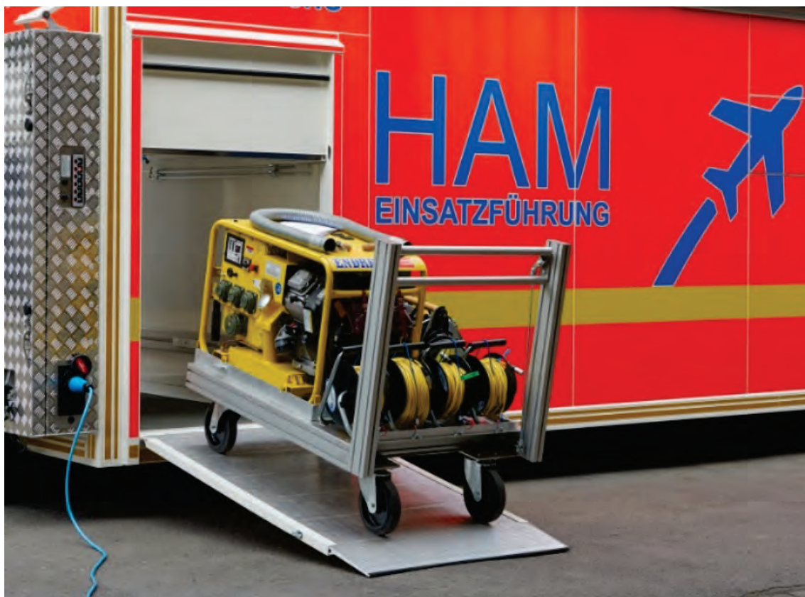
Abbildung 12: Detail – Laderampe des vorderen Geräteraumes, MEINDL-Rollcontainer.
