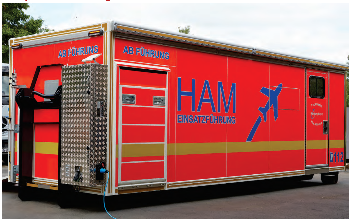
Abbildung 7: AB Führung mit vorderen abgetrennten Geräteraum mit Rollladen, Kunststoff-Sandwichbauweise. LED-Umfeldbeleuchtung über die gesamte Aufbauhöhe sowie vorne und hinten über die gesamte Breite. Seitlich aufgesetzte Markise über die gesamte Außenlänge (die Grundbreite des Behälters muss dafür geringer sein, dadurch Verringerung der lichten Breite innen).
