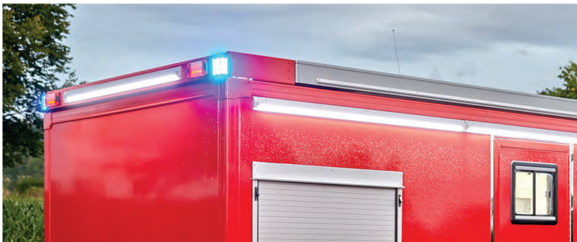
Abbildung 31: Heckleuchtenkonsole (hier in der Dachgalerie integriert), mit Umfeldbeleuchtung über die volle Breite.
