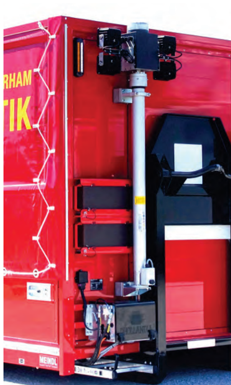
Abbildung 43: Lichtmast (hier zusätzlich mit LED-Blitzleuchte, grün). Ausführung mit Elektro-Druckluftherzeuger. Fernsteuerung für den Lichtmast.
