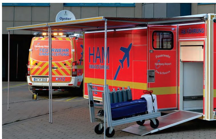
Abbildung 58: Seitlich montierte Markise mit Abstützung.
