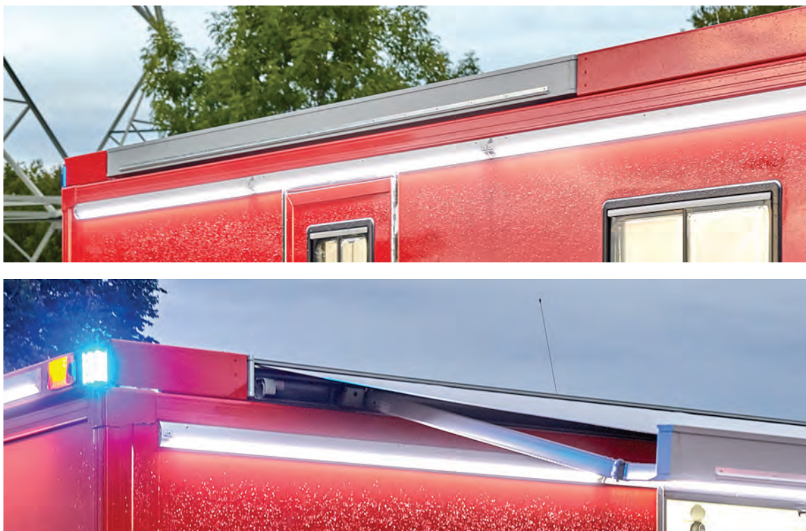
Abbildung 59: Freitragende 230-Volt-Haustechnik-Markise, auf dem Dach in der Dachgalerie bündig integriert.
