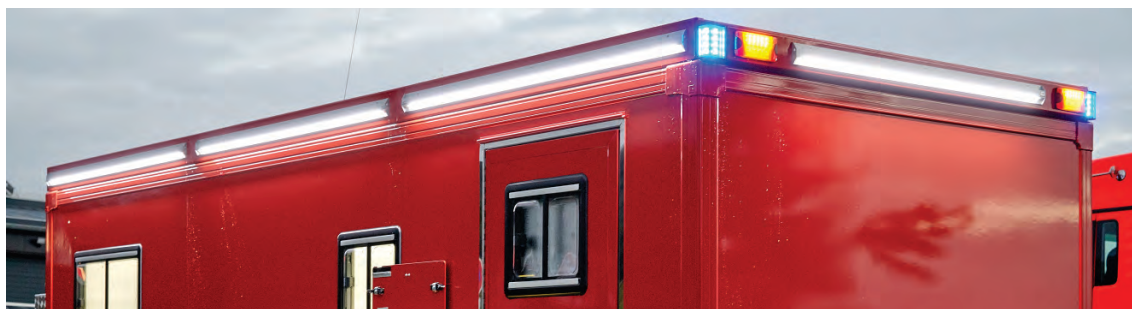
Abbildung 42: LED-Lichtstreifenelemente Fabr. LDR, seitlich und hinten.
