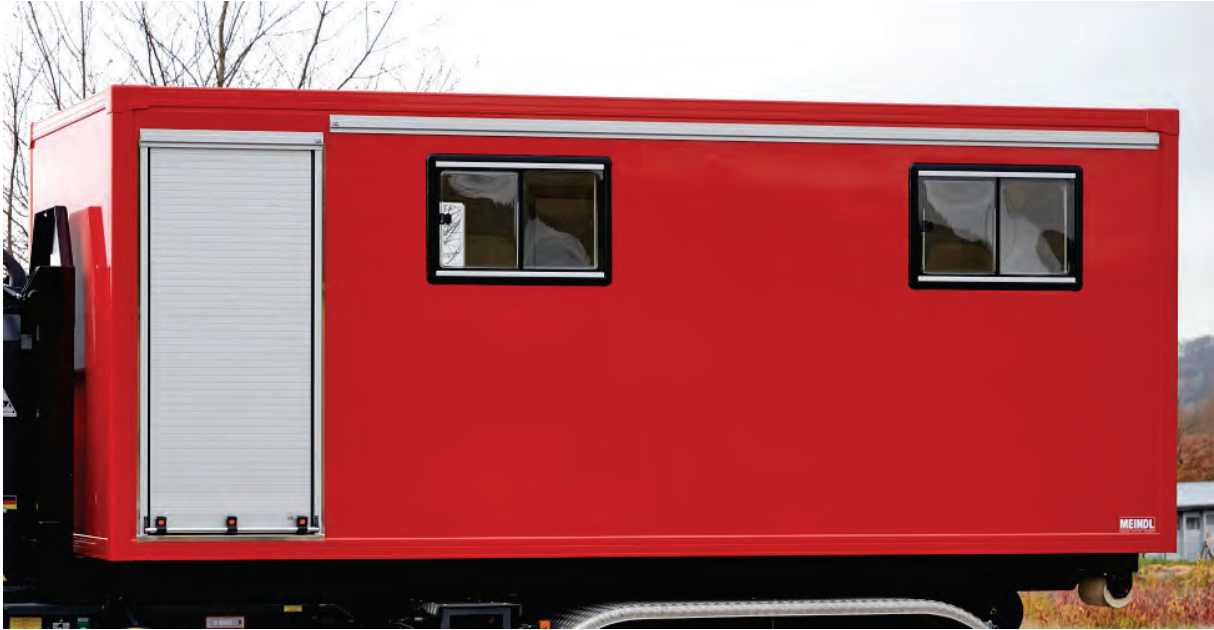
Abbildung 1: AB Besprechung mit vorderen abgetrennten Geräteräumen mit Rollläden, Kunststoff-Sandwichbauweise. LED-Umfeldbeleuchtung über die gesamte Aufbaulänge.
