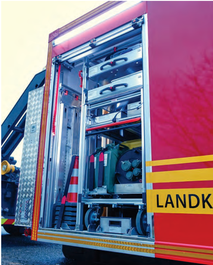
Abbildung 5: Detail – Vorderer separater Geräteraum mit Regalanlage.
