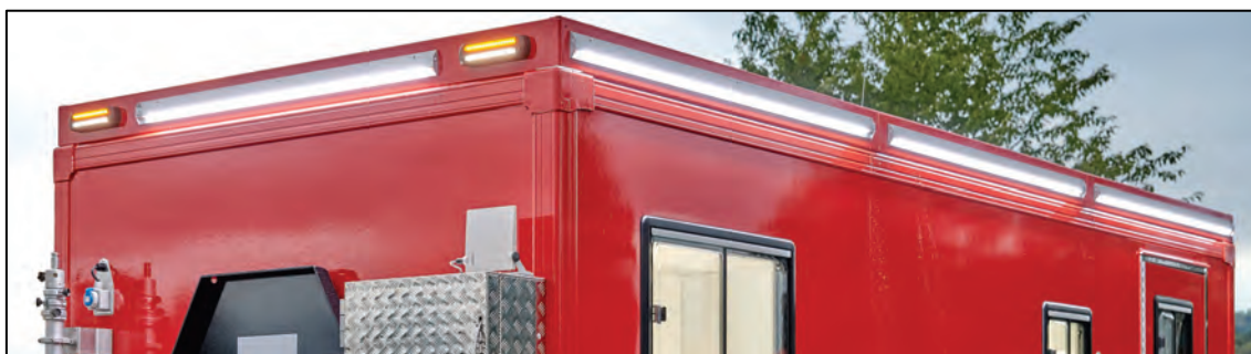
Abbildung 54: Dachgalerie umlaufend (hier mit Umfeld- und Positionsbeleuchtung).
