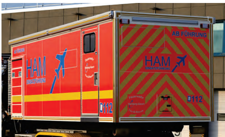
Abbildung 62: Heckschraffur-Kennzeichnung, seitliche Konturmarkierung, Beschriftung nach Vorgabe.
