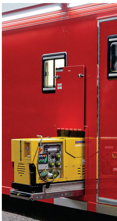
Abbildung 21: Detail – Silent-Stromerzeuger auf MEINDL-Schwerlastauszug. Alternativ kann der Stromerzeuger auf einem Rollcontainer verlastet werden. Durch eine Verbindungsleitung zum AB führt diese Lösung im Innenraum zu einer deutlichen Geräuschkürzung.
