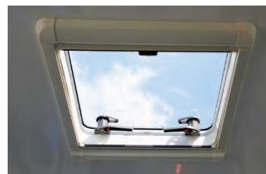
Abbildung 52: Standard-Dachfenster mit Rollos für Insektenschutz und Rollos für Sonnenschutz.
