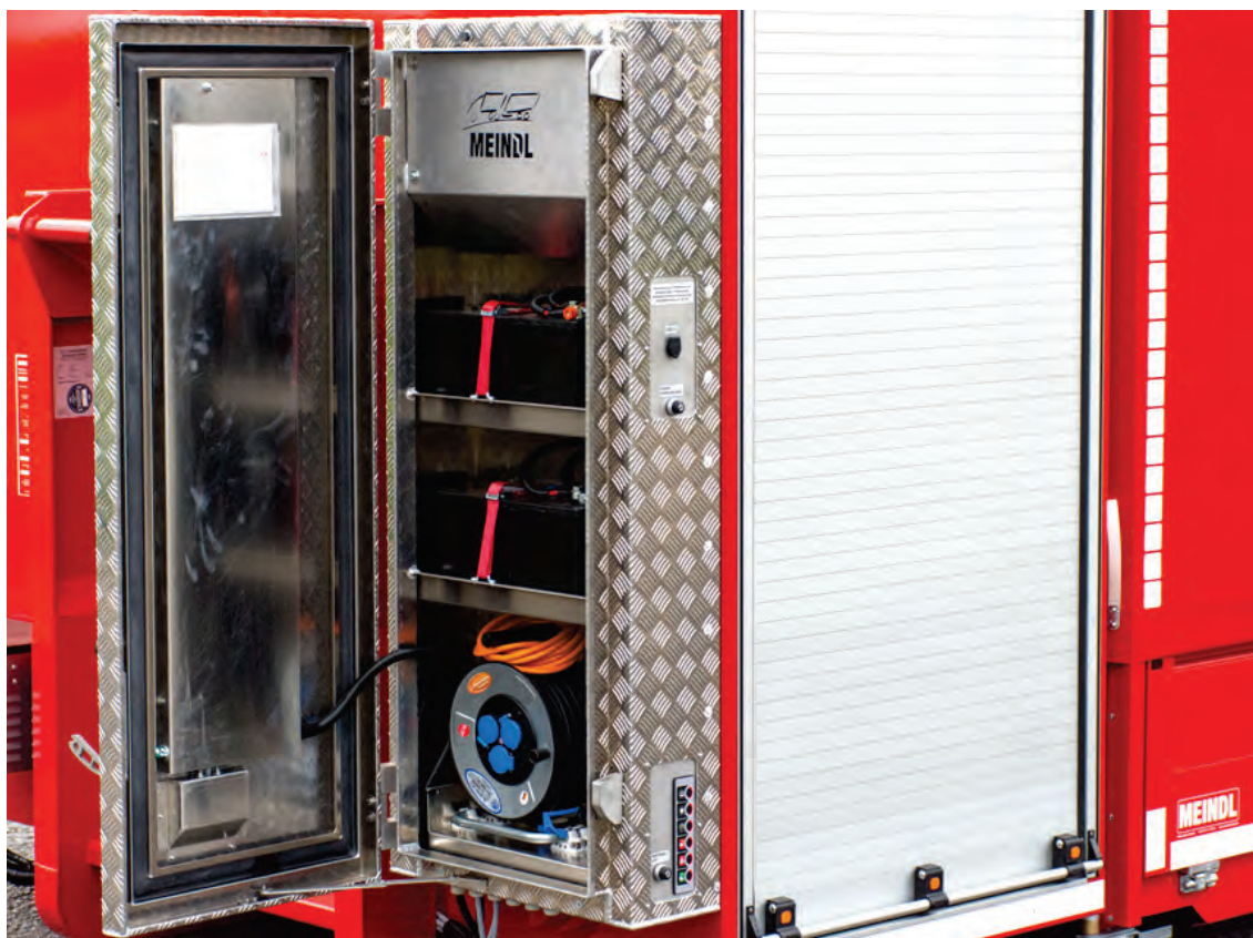
Abbildung 15: Detail – Zentraler Stirn-Schaltschrank, sehr hochwertige Ausführung mit 2 Verschlüssen und groß dimensionierter Gummidichtung. Der MEINDL-Schaltschrank ist von uns speziell für diesen Einsatzzweck konstruiert!
