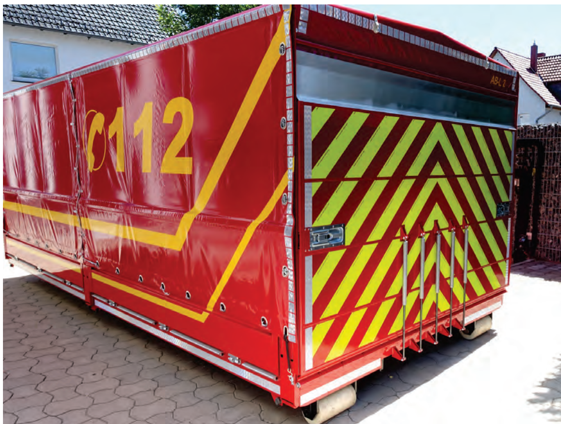
Abbildung 10: Detail – Seitliche Rollplanen geschlossen, Heckansicht mit Plane oberhalb der Heckklappe.
