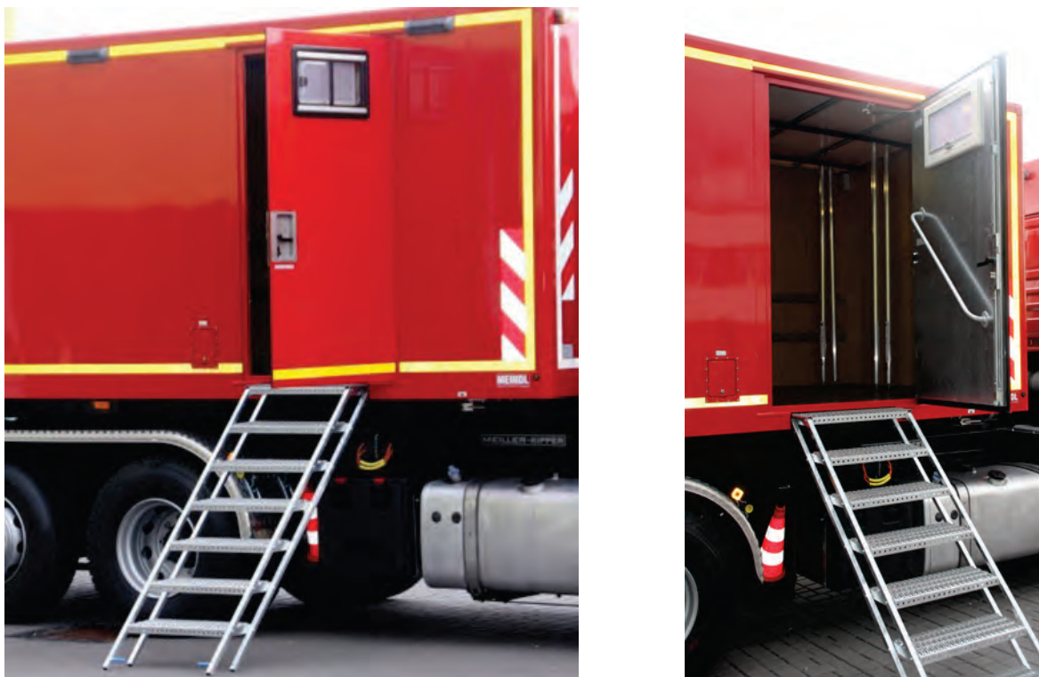
Abbildung 38: Seitentür vorne rechts, Schiebetreppe mit Podest und Handlauf in der Tür.
