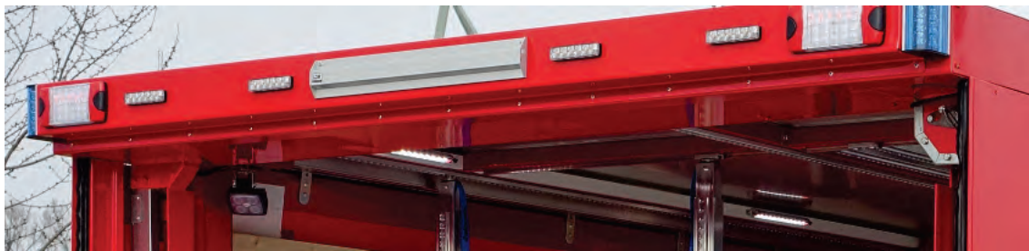
Abbildung 44: LED-Lichtstreifenelement Fabr. LDR, hinten.
