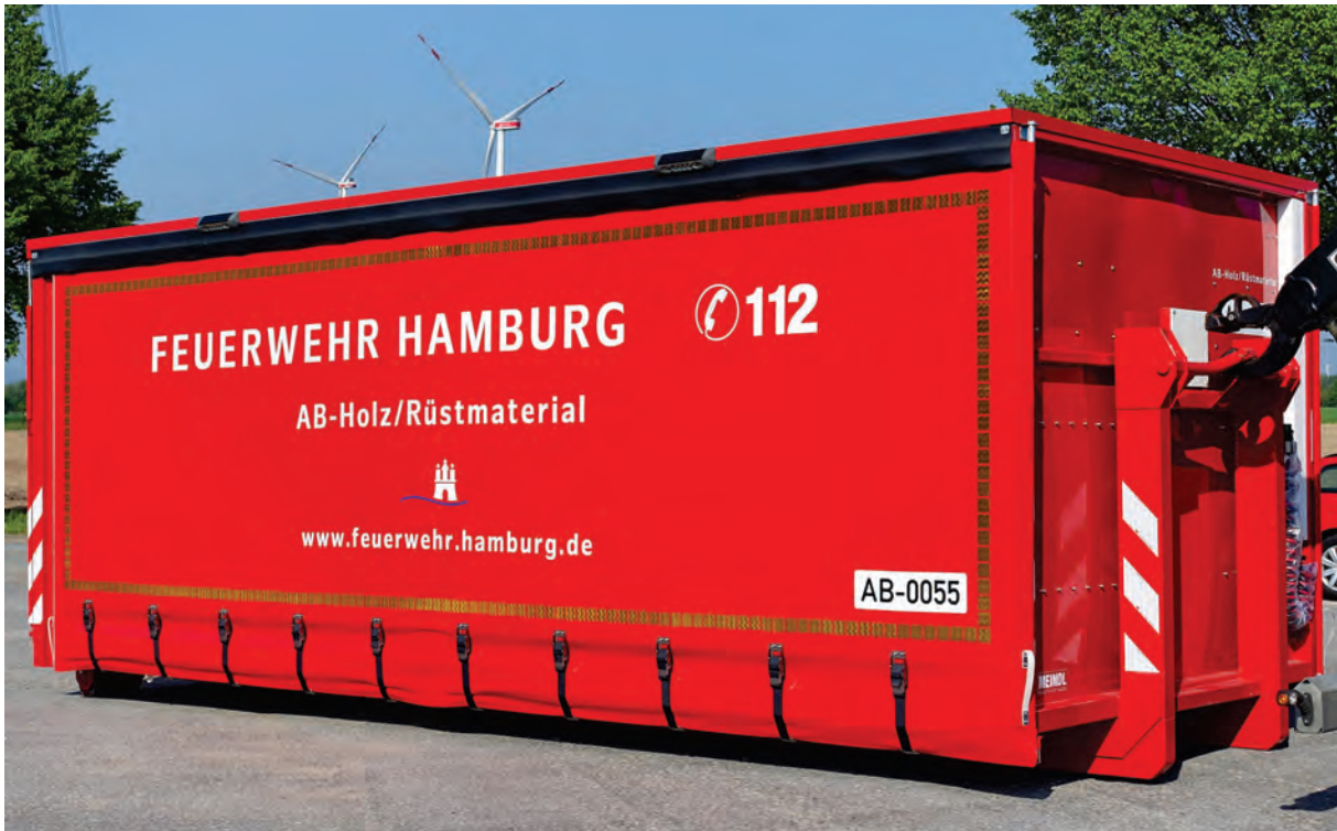
Abbildung 7: AB Transport als geschlossener Pritschenaufbau in Ausführung mit seitlicher Schiebeplane, hier ohne zusätzliche seitliche Bordwände.
