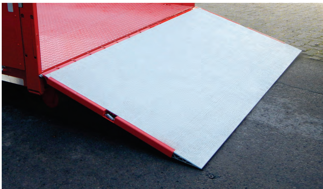
Abbildung 12: Detail – Auffahrrampe Rutschfestigkeitsklasse >R11.
