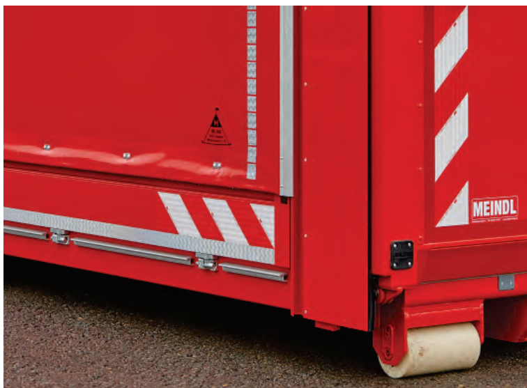
Abbildung 49: Kontur- und DIN-Warnmarkierung.
