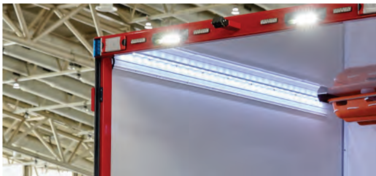
Abbildung 41: LED-Laderaumbeleuchtung (hier bei Ausführung Kofferaufbau).
