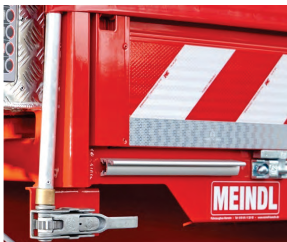
Abbildung 21: Spannvorrichtung der Seitenplanen.
