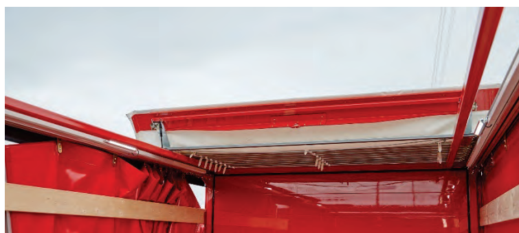
Abbildung 23: Schiebedach nach vorne hin geöffnet.
