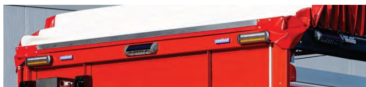
Abbildung 31: Frontblitzer, hier bei Planenausführung mit Schiebedachanlage.
