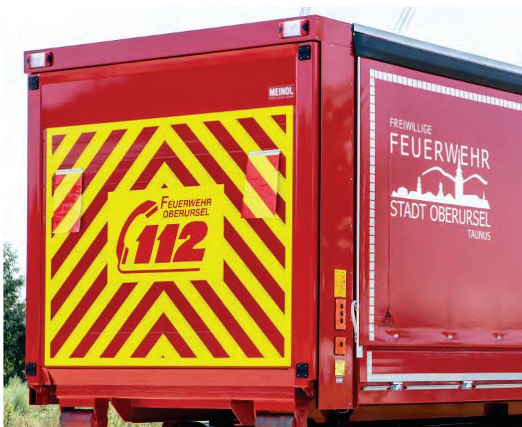
Abbildung 50: Heckschraffur-Kennzeichnung, seitliche Konturmarkierung, Beschriftung nach Vorgabe.
