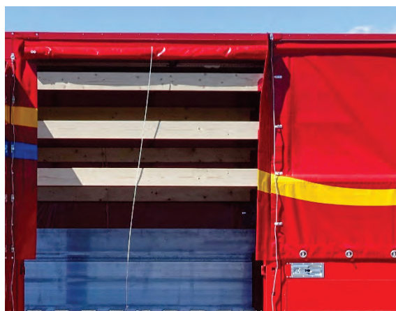
Abbildung 22: Rollplane geöffnet / geschlossen.
