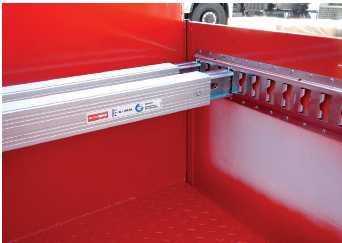
Abbildung 14: Detail – Alternative Ladungssicherung mit Sperrbalken.
