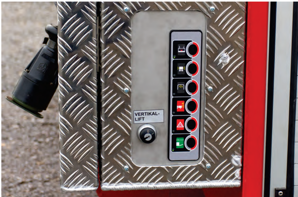
Abbildung 17: Detail – CAN-BUS gesteuerte Zentralelektrik, Standard-Bedienteil mit Notbedienfunktion bei Unterspannungsauslösung, Steuerung für Beleuchtung und ggf. zusätzliche Verbraucher.
