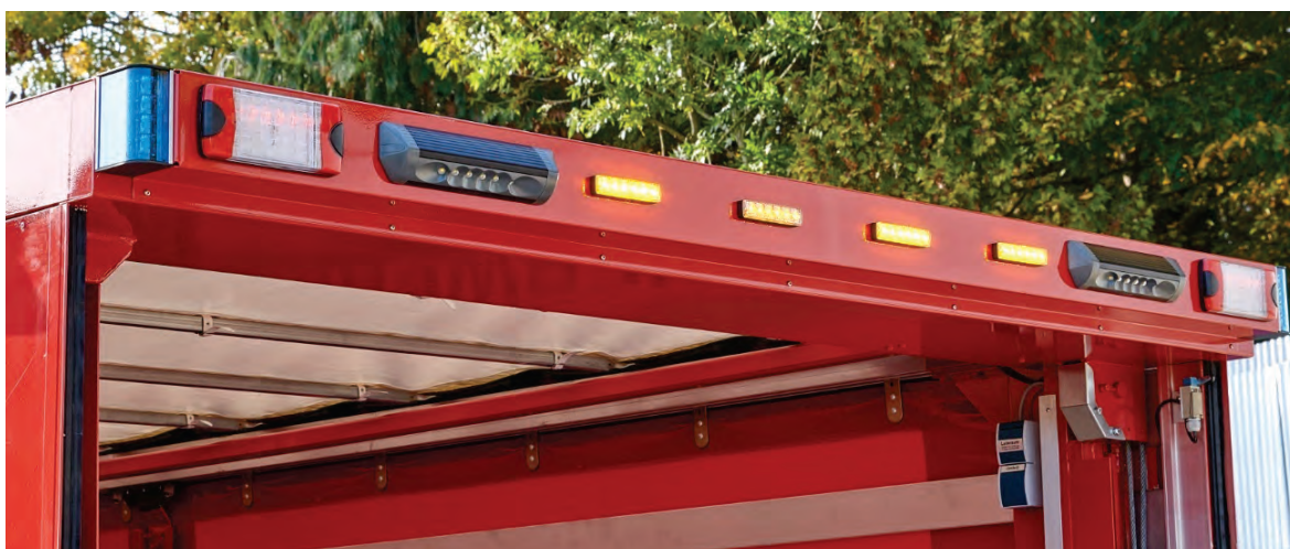
Abbildung 32: Heckleuchtenkonsole, hier mit voller Bestückung, jedoch ohne Rückfahrkamera.
