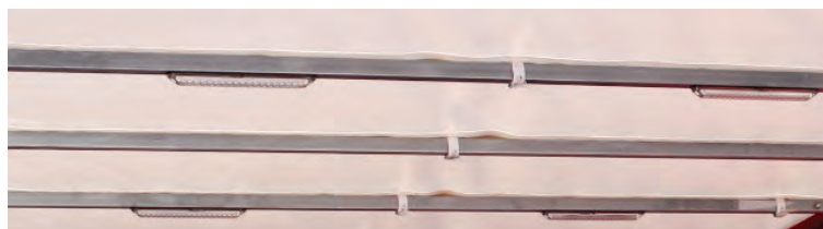
Abbildung 40: LED-Laderaumbeleuchtung (hier bei Ausführung Planendach).
