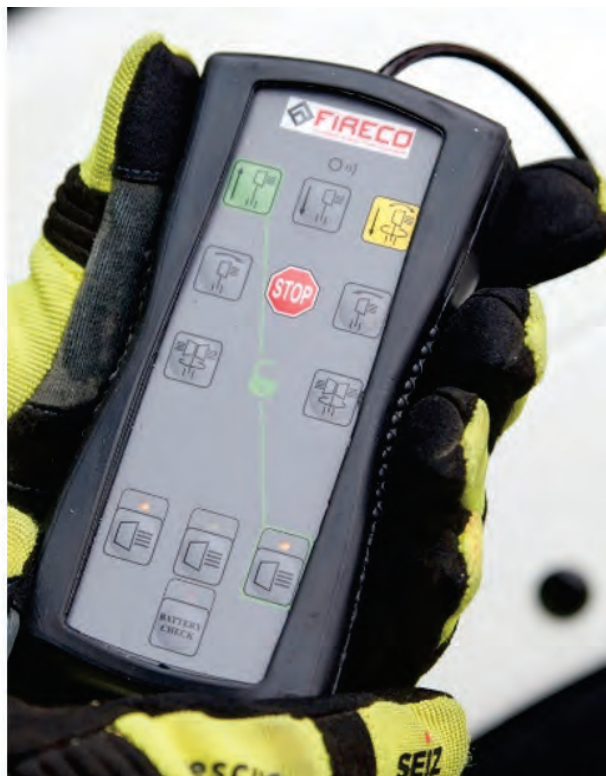
Abbildung 45: Lichtmast (hier zusätzlich mit LED-Blitzleuchte, grün). Ausführung mit Elektro-Druckluftherzeuger. Fernsteuerung für den Lichtmast.
