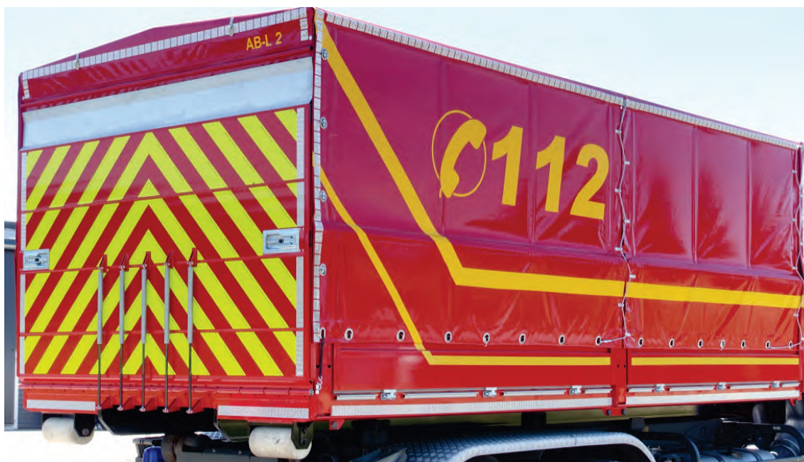
Abbildung 5: AB Transport als geschlossener Pritschenaufbau (hier mit seitlicher Rollplane). Glatte Ausführung der Auffahrrampe, gut für Beschriftungen geeignet. Plandachausführung mit Dachneigung, diese verhindert zuverlässig die Bildung von Eisflächen im Winter, wenn der Behälter im Freien gelagert wird.
