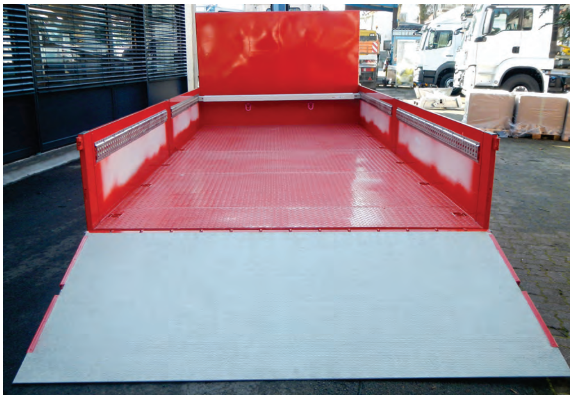
Abbildung 11: Detail – Auffahrrampe abgeklappt, Ladeflächenboden in Stahl-Warzenblech.
