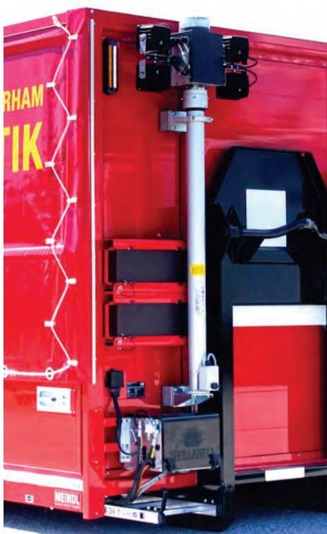
Abbildung 45: Lichtmast (hier zusätzlich mit LED-Blitzleuchte, grün). Ausführung mit Elektro-Druckluftherzeuger. Fernsteuerung für den Lichtmast.
