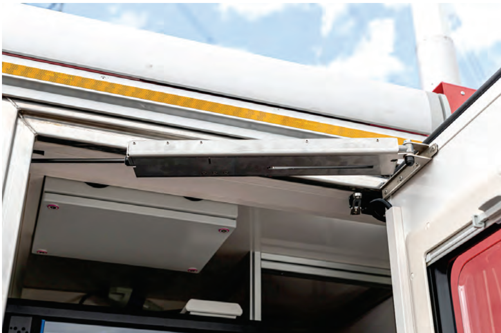
Abbildung 25: Detail – MEINDL-Türfeststeller (unkaputtbar), hält beidseits durch je eine Gasdruckfeder bei einem 90°-Öffnungswinkel, zusätzlich bei 180° arretierbar.
