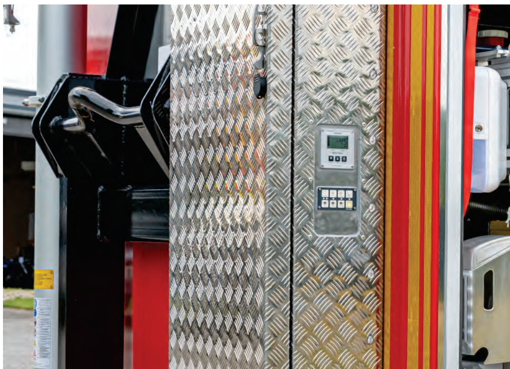
Abbildung 35: Detail – CAN-BUS-gesteuerte Zentralelektrik, Standard-Bedienteil mit Notbedienfunktion bei Unterspannungsauslösung, Steuerung für Beleuchtung und ggf. zusätzliche Verbraucher.
