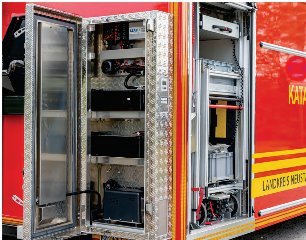
Abbildung 33: Detail – Zentraler Stirn-Schalterschrank, sehr hochwertige Ausführung mit 2 Verschlüssen und groß dimensionierter Gummidichtung. Der MEINDL-Schalterschrank ist von uns speziell für diesen Einsatzzweck konstruiert!
