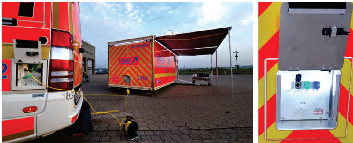
Abbildung 62: Übergabeeinheit (IuK-Anschlussfeld), Detail – MEINDL-Übergabeeinheit.
