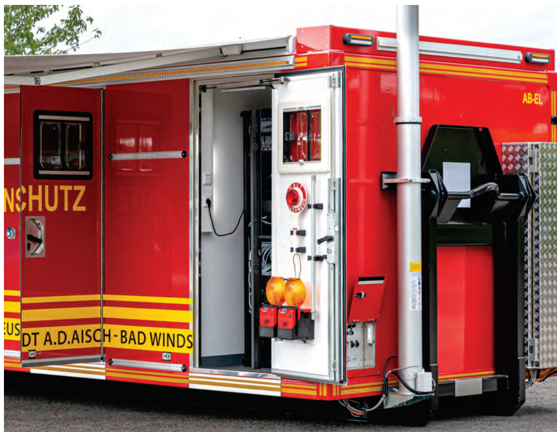
Abbildung 6: Detail – Serverraum, Übergabeklappe, kombinierter Funk- / Lichtmast.
