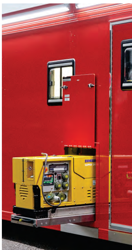
Abbildung 31: Detail – Links im Bild: Silent-Stromerzeuger auf MEINDL-Schwerlastauszug. Rechts im Bild: Alternativ kann der Stromerzeuger auf einem Rollcontainer verlastet werden. Durch eine Verbindungsleitung zum AB führt diese Lösung im Innenraum zu einer deutlichen Geräuschminderung.
