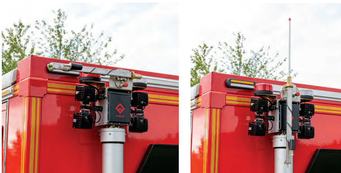
Abbildung 27: Detail – Antennenmast, hier mit roter und grüner LED-Blitzleuchte an der Spitze des Mastes.
