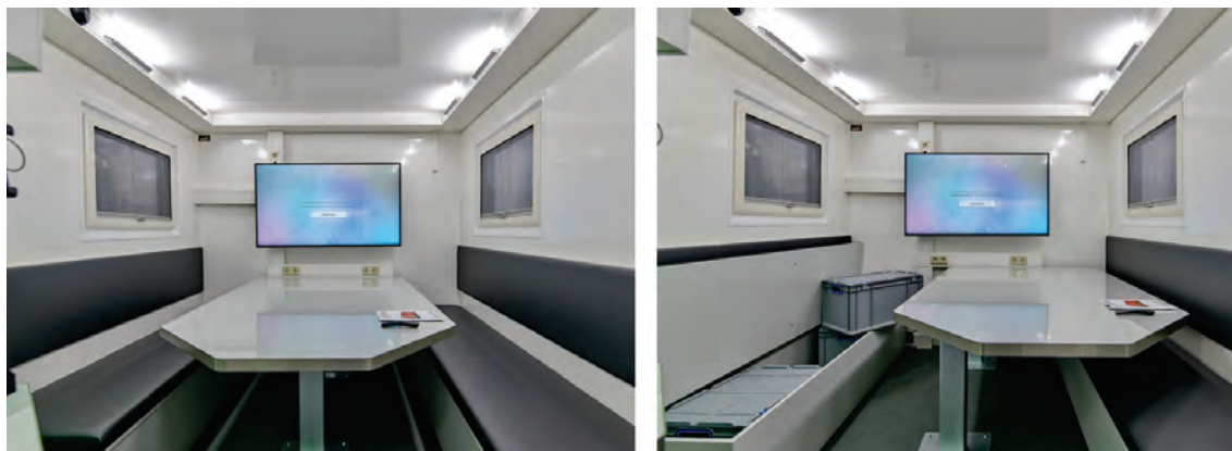
Abbildung 58: MEINDL-Besprechungstisch, verschiebbare Tischplatte für besseren Zugang.
