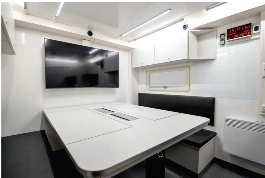
Abbildung 16: Detail – AB ELW 2 Führungsraum: Sicht aus dem Bereich der Eingangstür mit Funk-Uhr und Schnell-Heizlüfter.
