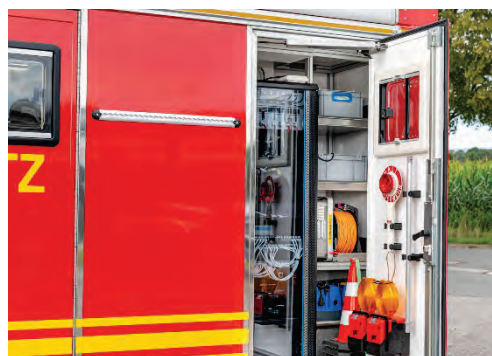
Abbildung 49: Zugang zum Technikraum, hier als Drehtür ausgeführt.
