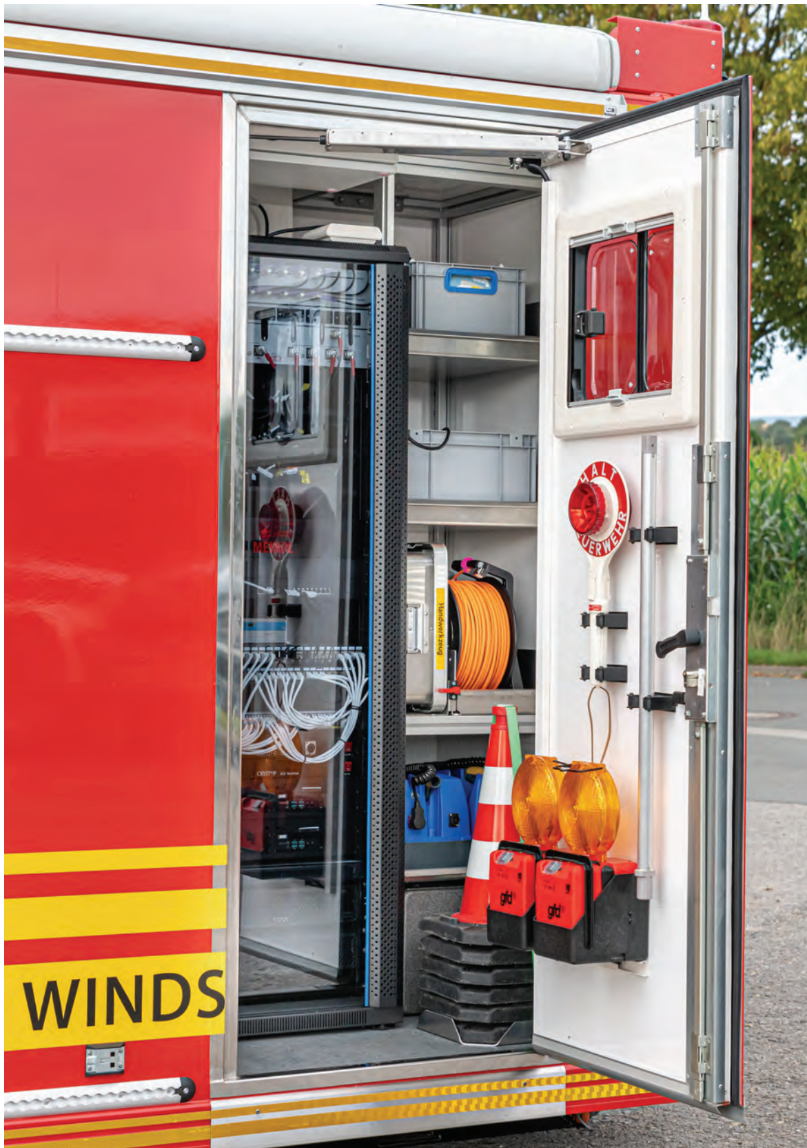
Abbildung 22: Detail – Technikraum (hier der Serverraum, auf der Rückseite ist der Geräteraum angeordnet).
