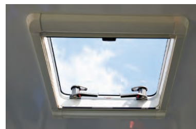
Abbildung 67: Standard-Dachfenster mit Rollo für Insektenschutz und Rollo für Sonnenschutz.
