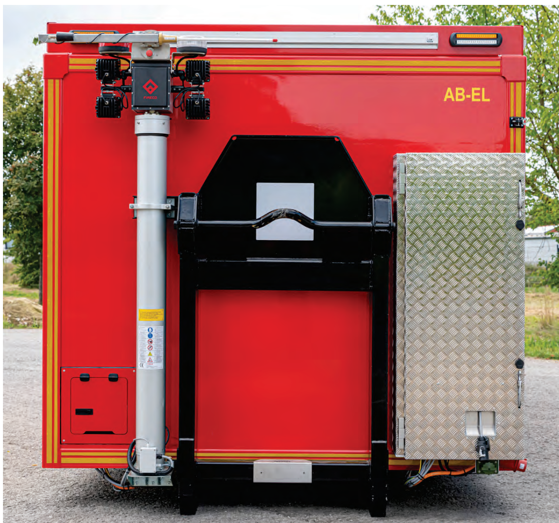
Abbildung 26: Detail – Komplettansicht der Stirnwand mit Hakenaufnahme, zentralem Stirn-Schaltschrank und Antennenmast (hier kombiniert als Lichtmast). Grundrahmen mit stabilem, großzügig dimensioniertem Anstoßschutz.
