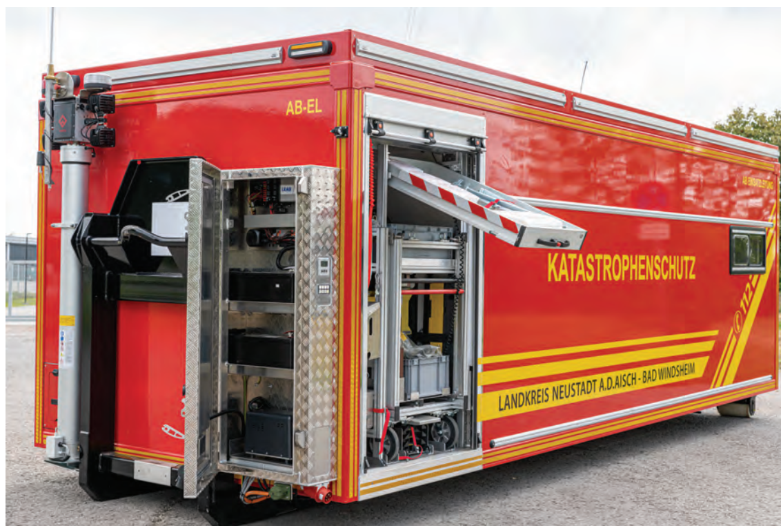
Abbildung 5: Detail – Vorderer separater Geräteraum mit Regalanlage und Stromerzeuger auf einem Rollcontainer.
