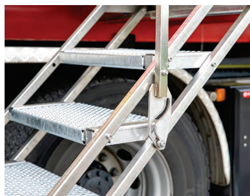
Abbildung 48: Längs einschiebbare Treppe mit selbstaufstellendem Edelstahl-Geländer.
