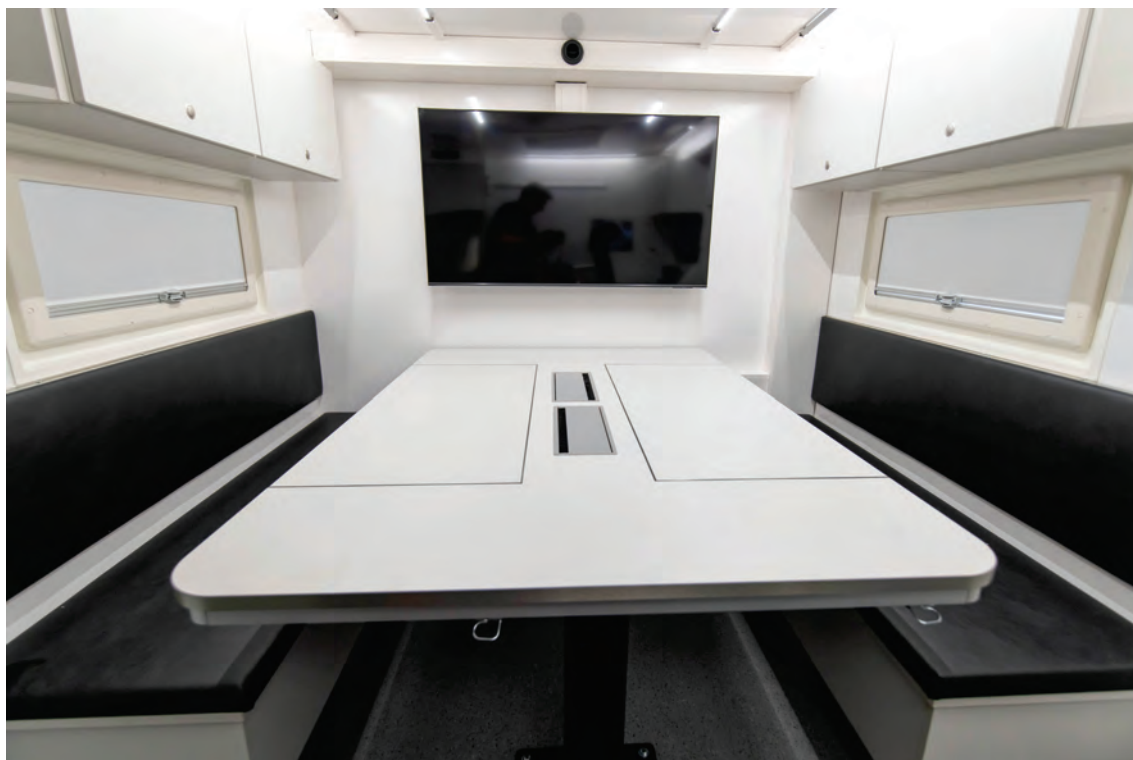
Abbildung 14: AB ELW 2 Führungsraum (optional mit seitlich verschiebbarem Besprechungstisch für optimale Ergonomie und Erreichbarkeit der einzelnen Sitzplätze), Klappbänke mit Stauraum, Oberschränke, Fenster mit Rollläden / Fliegengitter sowie 55"-Monitor.
