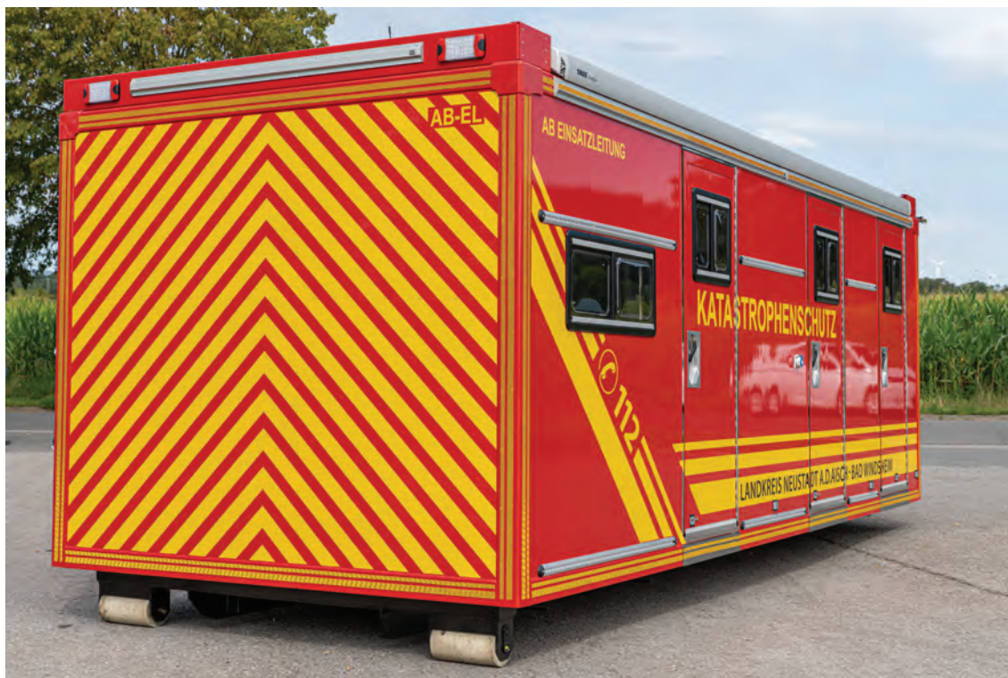
Abbildung 3: Geschlossenes Heckportal mit Warnbeklebung, Heckbeleuchtung und durchgehender Umfeldbeleuchtung.
