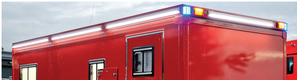
Abbildung 53: LED-Lichtstreifenelemente Fabr. LDR, seitlich und hinten.
