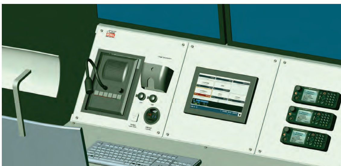
Abbildung 11: Zeichnungsdetail – Teilansicht Kommunikationsboard eines Funk-Arbeitsplatzes.
