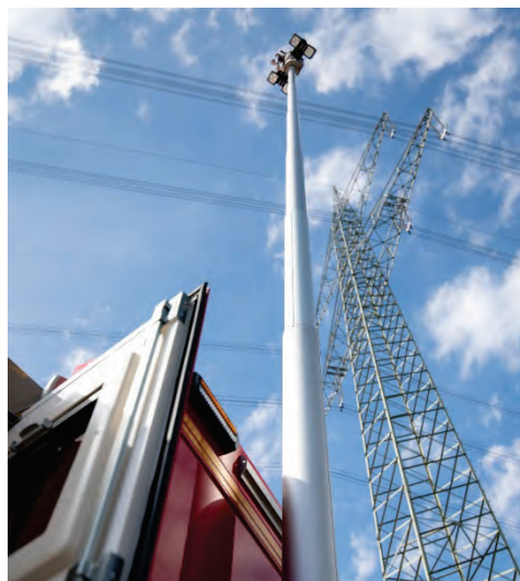
Abbildung 54: Antennenmast, hier kombiniert als Lichtmast.
