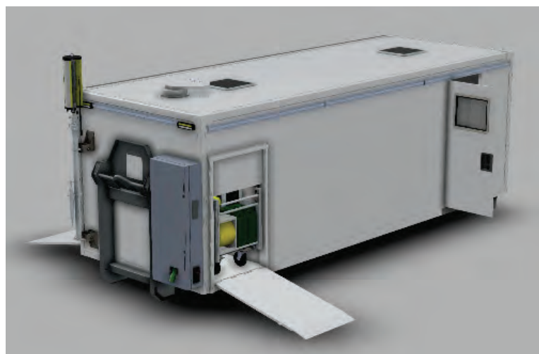
Abbildung 15: 20112588 Abrollbehälter AB Besprechung / AB Führung als Erweiterung zu einem ELW-1 mit autarker Stromversorgung und Lichtmast.
