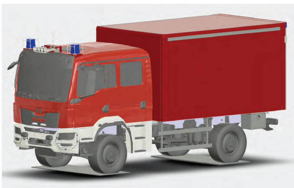
Abbildung 20: 2110530-2 Gerätewagen GW-L, Aufbauausführung: Kofferaufbau.
