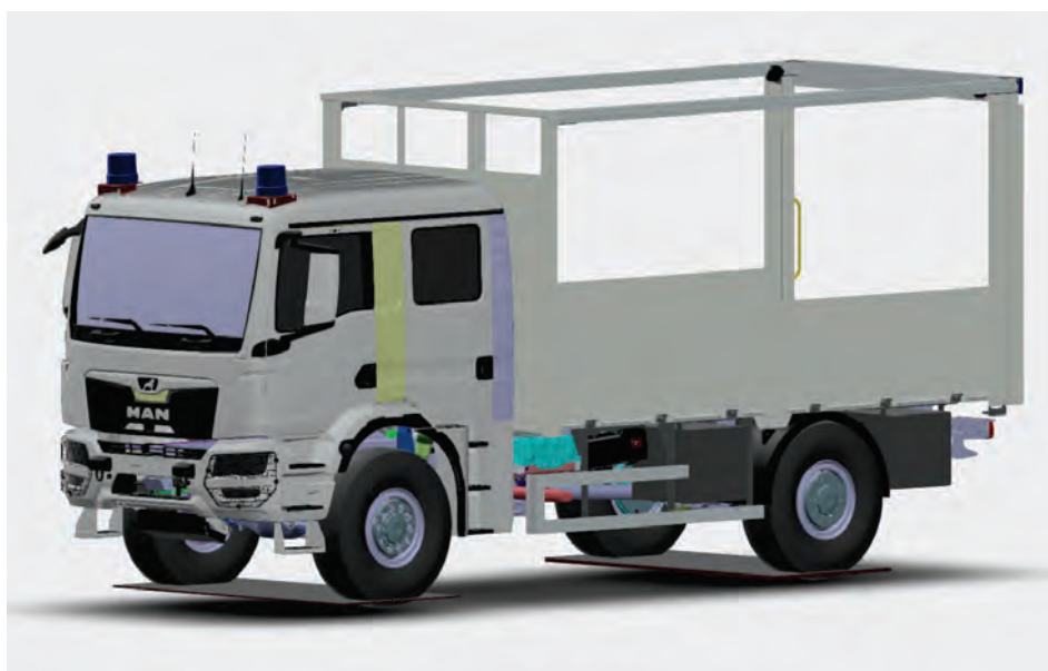
Abbildung 19: 2203426 Gerätewagen GW-L, Aufbauausführung: Pritschenaufbau.
