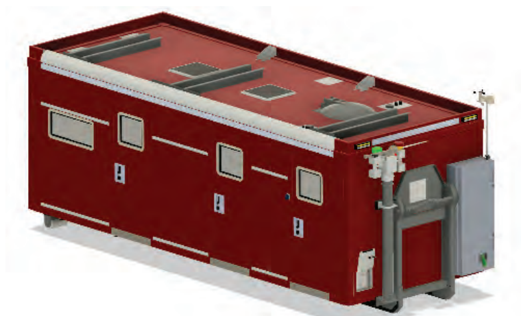
Abbildung 16: 18112389 AB Mobile Wache mit Besprechungsraum, Funkarbeitsplatz, Küchenzeile mit fließendem Wasser, Bad mit Keramik-Waschbecken und -Toilette, Hauswasserwerk mit Frisch- und Abwassertank sowie autarker Stromversorgung.
