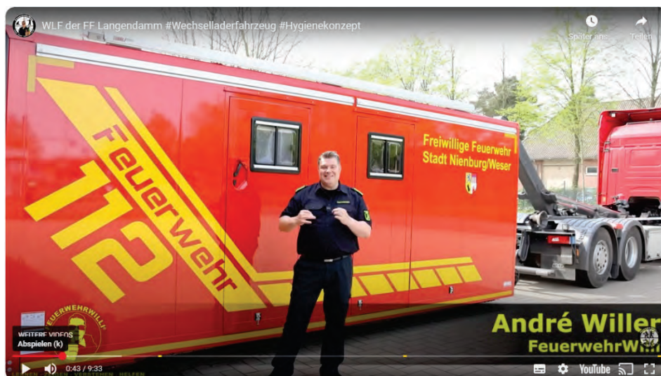
Abbildung 25: 20112635 AB Abrollbehälter Hygiene. Präsentiert von FeuerwehrWilli®. Durch den verbauten Vertikallift hält dieser Abrollbehälter neben der Hygiene- auch eine Logistikkomponente vor.
