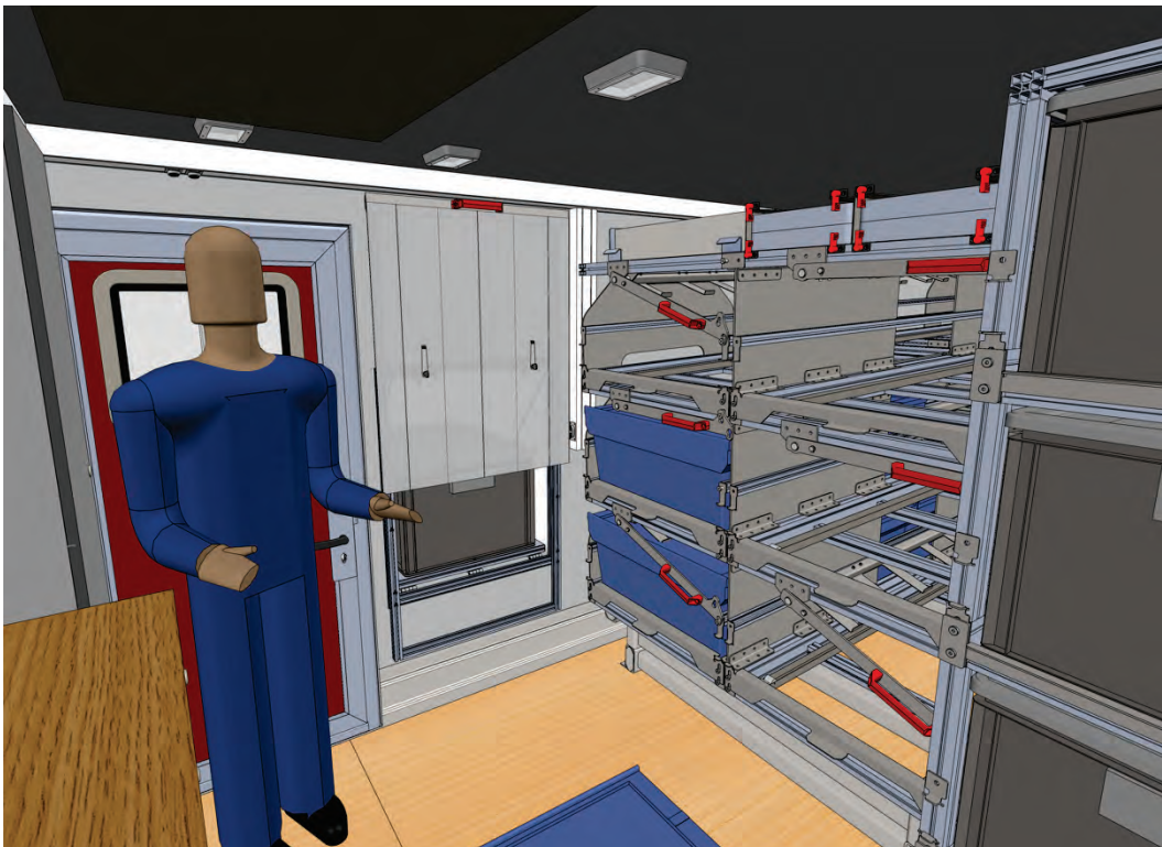
Abbildung 4: Innenansicht in den Bedieneraum. Die BITO-Boxen des schwenkbaren MEINDL-Rollenlager-Magazin-Regales können reihenweise mit je einem Zentralverschluss gesichert werden, sodass diese bei Fahrt arretiert sind.
