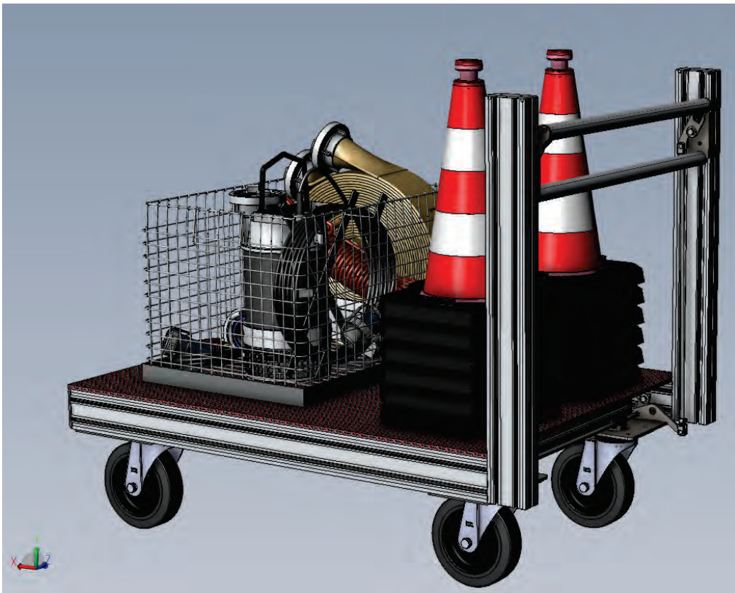
Abbildung 11: Detail – 3D-Konstruktionsansicht MEINDL-Rollcontainer „1x Plattform“ mit Beladung.
