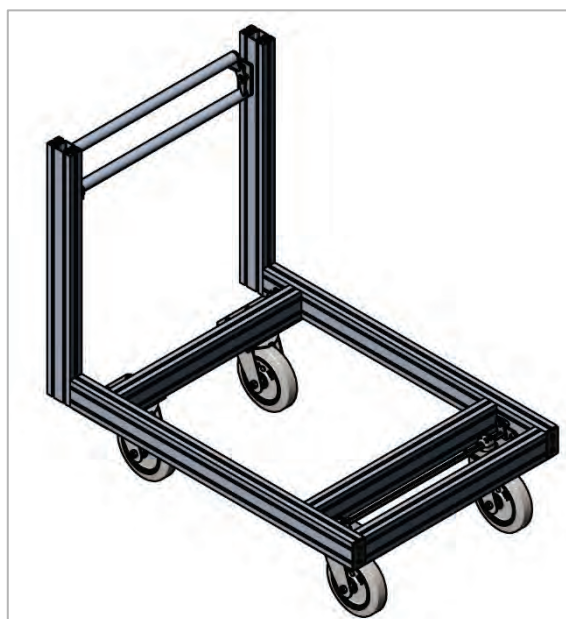
Abbildung 2: Grundmodul der MEINDL-Rollcontainer.
