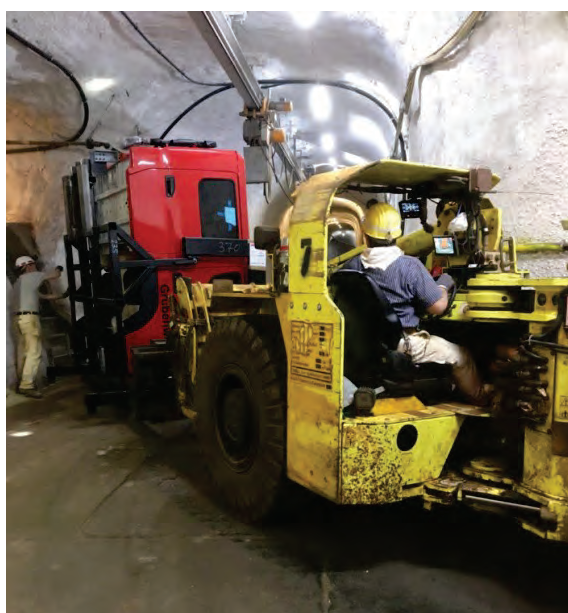
Abbildung 8: Baugruppen des Fahrzeuges in Segmenten unter Tage transportiert.
