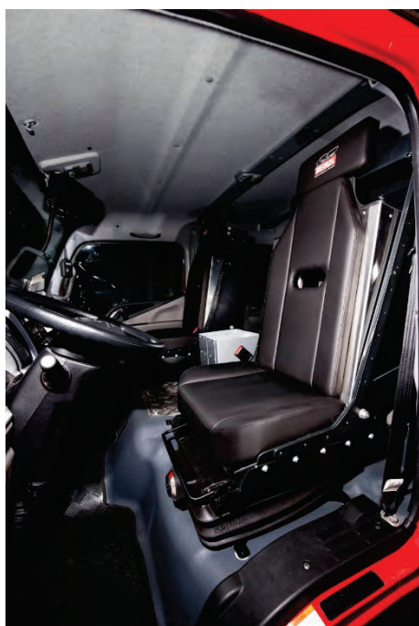
Abbildung 4: Detail – MEINDL-Sitze für Kreislaufatemgerät mit Dreipunktgurt.
