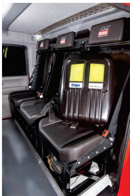
Abbildung 4: Detail – MEINDL-Sitze für Kreislaufatemgerät mit Dreipunktgurt.
