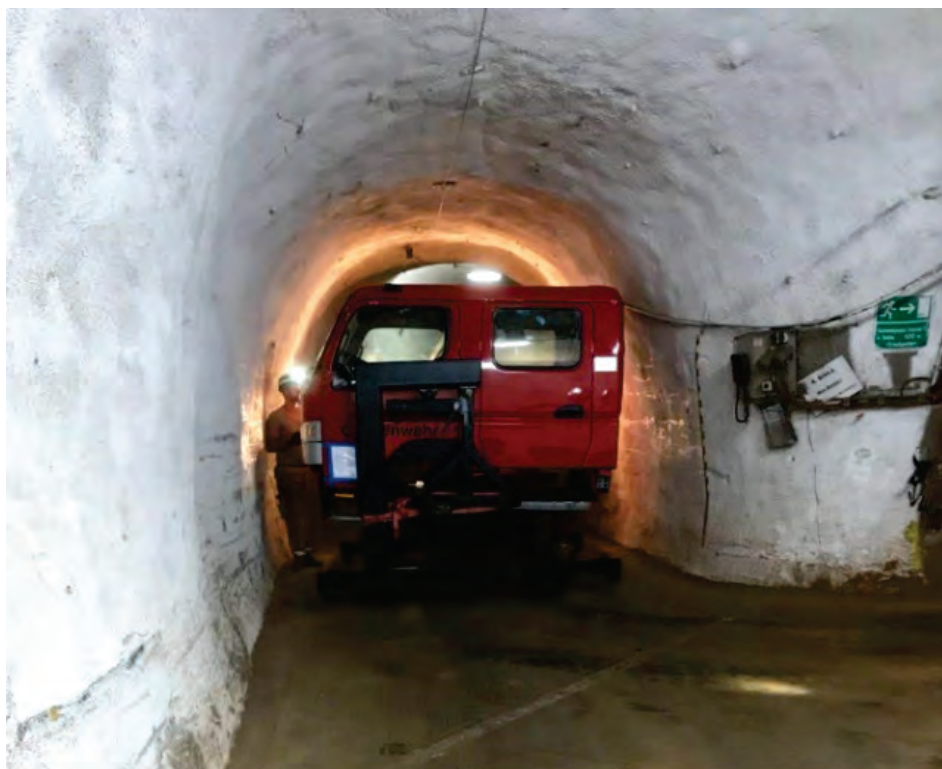
Abbildung 6: Transport des Segmentes „Fahrerhaus“ unter Tage.
