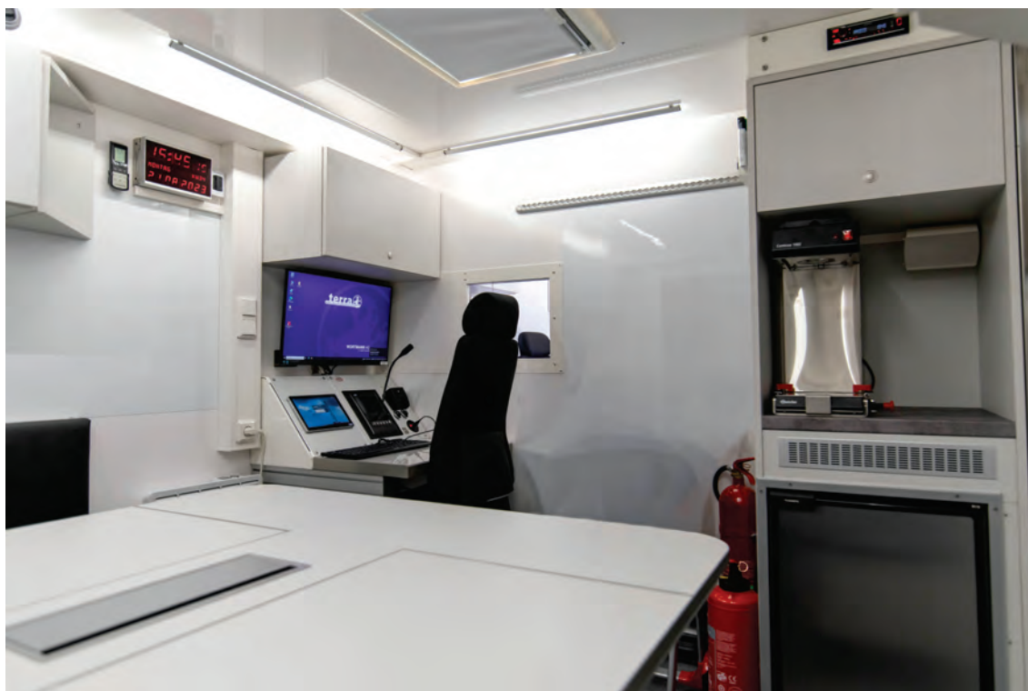
Abbildung 17: Detail – AB ELW 2 Führungsraum: Sicht zum Funk-Arbeitsplatz (hier im Beispiel als zusätzlicher 4. Funk-Arbeitsplatz zu den 3 nach DIN 14507-3 erforderlichen Arbeitsplätzen) mit Übergabe-Schiebefenster zum Kommunikationsraum.
