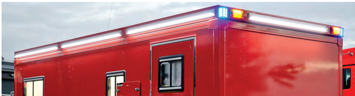
Abbildung 53: LED-Lichtstreifenelemente Fabr. LDR, seitlich und hinten.
