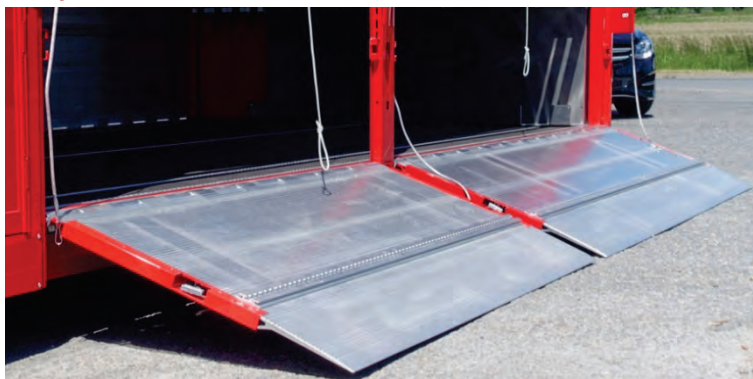
Abbildung 48: Seitenbordwand als Überfahrrampe ausgeführt mit einer aufgesetzten Kombi-Zurrleiste, diese kann zur Entnahme überfahren werden.
