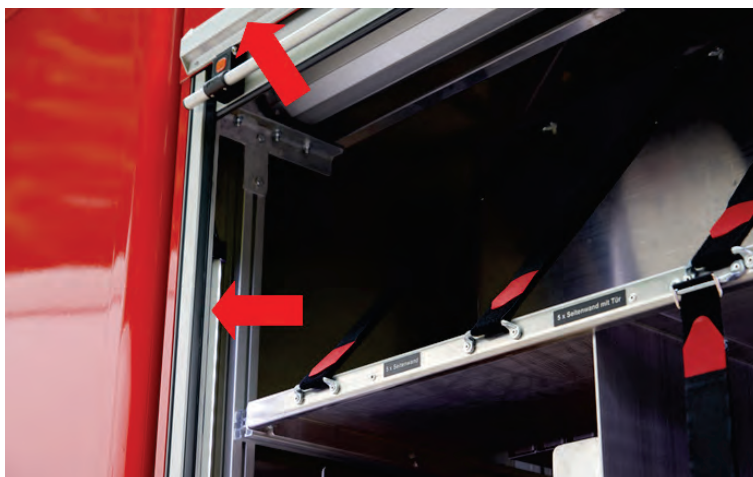
Abbildung 51: Geräte-raumbeleuchtung, LED-Langfeldleuchten innen und außen (Fabr. LDR).
