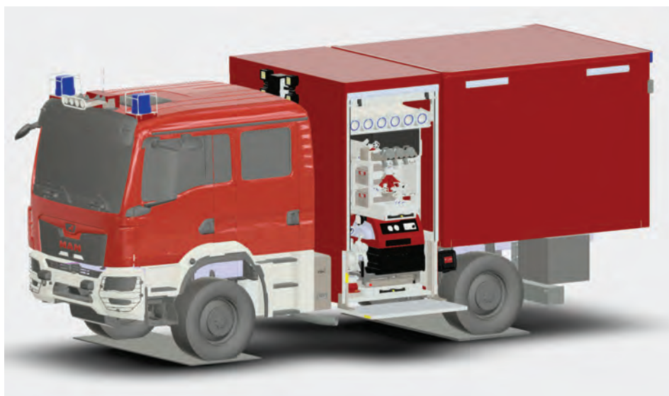
Abbildung 21: 2010504 Gerätewagen GW-L2, abgesetzte Bauweise für höchste Geländetauglichkeit, Aufbauausführung: Kofferaufbau.
