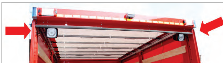
Abbildung 85: LED-Arbeitsstellenscheinwerfer im Heckportal, schwenkbar.
