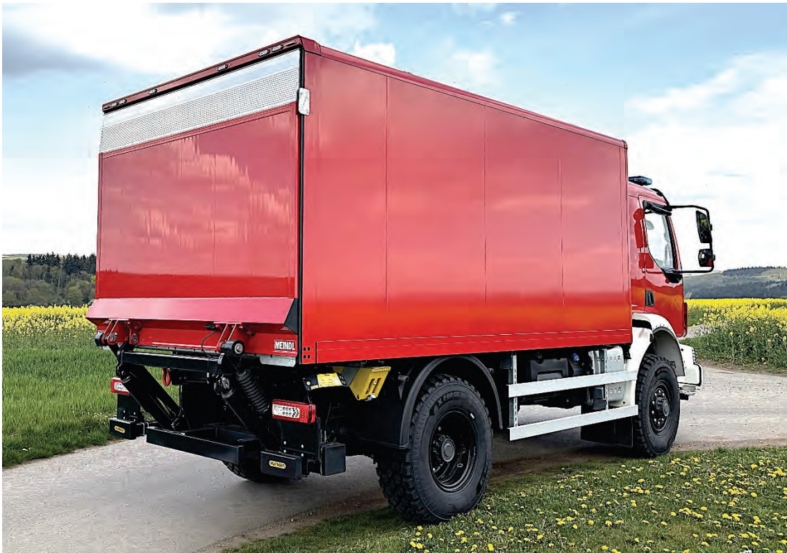
Abbildung 19: Detail – Heckportal in niedriger Ausführung – für eine maximal große Durchgangshöhe. Unser neues spezielles Heckportal ermöglicht eine größere lichte Durchgangshöhe als klappbare Heckkonsolen!
