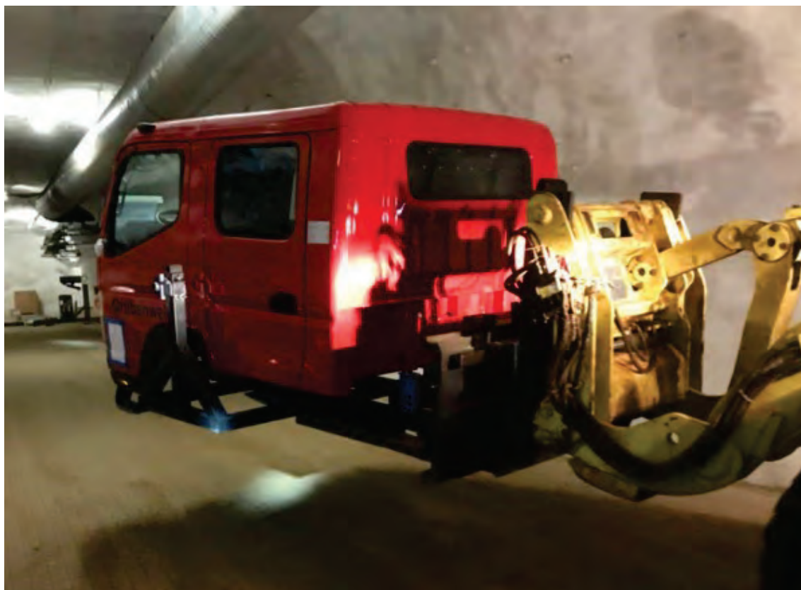
Abbildung 7: Transport des Segmentes „Fahrerhaus“ unter Tage.
