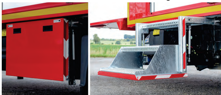
Abbildung 83: Ausziehbarer Klappritt für Aufbau-Zugang über die Seitentür.
