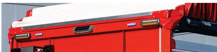
Abbildung 32: Frontblitzer (hier bei Planenausführung mit Schiebedachanlage).
