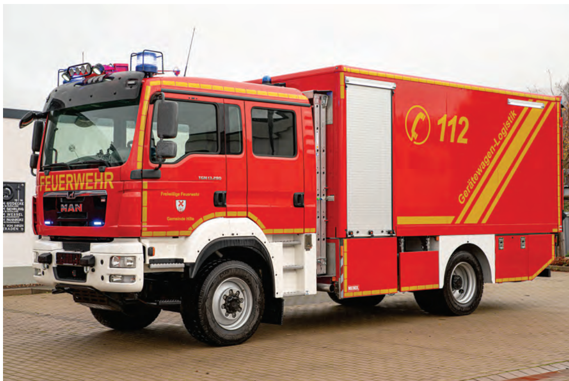
Abbildung 22: GW-L2 auf MAN TGM 4x4-Fahrgestell mit Staffelnkabine. Kofferaufbau (hier FerroFoam®-Bauweise), tiefgezogener im Aufbau integrierter Geräteraum. Der Vorteil dieser Lösung ist, dass der Raum oberhalb der Geräteräume von der Ladefläche aus genutzt werden kann. Hänisch NOVA LED, MARTIN-HORN®-Anlage im MEINDL-Dachkasten, LDR-Umfeldbeleuchtung als Streifenelemente.
