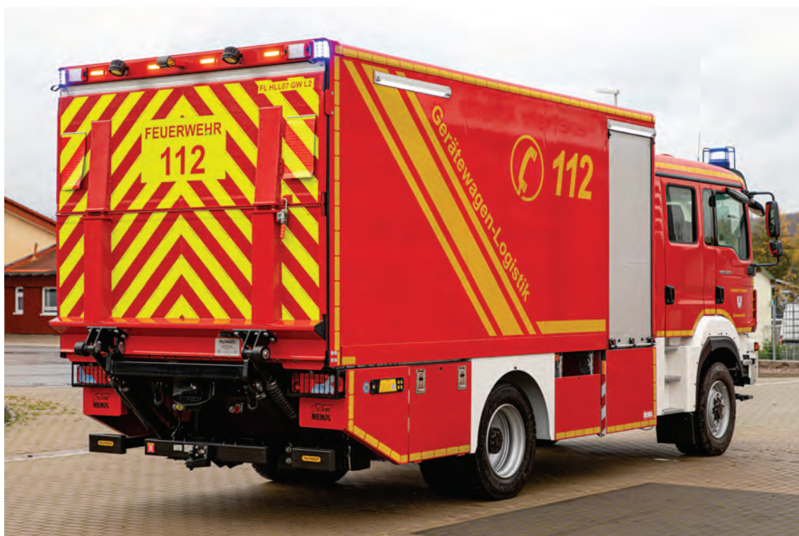
Abbildung 23: Detail – geteilte Ladebordwand zum Verlegen von Schläuchen, Heckportal „normalhoch“. Traversenkästen mit Verblendung, integrierte Aluminium-Kotflügel.
