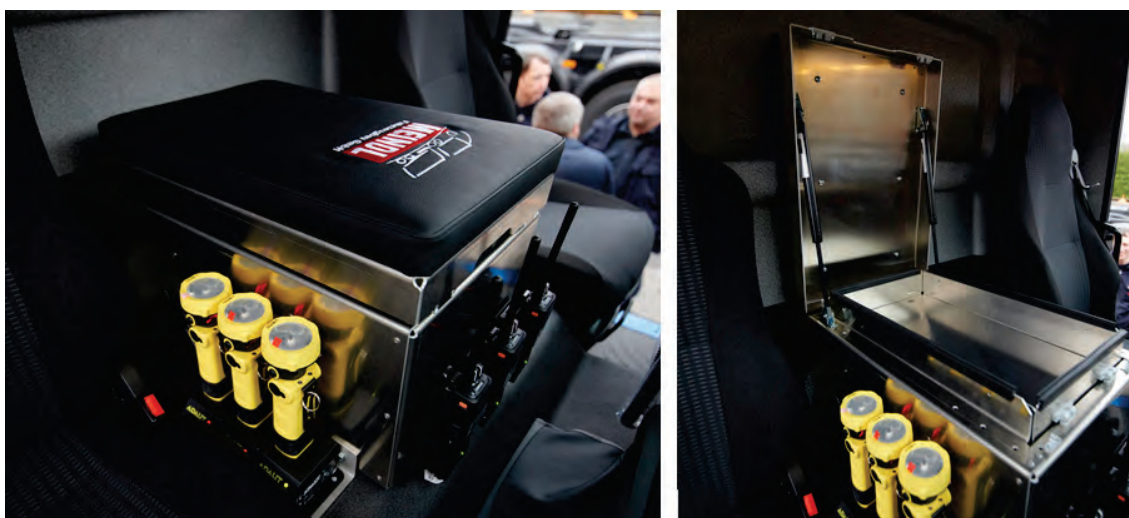
Abbildung 61: Konsolenkasten für Zentralelektrik (hier Alu natur), Oberdeckel in Kunstleder bezogen und gepolstert.
