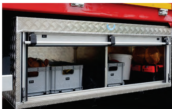
Abbildung 93: Staukasten – Edelstahl mit Alu-Rollladen.
