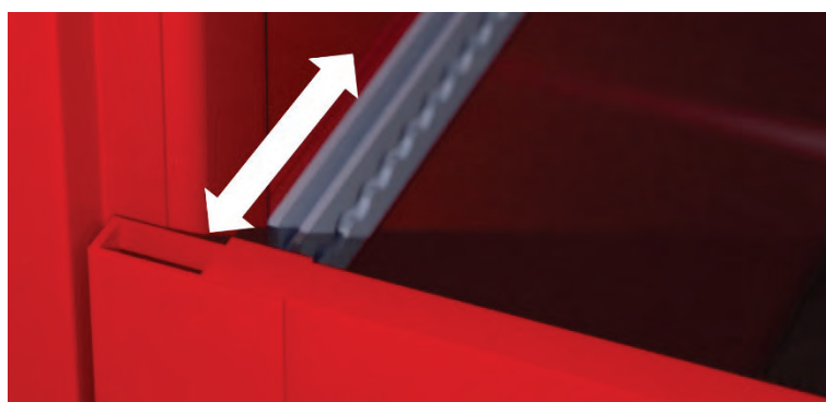
Abbildung 43: Bündige Stirnwand – ohne in die Ladefläche hineinragende Stirnrungen für optimale Be- und Entladung, z.B. mit einem Gabelstapler.
