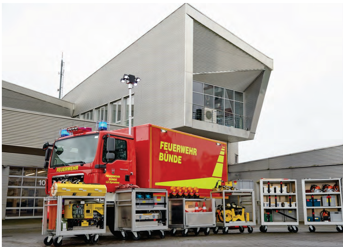
Abbildung 39: GW-L2 Sonderausführung mit darin verlasteten MEINDL-Rollcontainern.
