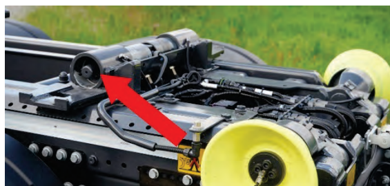
Abbildung 77: Zusätzliche hydraulische Innenverriegelung.
