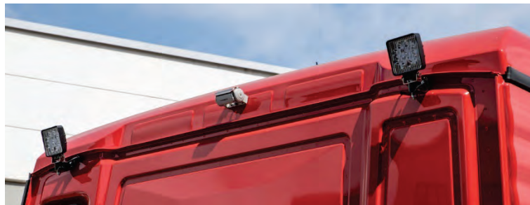
Abbildung 83: LED-Arbeitsstellenscheinwerfer hinten oben am Fahrerhaus.
