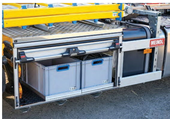
Abbildung 88: Staukasten – Edelstahl mit Alu-Rollladen.
