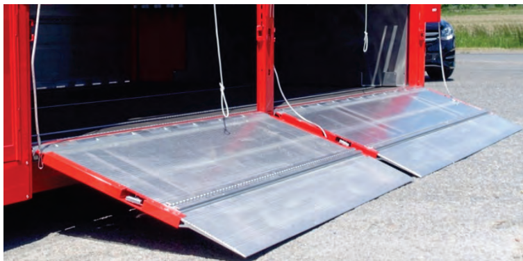
Abbildung 47: Seitenbordwand als Überfahrrampe ausgeführt mit einer aufgesetzten Kombi-Zurrleiste, diese kann zur Entnahme überfahren werden.
