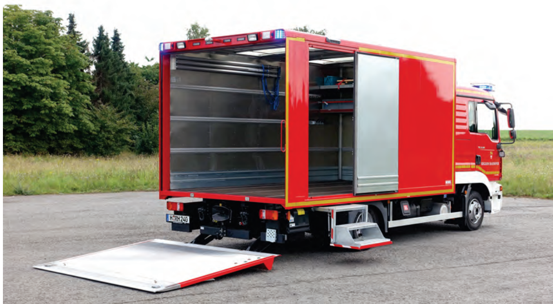
Abbildung 2: GW-L1 auf MAN TGL 4x2-Fahrgestell. Ausführung Kofferaufbau (hier Aluminium-Bauweise). Aufbauausführung in Tiefladerbauweise, dadurch ist bei gleicher Außenhöhe eine um ca. 80 mm größere Ladeflächenhöhe möglich. Heckportal „normalhoch“, optional ist eine um 80 mm niedrigere Ausführung möglich, für maximale Durchgangshöhe. Seitentür, darunter ausziehbarer Klapptritt mit Podest für einen komfortablen Ein- und Ausstieg.
