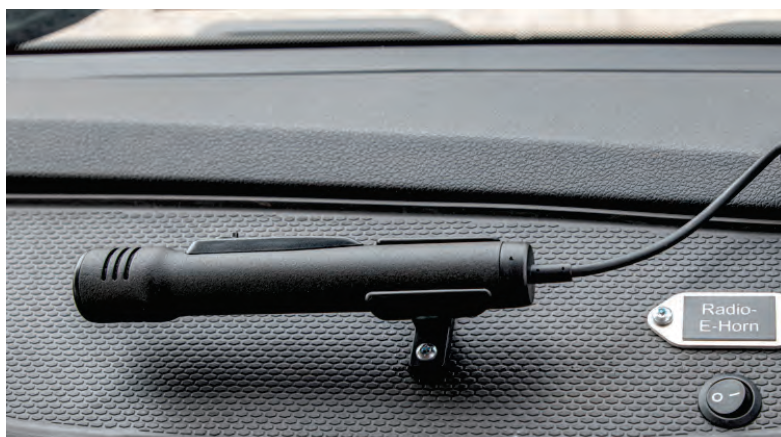
Abbildung 28: Detail – Mikrofon für Durchsagemöglichkeit mit Radio-Aufschaltung.
