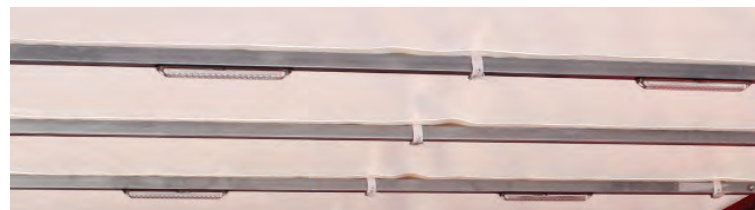
Abbildung 86: LED-Laderaumbeleuchtung (hier bei Ausführung Planendach).
