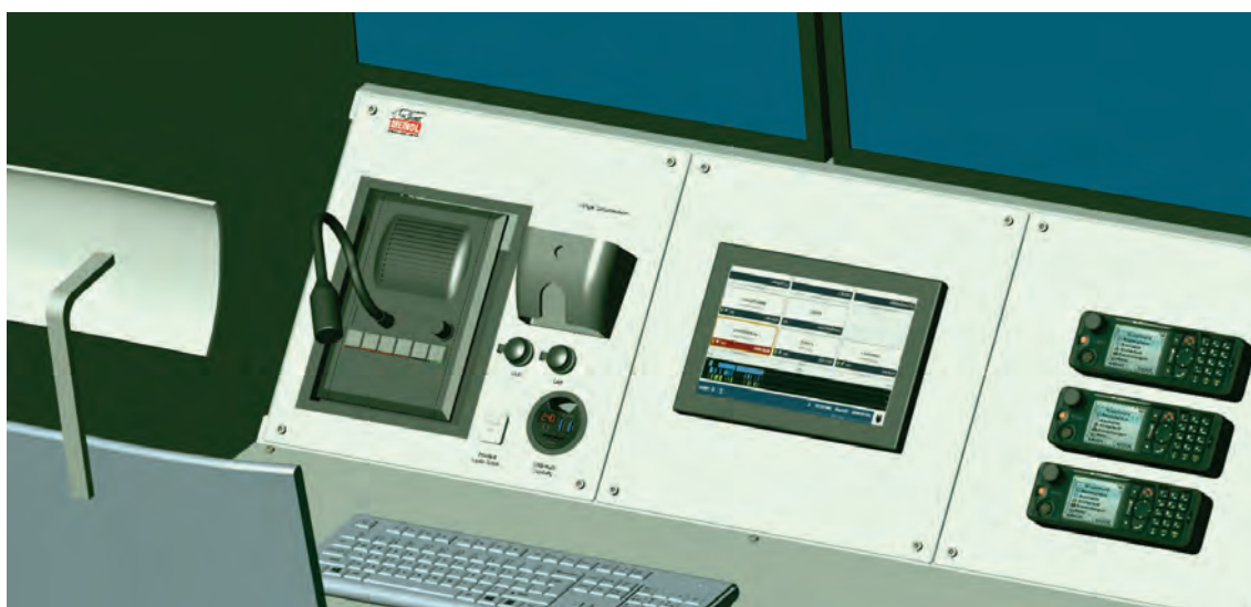
Abbildung 11: Zeichnungsdetail – Teilansicht Kommunikationsboard eines Funk-Arbeitsplatzes.
