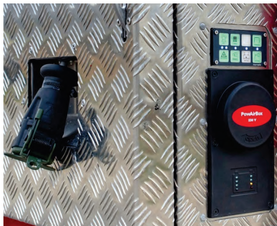
Abbildung 35: Stromeinspeisung PowAirBox, alternatives Bedienteil inomatic®.
