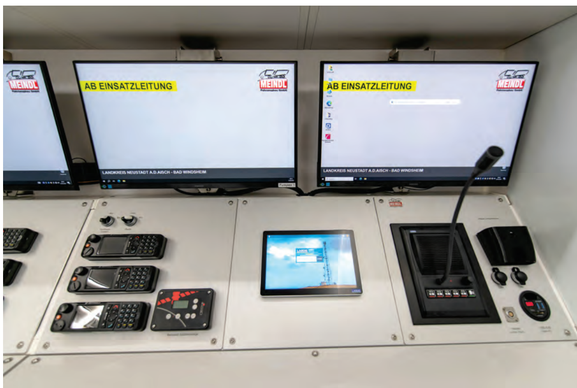
Abbildung 21: Detail – Ergonomisch angeordnete Arbeitsplätze, die Monitore sind in Höhe und Neigung verstellbar, optional zusätzlich in der Neigung verstellbare Funk-Monitore sowie Tastatur- und Maus-Garage direkt zwischen Bedienfeld und Tischplatte. Einfache Zugänglichkeit für Erweiterungen und Service durch verschraubte Front-Paneele.
