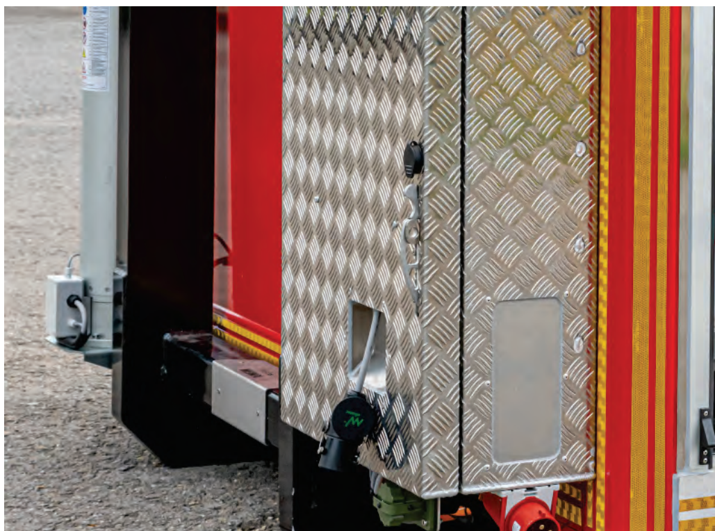
Abbildung 34: Detail – Komfortabler Patentauszug (1.500 mm Auszuglänge) für die Stromversorgung zum Fahrzeug nach DIN. Keine losen Kabel und keine Kabelwicklungen. Der Stecker wird selbsttätig mittels Federauszug eingezogen.
