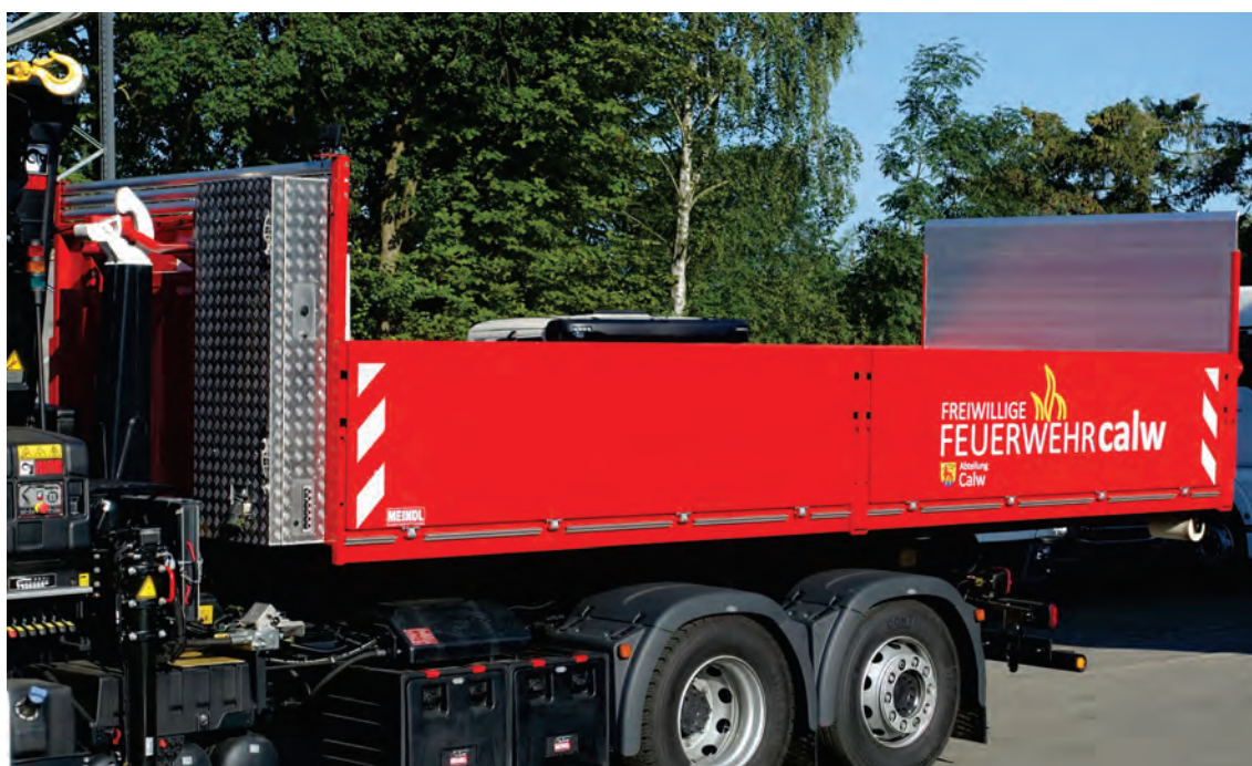
Abbildung 2: AB Transport als offener Pritschenaufbau mit Batterieanlage für Beleuchtung, auf Wunsch mit elektrischer Seilwinde.
