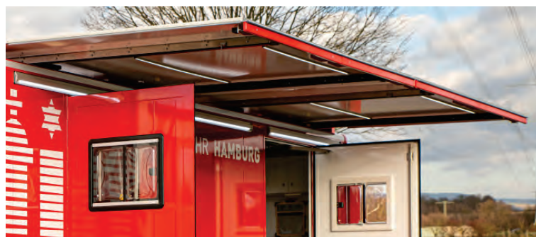
Abbildung 72: Elektrisches MEINDL-Schiebedach mit Beleuchtung, zweigeteilt.
