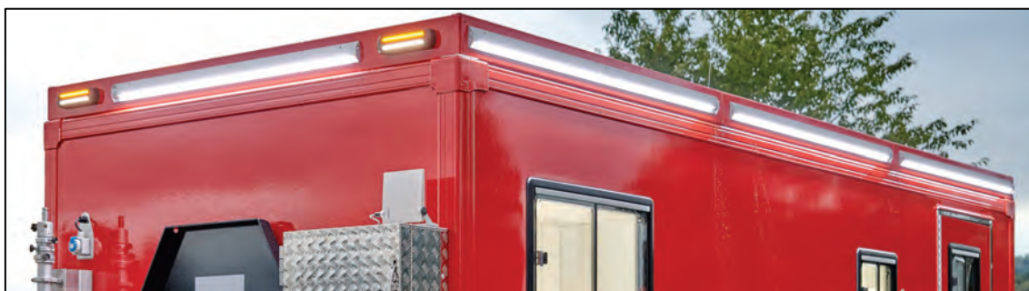
Abbildung 54: Dachgalerie umlaufend (hier mit Umfeld- und Positionsbeleuchtung).
