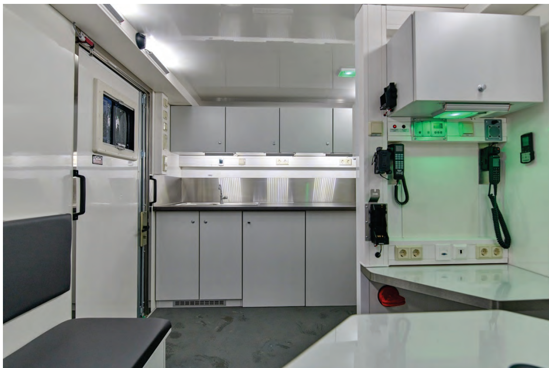
Abbildung 18: Detail – Innenansicht mit Küchenzeile und abgesetztem Funk-Arbeitsplatz.
