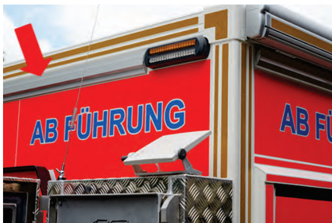
Abbildung 43: LED-Lichtstreifenelement Fabr. LDR, vorn und seitlich.
