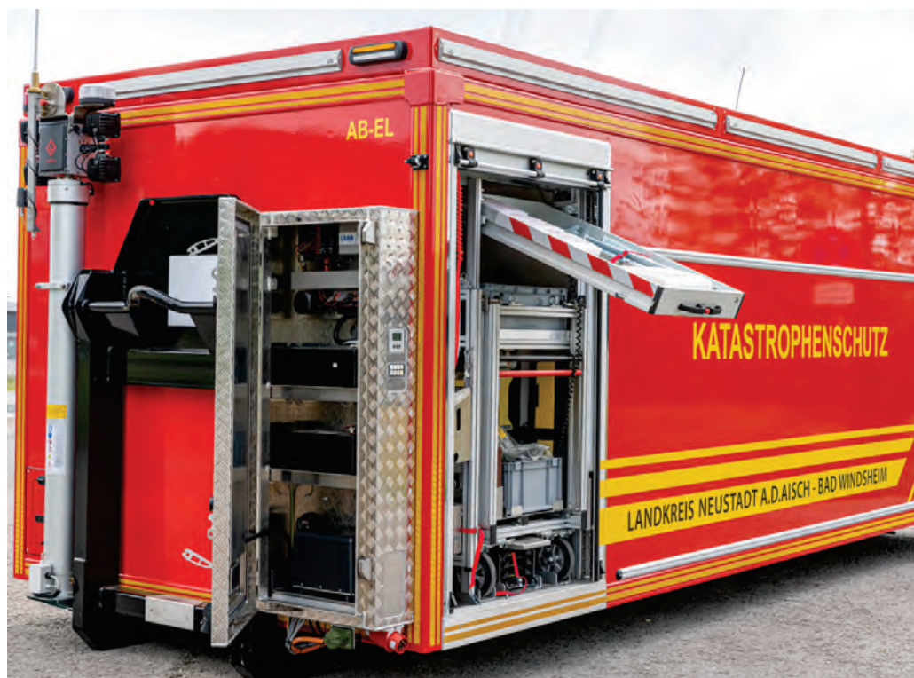
Abbildung 32: Detail – Zentraler Stirn-Schalterschrank, Geräteraumverschluss als Rollladen, Rollwagenentnahme mit anlegbaren Rampen, Schublade, Umfeldbeleuchtung.
