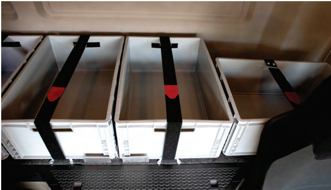
Abbildung 37: Detail – Ablage hinter den Sitzen mit Halterungen für Euroboxen.
