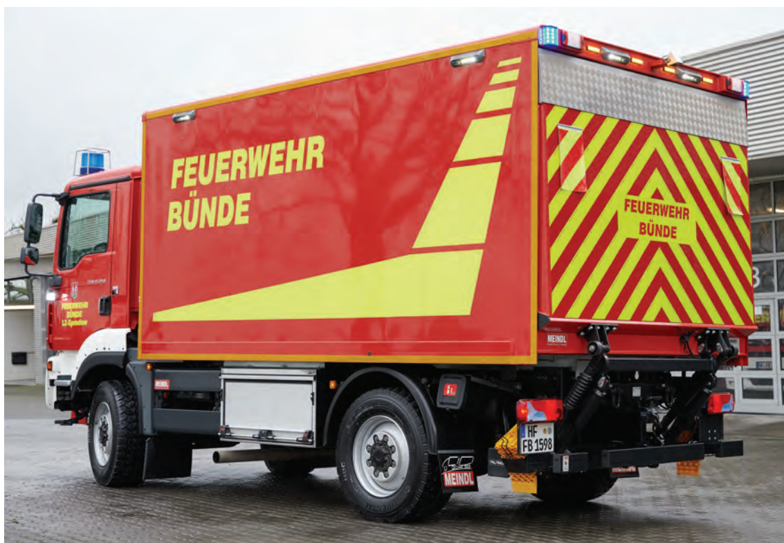
Abbildung 15: Detail – Heckportal „normalhoch“, Edelstahl-Staukasten mit Aluminium-Rollladen.
