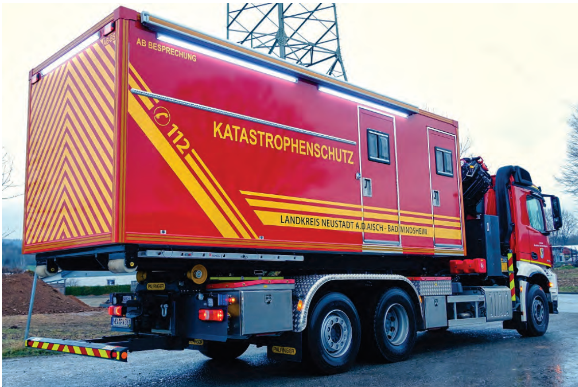
Abbildung 3: AB Besprechung mit Umfeldbeleuchtung und seitlich aufgesetzter Markise.
