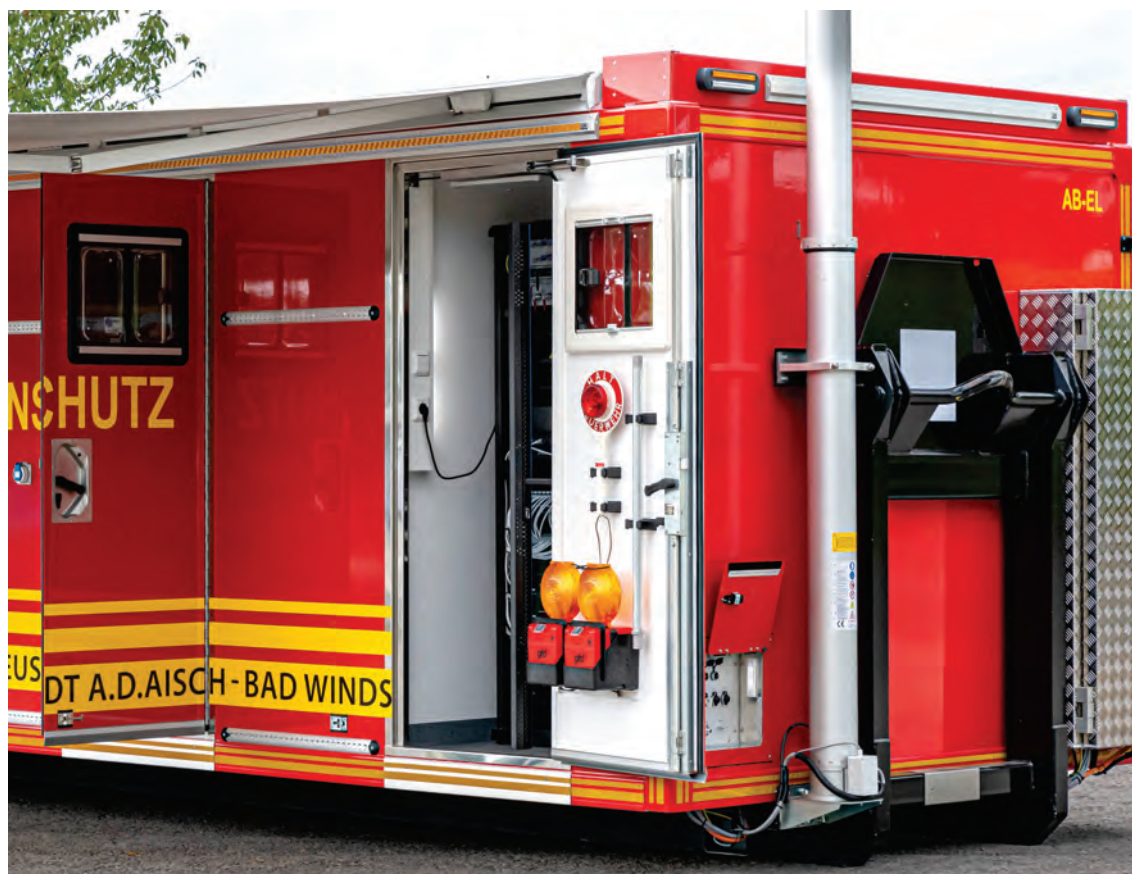
Abbildung 6: Detail – Serverraum, Übergabeklappe, kombinierter Funk- / Lichtmast.
