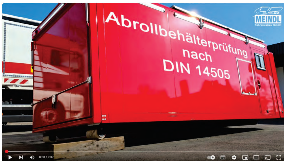
Abbildung 24: 19112555 Abrollbehälter AB Atemschutz. Behälterprüfung nach DIN 14505. Nach DIN 14505 gilt für Abrollbehälter mit Kofferaufbauten, dass der AB u.a. folgenden Verschränkungsbelastungen standhalten muss: vorn einseitig unter jedem Langträger 100 mm, hinten einseitig unter jeder Rolle 200 mm. Türen, Rollläden, Klappen und bewegliche Einbauten (z.B. Schübe) müssen sich einwandfrei betätigen lassen. Bleibende Verformungen oder sonstige Schäden dürfen nicht auftreten. Merke: Insbesondere durch vollflächige Heckklappen wird die Konstruktion sehr hoch belastet! Diese Prüfung erfolgt von uns in ähnlicher Form auch bei Gerätewagen.
