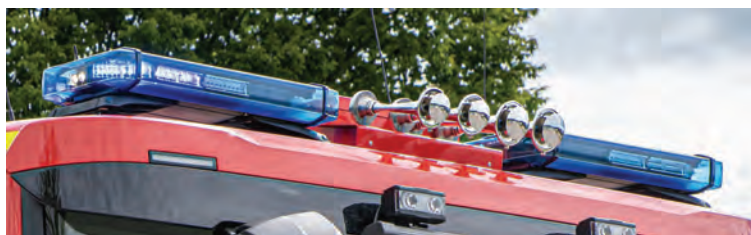
Abbildung 64: Geteilter Warnbalken, Hänsch DBS 850 LED mit Zusatz-Blitzern.
