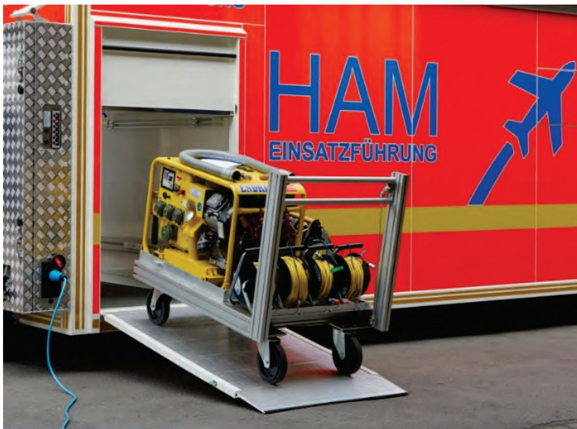
Abbildung 12: Detail – Laderampe des vorderen Geräteraumes, MEINDL-Rollcontainer.
