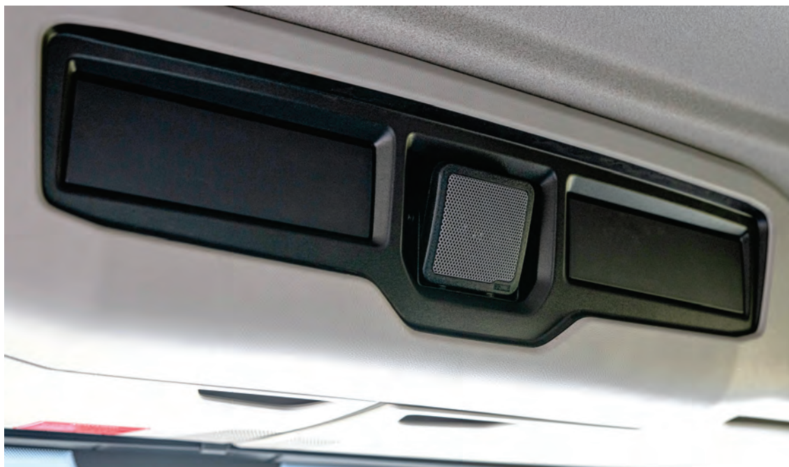
Abbildung 30: Detail – Zusatzfunklautsprecher in die Fahrzeugdachverkleidung integriert.
