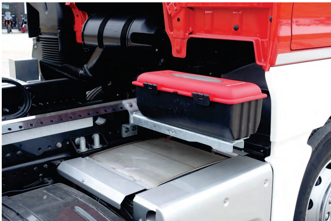
Abbildung 42: Detail – Verzinkte MEINDL-Schraub-Anbauhalterung (hier für Feuerlöscher). Ermöglicht flexible Positionierung.
