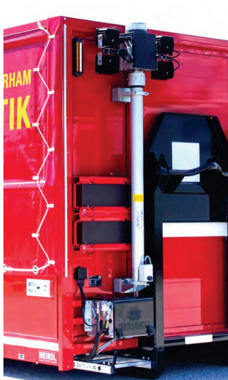
Abbildung 45: Lichtmast (hier zusätzlich mit LED-Blitzleuchte, grün). Ausführung mit Elektro-Drucklufizerzeuger. Fernsteuerung für den Lichtmast.
