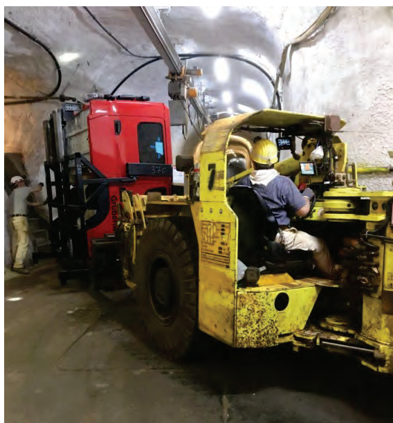
Abbildung 8: Baugruppen des Fahrzeuges in Segmenten unter Tage transportiert.
