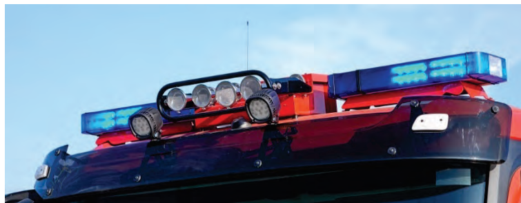
Abbildung 82: LED-Arbeitsstellenscheinwerfer vorne oben am Fahrerhaus.
