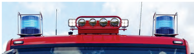
Abbildung 63: RKL rund, Hänsch NOVA LED, hier mit optionalem Astschutz.
