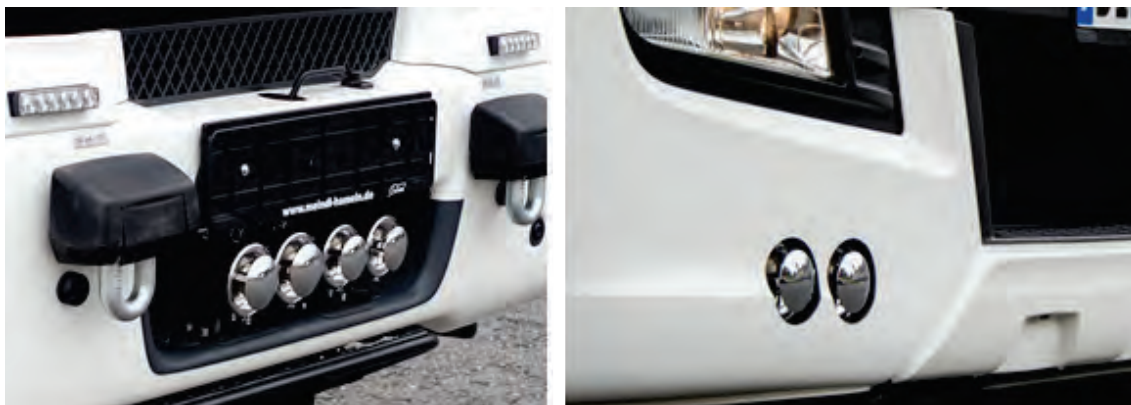
Abbildung 73: MARTIN-HORN®-Schallbecher in der Frontstoßstange integriert. Unterschiedliche Anordnungen je nach Fahrzeugtyp.
