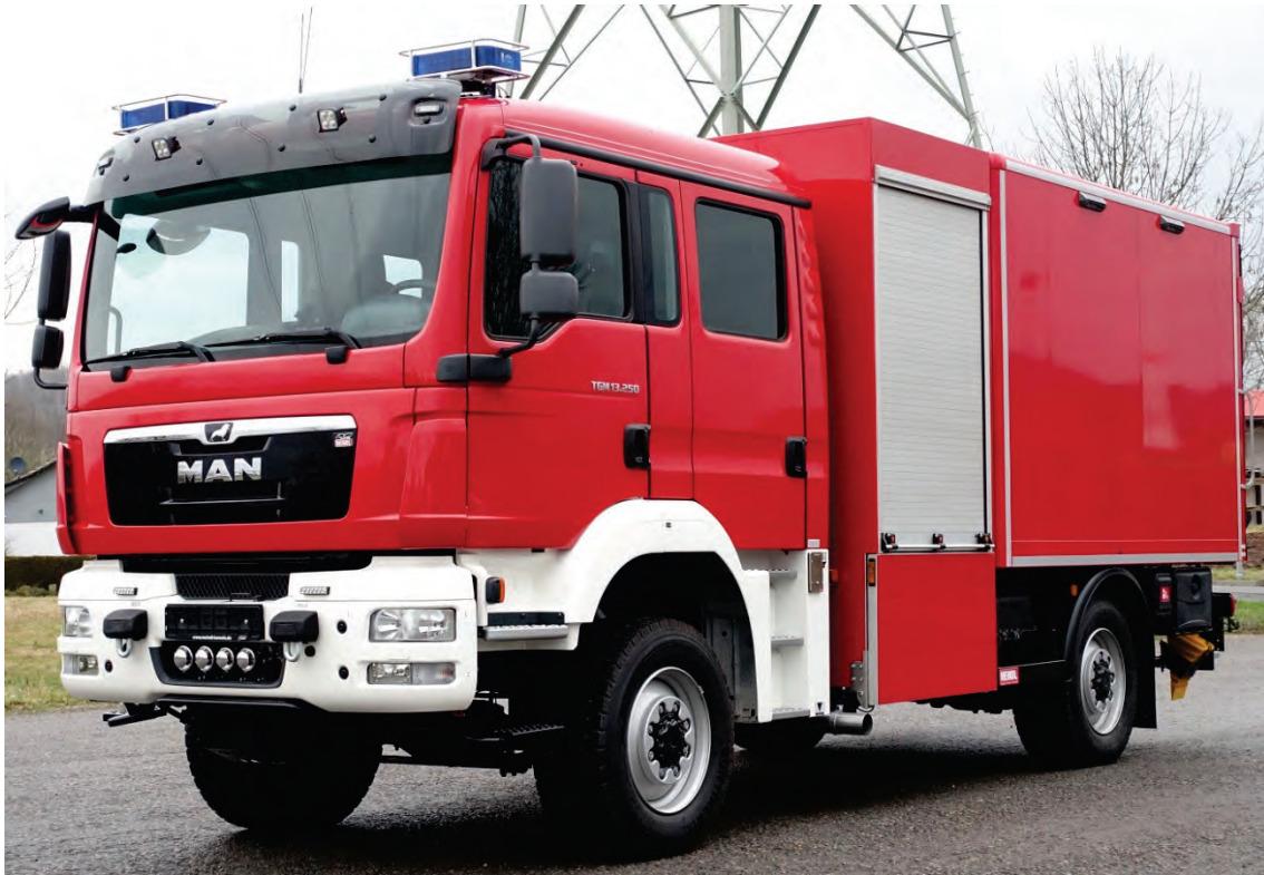
Abbildung 26: GW-L2 auf MAN TGM 4x4-Fahrgestell mit Staffekabine. Ausführung Kofferaufbau (hier FerroFoam®-Bauweise), tiefgezogener separater Geräteraum für höchste Geländetauglichkeit.
