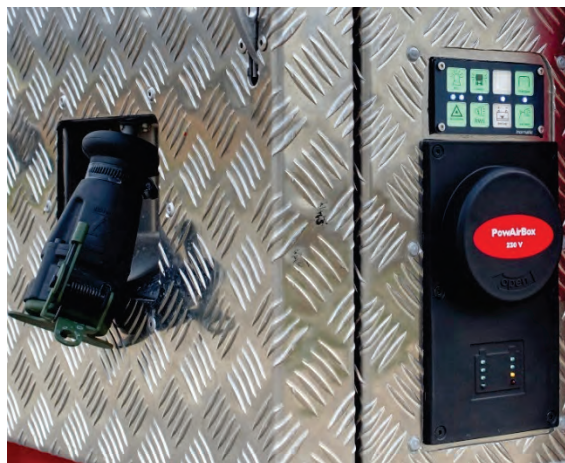
Abbildung 34: Stromeinspeisung PowAirBox, alternatives Bedienteil inomatic®.
