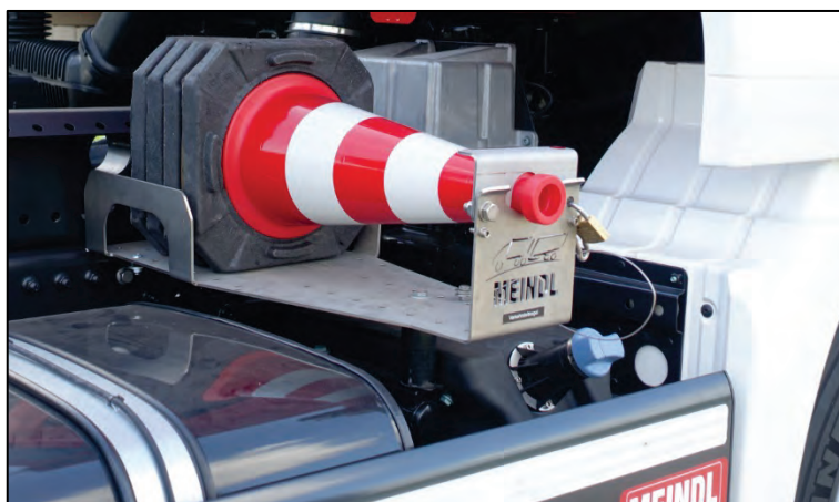
Abbildung 79: Leitkegelhalterung, flexibel am Fahrzeug positionierbar.
