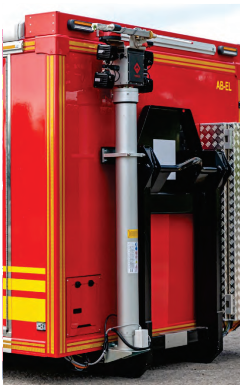
Abbildung 55: Antennenmast (hier zusätzlich mit LED-Blitzleuchten, rot und grün). Ausführung mit Elektro-Druckluft-erzeuger. Fernsteuerung für den Lichtmast.
