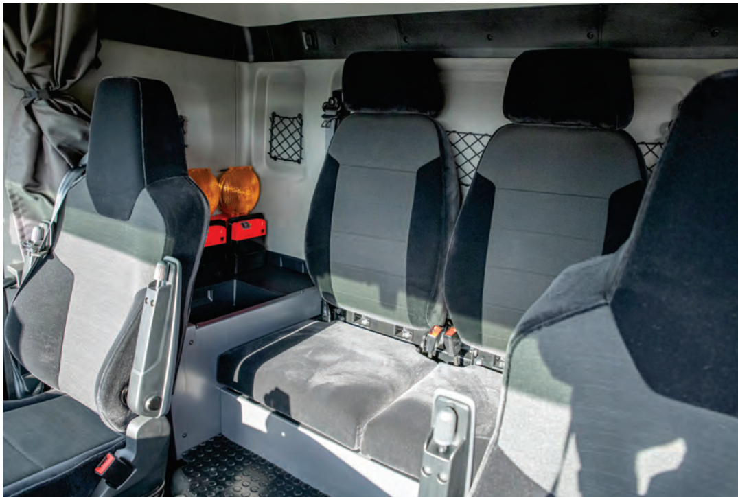
Abbildung 38: Detail – Anordnung Ladesockel für Euro-Blitz, hier im Fahrerhaus mit 4-Personen-Sitzanlage.
