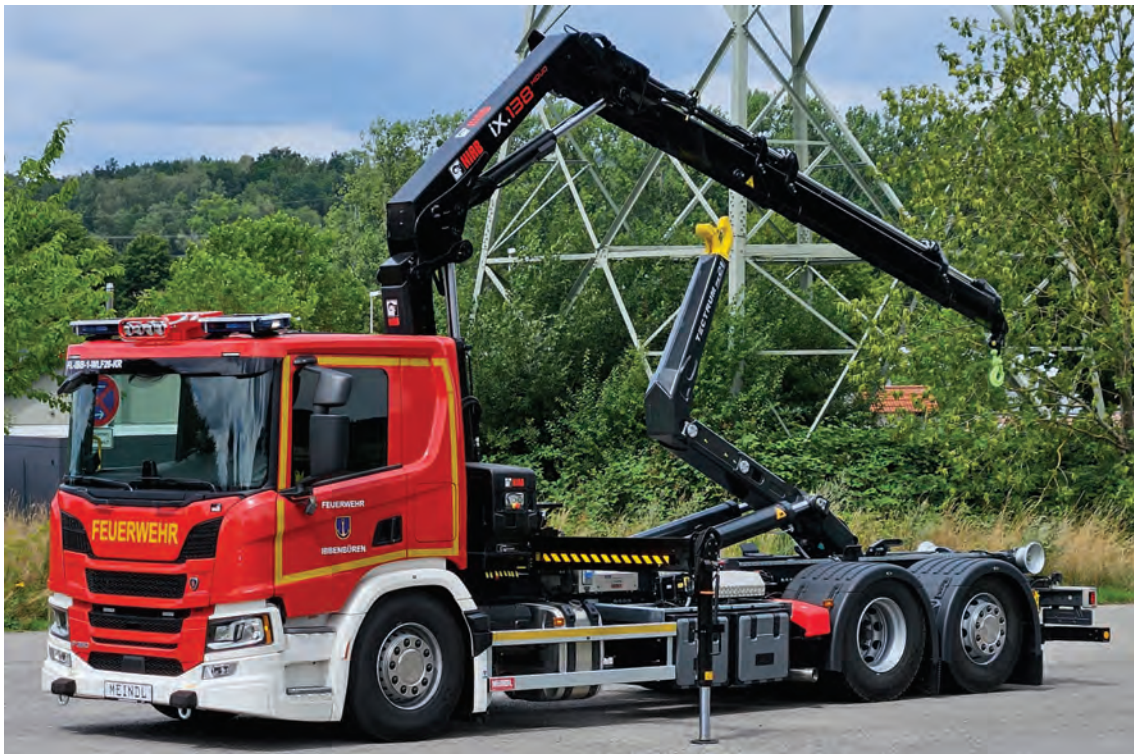
Abbildung 18: WLF 26/6900 auf SCANIA-Fahrgestell, hier mit 14 tm Ladekran.
