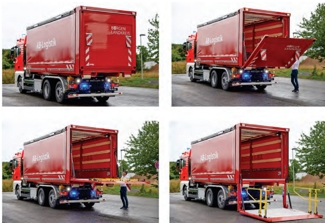
Abbildung 2: Öffnen des Vertikalliftes – Betrieb auf einem WLF 26/6900.
