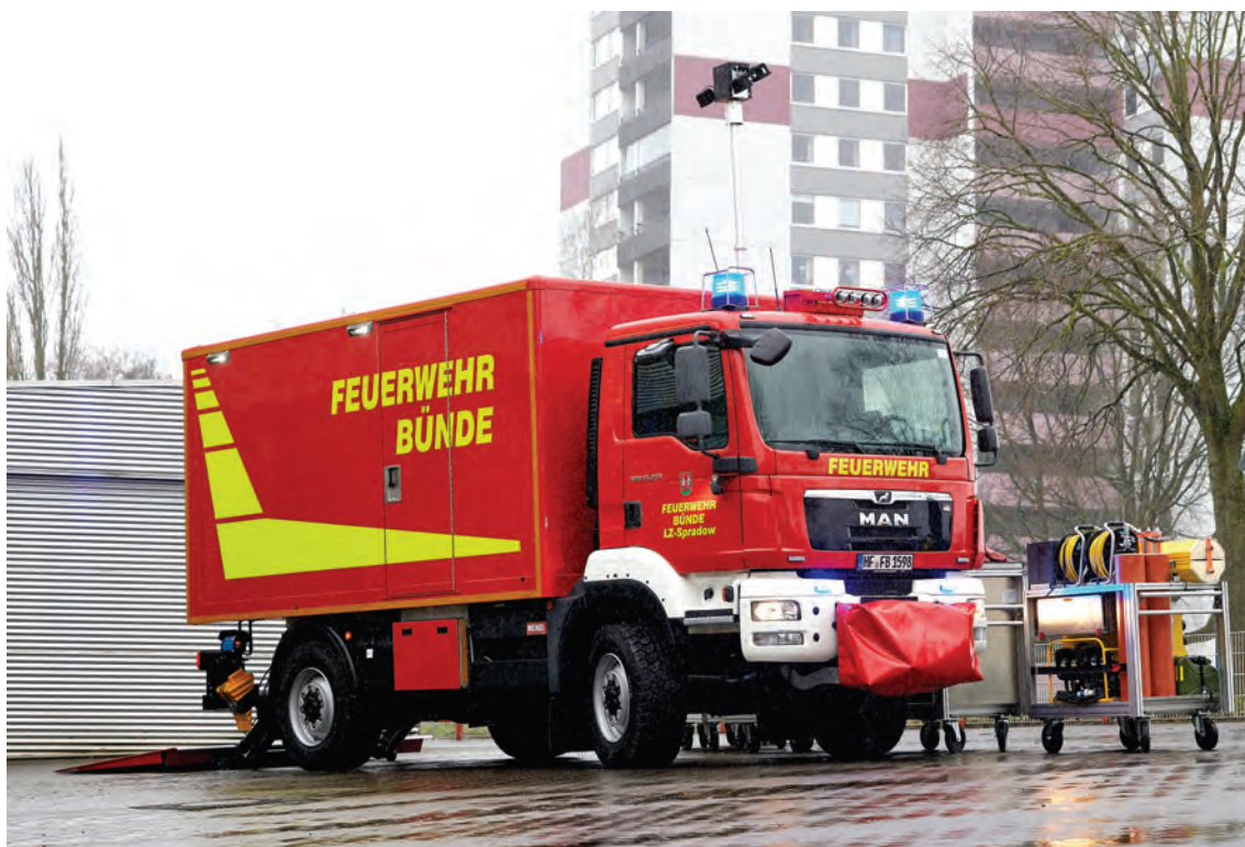
Abbildung 14: GW-L2 auf MAN TGM 4x4-Fahrgestell. Sonderausführung Kofferaufbau (hier in optionaler Aluminium-Bauweise) mit Seitentür, darunter ausziehbarer Klapptritt mit Podest. Elektrische MAXWALD-Vorbauseilwinde 24 V, 50 kN Zugleistung, Hänsch NOVA LED, MARTIN-HORN®-Anlage im MEINDL-Dachkasten, Labcraft Scenelite S16-Umfeldbeleuchtung. Zwischen Fahrerhaus und Aufbau integrierter Lichtmast.
