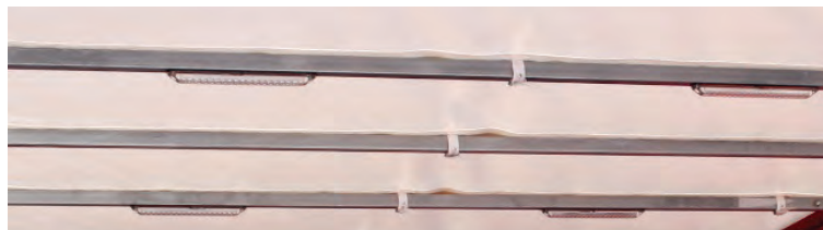
Abbildung 40: LED-Laderaumbeleuchtung (hier bei Ausführung Planendach).
