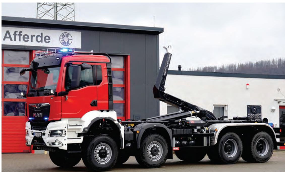
Abbildung 3: WLF 32/6900 auf MAN TGS-Fahrgestell mit Allradantrieb, hier in niedriger Ausführung ohne Hilfsrahmen (möglich durch eine spezielle Anordnung und Sonderausführung der Wechselladeranlage).
