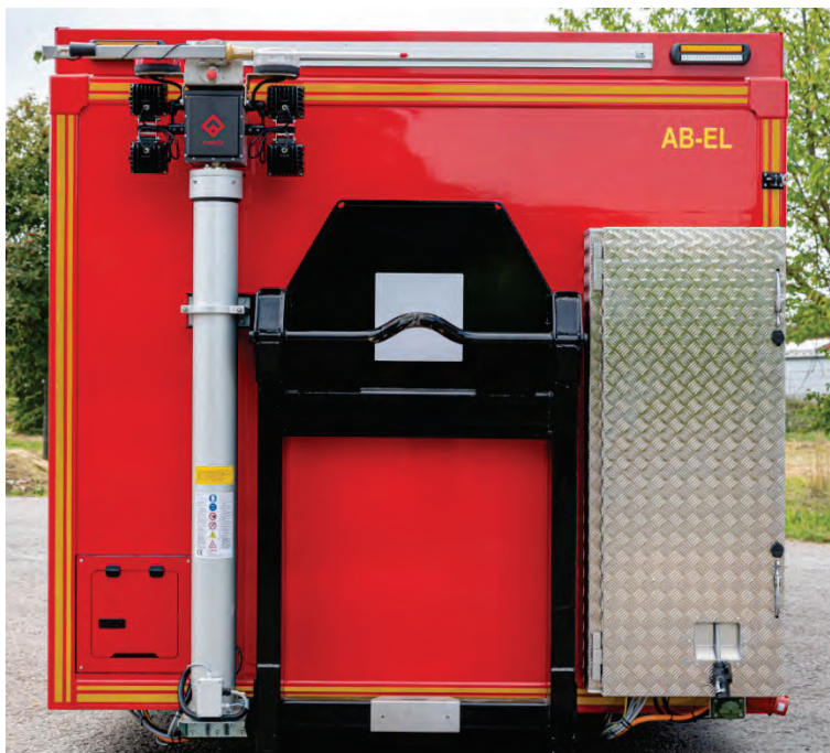
Abbildung 45: Entkoppelter Aufnahmebügel mit großflächigem Anstoßschutz.
