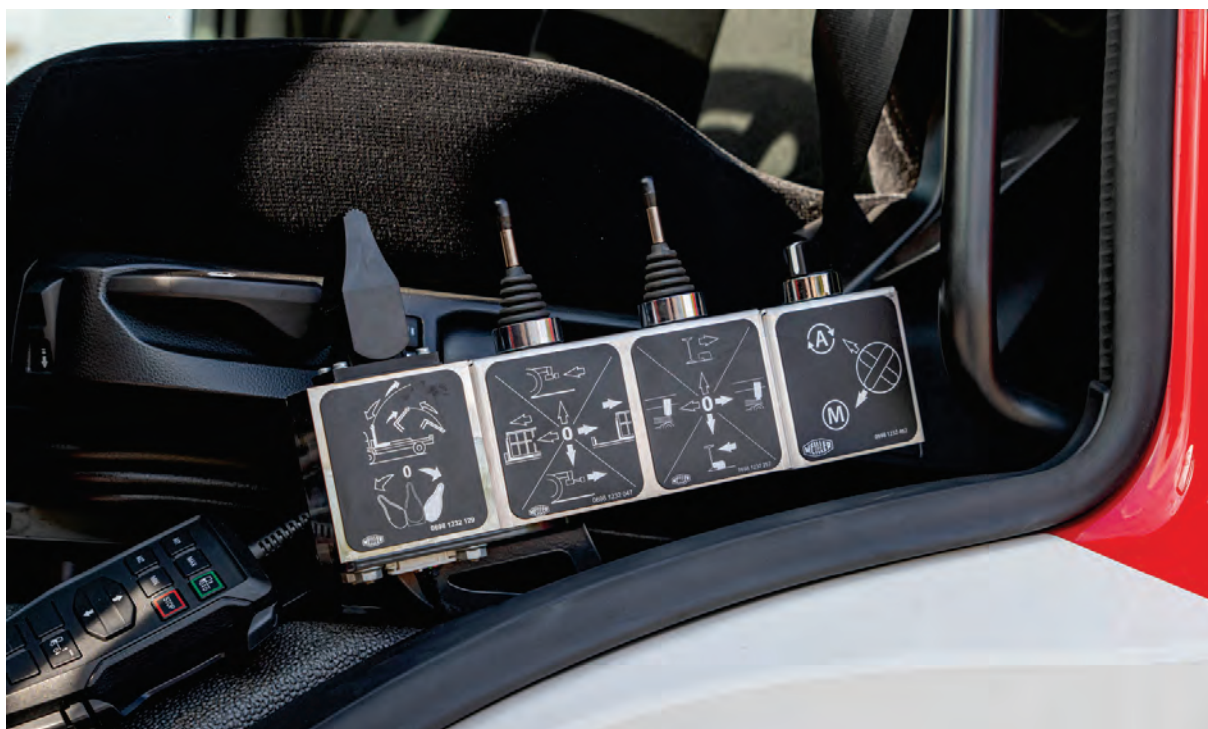
Abbildung 24: Detail – Bedienteil der Wechsellader-Anlage fest neben dem Fahrersitz eingebaut (hier MEILLER-Wechsellader-Anlage mit den Zusatzfunktionen Achsabstützung, hydraulische Innenverriegelung und dem Wahlschalter für den Automatik-Modus. Im Automatik-Modus muss lediglich der erste Wählhebel bedient werden, alle folgenden Funktionen werden der richtigen Abfolge entsprechend automatisch angesteuert. Lediglich der Unterfahrschutz muss aufgrund gesetzlicher Vorschriften nach dem Aufnehmen eines Behälters separat ausgefahren werden).
