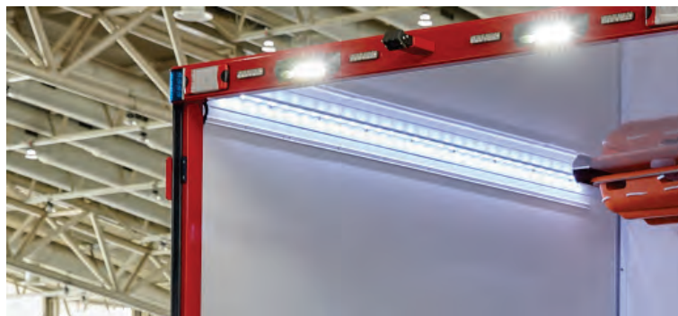
Abbildung 42: LED-Laderaumbeleuchtung (hier bei Ausführung Kofferaufbau).
