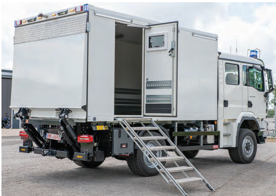
Abbildung 21: Detail – Optionale Seitentür mit unkaputtbarem MEINDL-Türfeststeller 90/180° sowie mit quer ausziehbarer Aufstiegstreppe mit oberem Podest. Diese Treppenbauform kann mit einem automatisch aufklappenden Geländer kombiniert werden und ermöglicht einen komfortablen Aufstieg. Der Nachteil dieser Lösung gegenüber einem Klapptritt ist, dass sich durch die quer eingeschobene Treppe die Unterbauhöhe um ca. 50 mm erhöht! Heckportal „normalhoch“.
