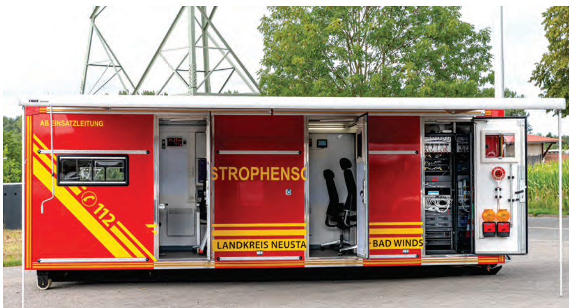
Abbildung 2: AB ELW 2 mit 3 seitlichen Türen (vorne rechts der Serverraum). Die Räume sind durch unabhängige Klimaanlagen klimatisiert.
