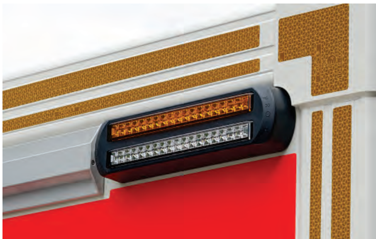
Abbildung 31: Die Positions- und Blinkleuchten sind separat schaltbar.
