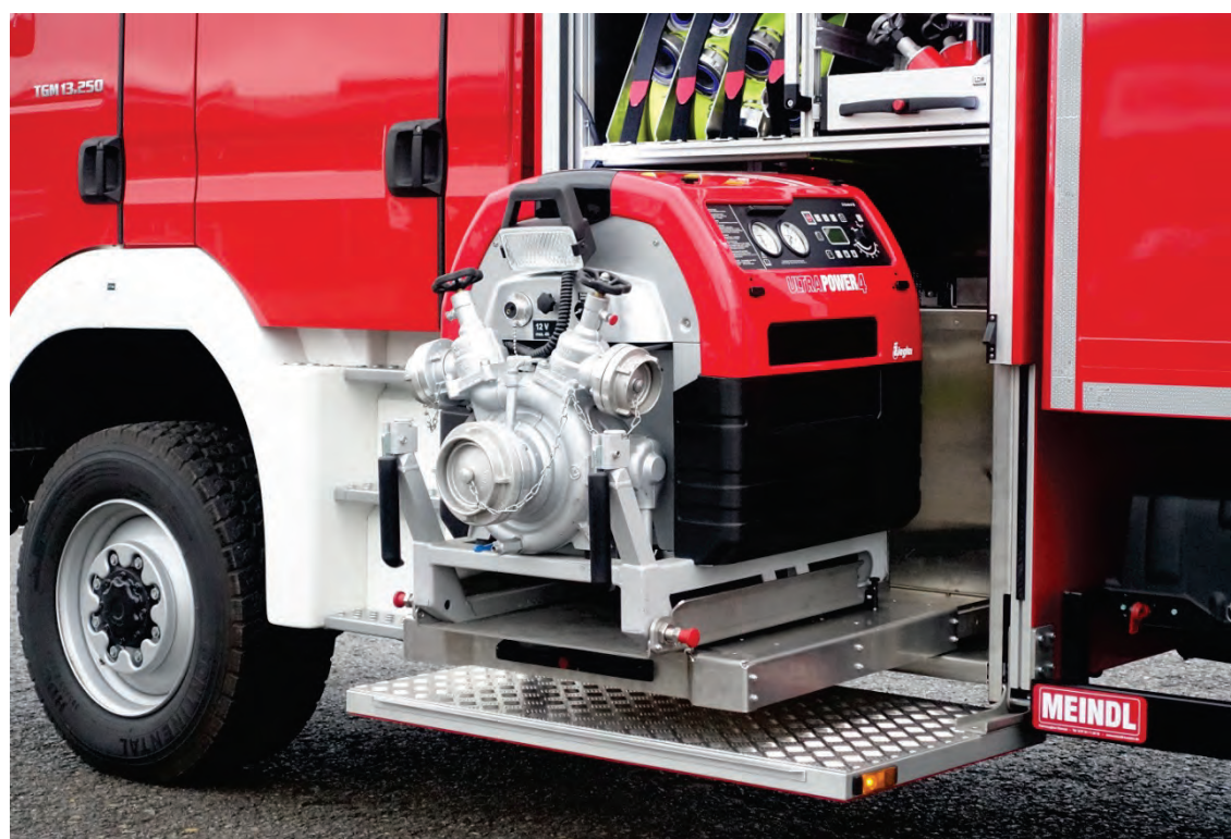
Abbildung 32: Detail – Tragkraftspritze auf MEINDL-Schwerlast-Schwenk-Auszug, „unsichtbar“ angeordnete Gasdruckfedern der seitlichen Zugangsklappen. Die Gasdruckfedern sind stehend zusammen mit den berührungslosen Sensoren der Zugangsklappen in einem kompakten Gehäuse integriert. Dadurch sind die Gasdruckfedern und Sensoren vor Beschädigung und Verschmutzung geschützt.
