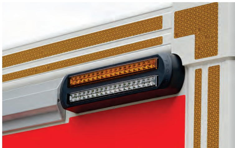
Abbildung 30: Die Positions- und Blinkleuchten sind separat schaltbar.
