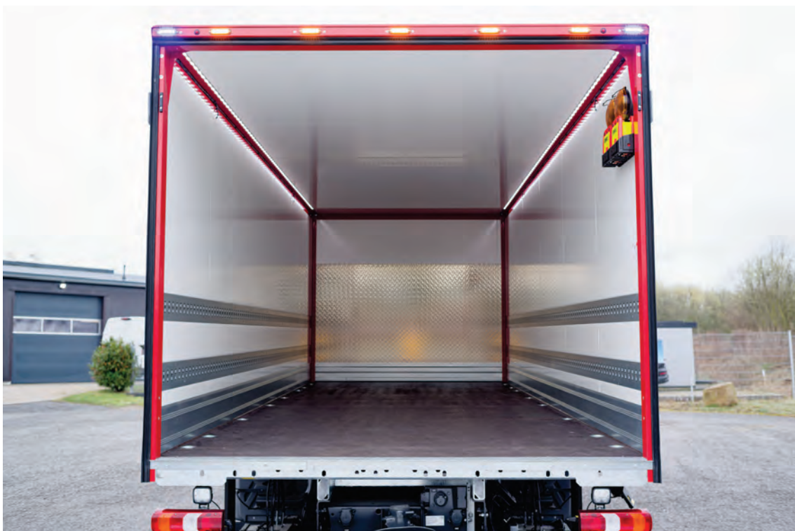
Abbildung 17: Detail – Heckportal in niedriger Ausführung – für eine maximal große Durchgangshöhe. Unser neues spezielles Heckportal ermöglicht eine größere lichte Durchgangshöhe als klappbare Heckkonsolen! Innenbeleuchtung durch zwei durchgehende LED-Lichtbahnen. Unterbau verzinkt.
