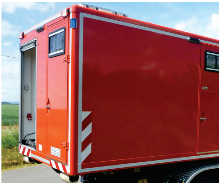
Abbildung 61: Kontur- und DIN-Warnmarkierung.
