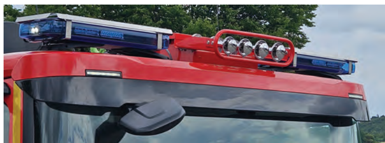
Abbildung 66: Astschutz, Edelstahl (Schraubversion) für Hänsch DBS 850 LED.
