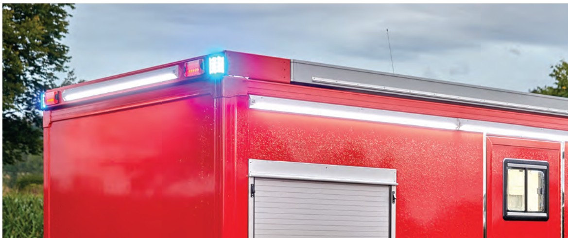
Abbildung 41: Heckleuchtenkonsole (hier in der Dachgalerie integriert), mit Umfeldbeleuchtung über die volle Breite.
