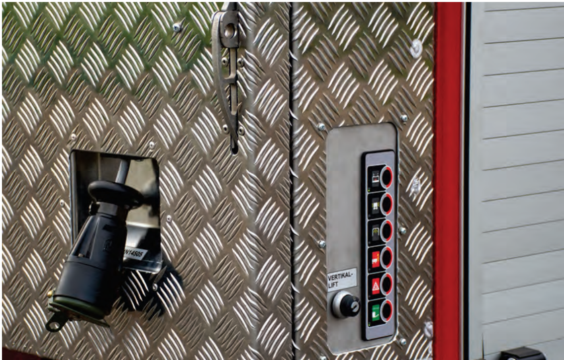
Abbildung 16: Detail – Komfortabler Patentauszug (1.500 mm Auszuglänge) für die Stromversorgung zum Fahrzeug nach DIN. Keine losen Kabel und keine Kabelwicklungen. Der Stecker wird selbsttätig mittels Federauszug eingezogen.
