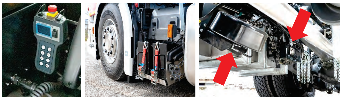
Abbildung 96: Links: Kabelfernsteuerung der ROTZLER TREIBMATIC TR 030. Mitte: Fahrzeugspezifische Halterungen für die Radkeile. Rechts: Platzsparend angeordnete Speichertrommel und Spillwindeneinheit.
