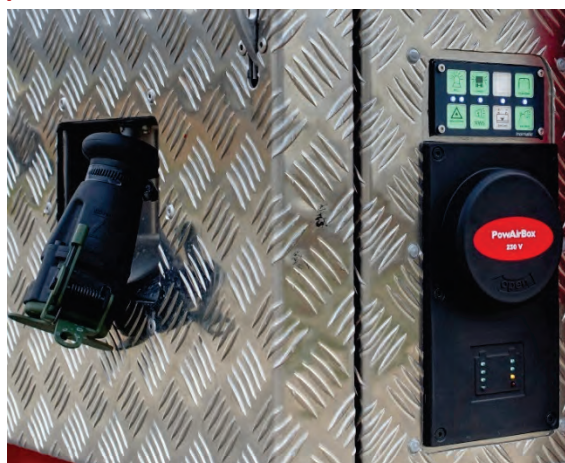
Abbildung 33: Stromeinspeisung PowAirBox, alternatives Bedienteil inomatic®.
