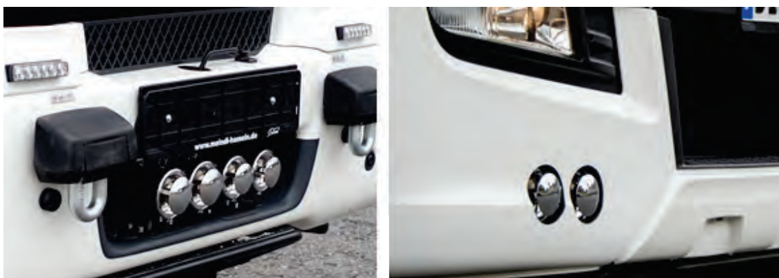
Abbildung 67: MARTIN-HORN®-Schallbecher in der Frontstoßstange integriert. Unterschiedliche Anordnungen je nach Fahrzeugtyp.
