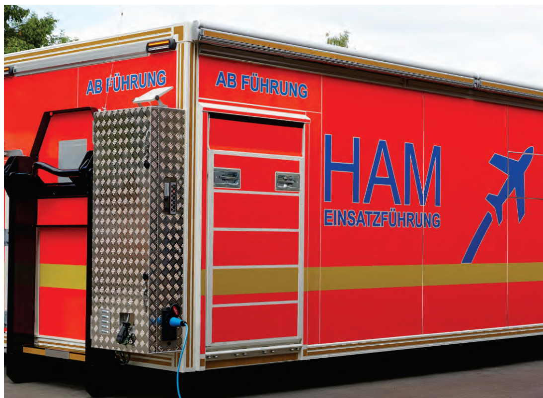
Abbildung 22: Detail – Zentraler Stirn-Schaltschrank, Geräteraumverschluss als Rampe, Umfeldbeleuchtung, Markise.
