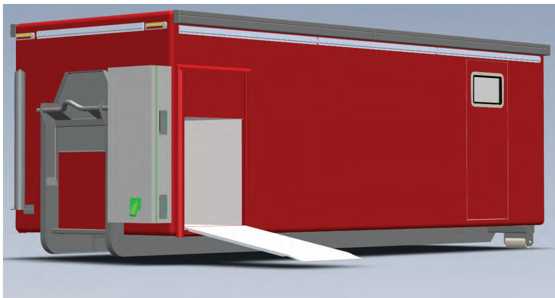
Abbildung 9: AB Führung in der Konstruktionsphase (hier als 3D-Modell).
