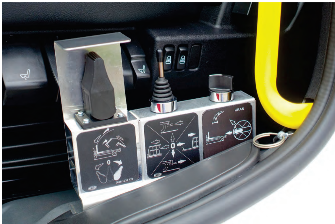
Abbildung 23: Detail – Bedienteil der Wechsellader-Anlage mit Schutz, fest neben dem Fahrersitz eingebaut (hier MEILLER-Wechsellader-Anlage mit zusätzlichem Umschalter für Ladekran).
