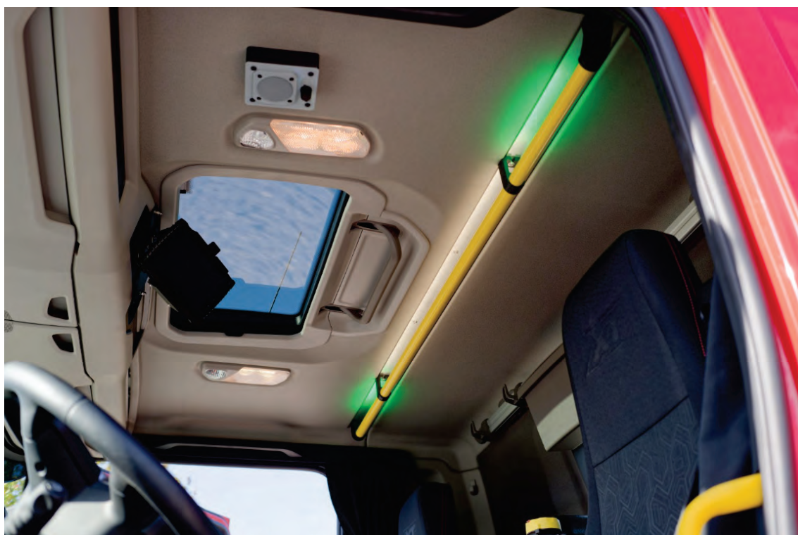
Abbildung 26: Detail – Horizontale Griffstange mit umschaltbarer Weiß- / Grün-Beleuchtung.
