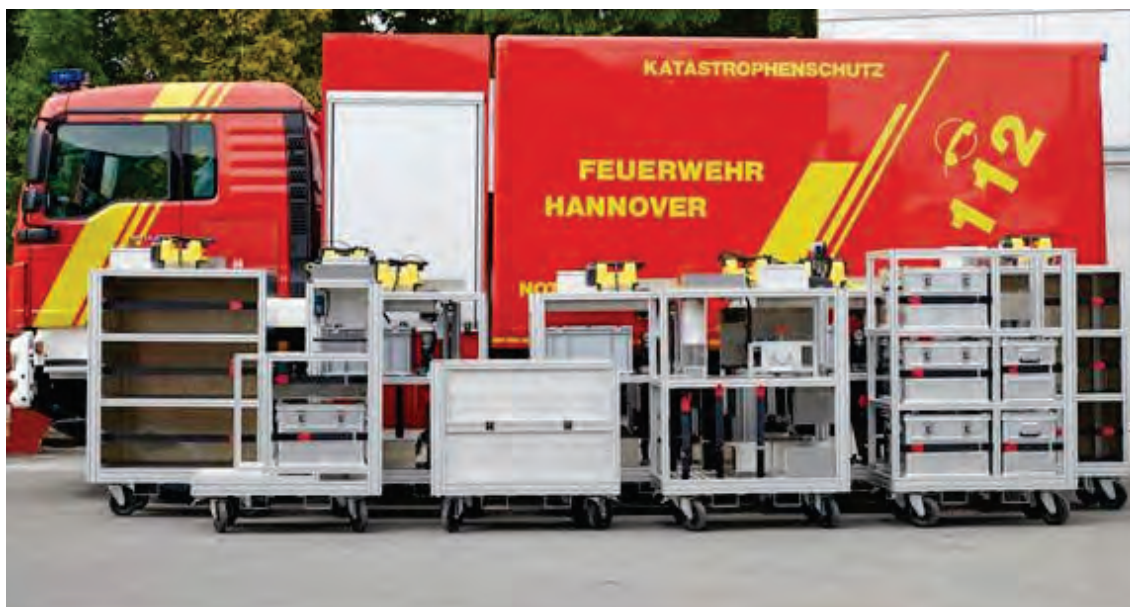
Abbildung 5: Im GW-L2 verlastete MEINDL-Rollcontainer. Durch komplette Zeichnungen inklusive Halterungen für die Beladung können Rollcontainer 1:1 nachbestellt werden. Ein Anpassen an die Beladung ist dabei nicht erforderlich.
