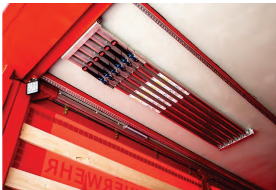
Abbildung 57: Teleskopsperrstangen mit Depot im Dachbereich.
