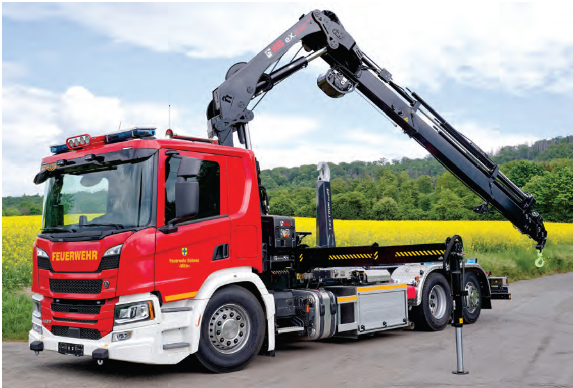
Abbildung 17: WLF 26/6900 auf SCANIA-Fahrgestell, hier mit 23 tm Ladekran.
