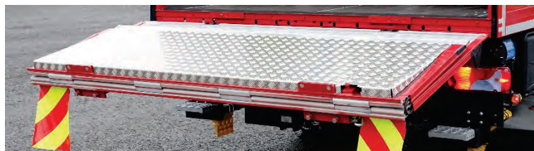
Abbildung 53: Plattform geteilt, hier mit optionalem Verschleißschutz.
