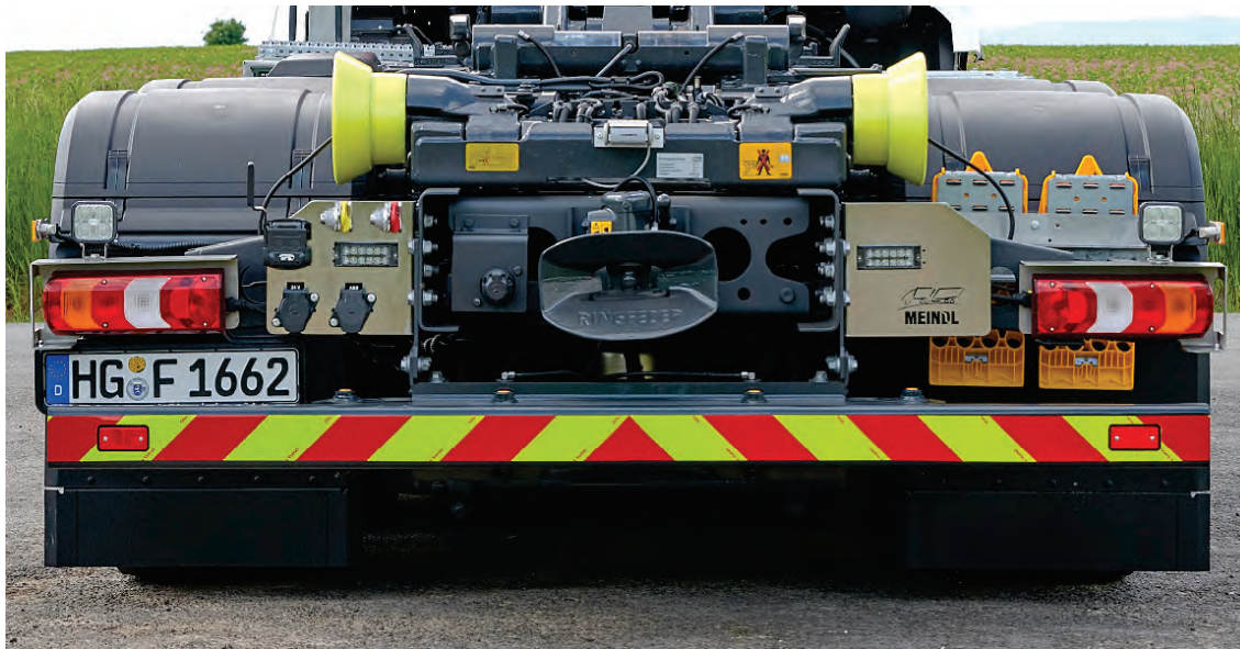
Abbildung 97: Fahrzeugmarkierung (hier Heckmarkierung gelb, schraffiert).
