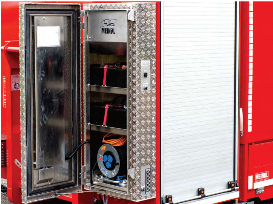
Abbildung 13: Detail – Zentraler Stirn-Schaltschrank, sehr hochwertige Ausführung mit 2 Verschlüssen und groß dimensionierter Gummidichtung. Der MEINDL-Schaltschrank ist von uns speziell für diesen Einsatzzweck konstruiert!
