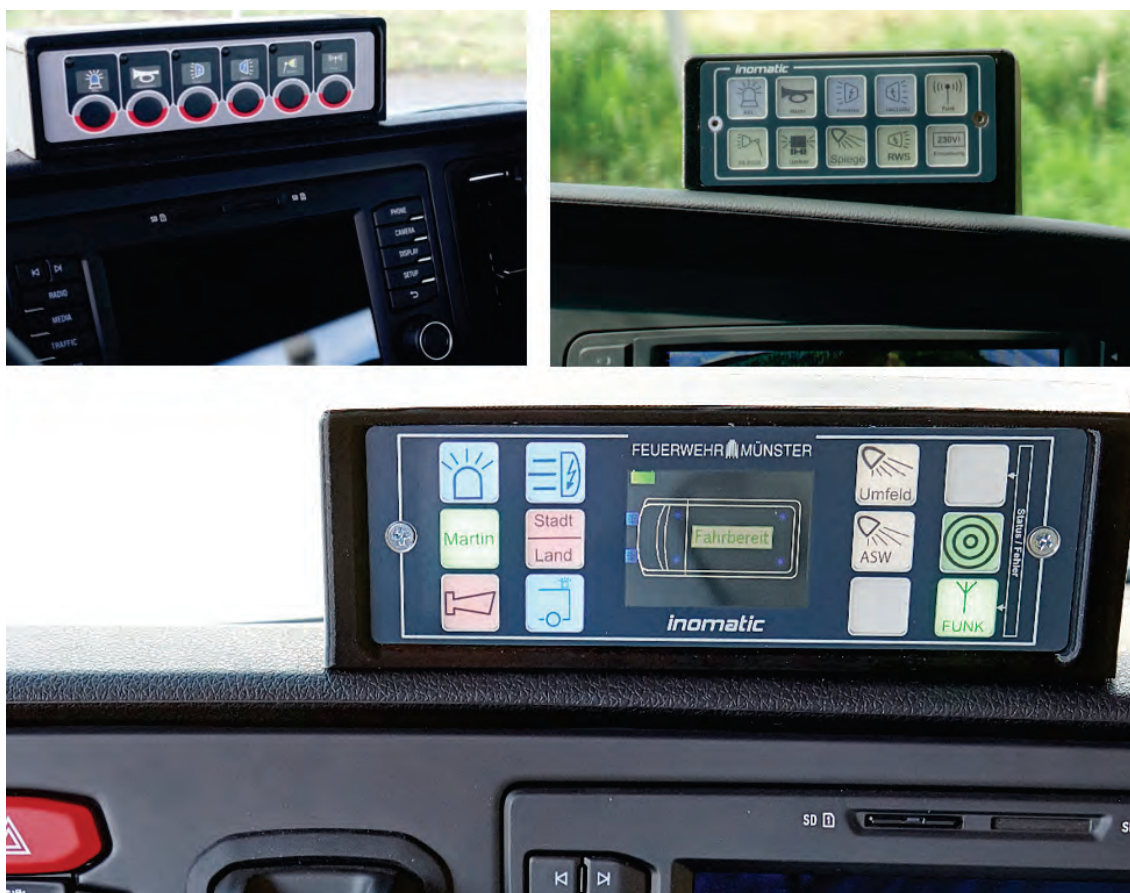
Abbildung 48: Detail – Verschiedene Bedienteile in fahrzeugspezifischen MEINDL-Halterungen auf dem Armaturenbrett aufgesetzt montiert.
