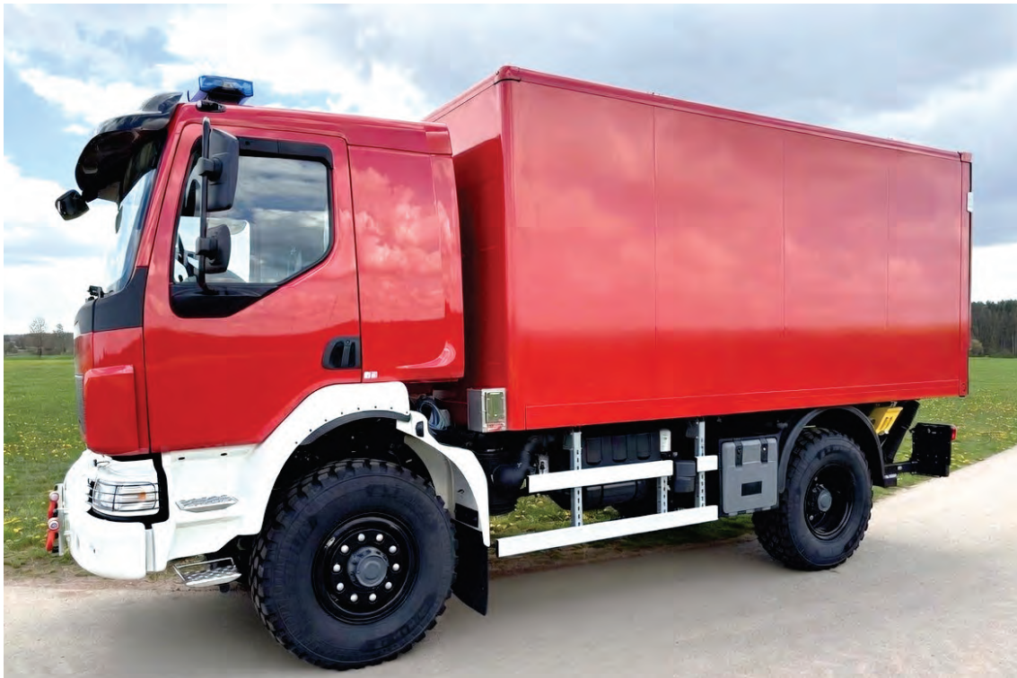
Abbildung 18: GW-L2 auf VOLVO FL 4x4-Fahrgestell, Ausführung Kofferaufbau (hier FerroFoam®-Bauweise).
