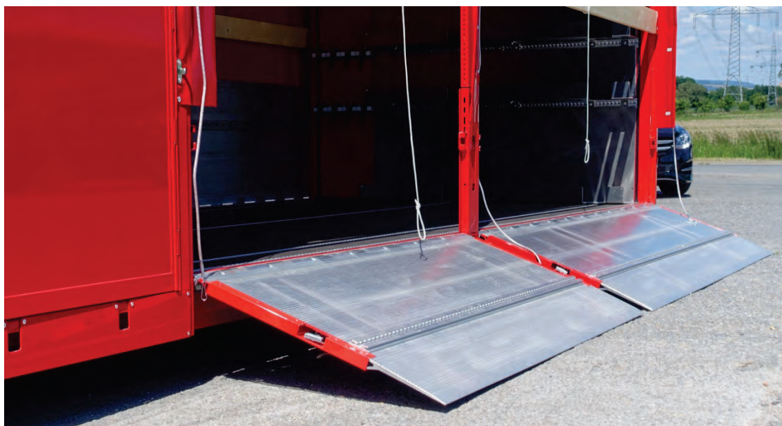
Abbildung 10: Detail – Seitlich überfahrbare Rampen zur Schnellentnahme von Rollcontainern beim abgesetztem AB.
