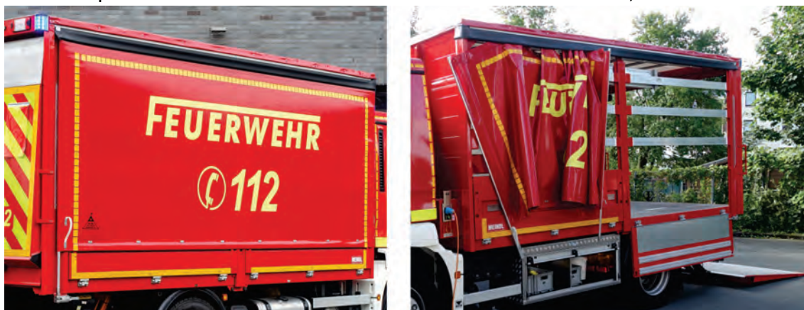
Abbildung 44: Seitenschiebepane geschlossen / geöffnet.
