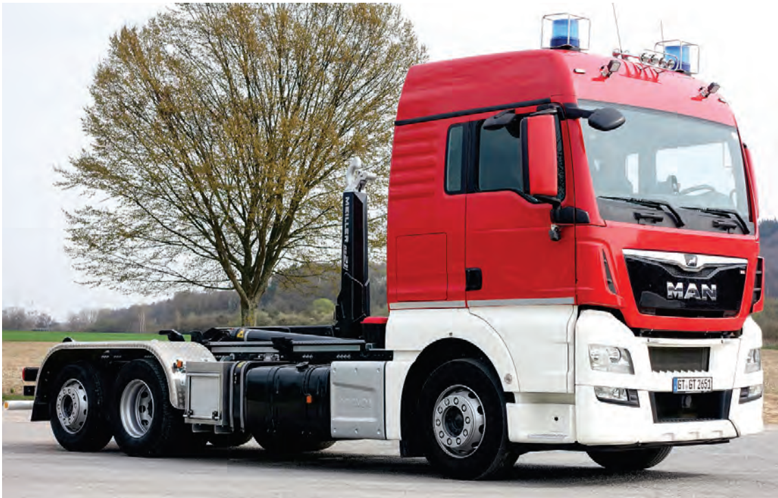
Abbildung 7: WLF 26/6900 auf MAN TGX-Fahrgestell (hier MEINDL-Konzept: Neues WLF auf gebrauchtem Fahrgestell aus dem Fernverkehr).
