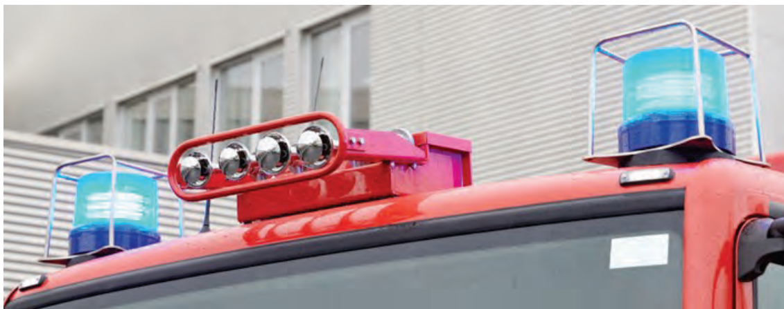
Abbildung 72: MARTIN-HORN® 2298 GM-Anlage auf dem Fahrzeugdach montiert. Kompressor im MEINDL-Dachkasten integriert.
