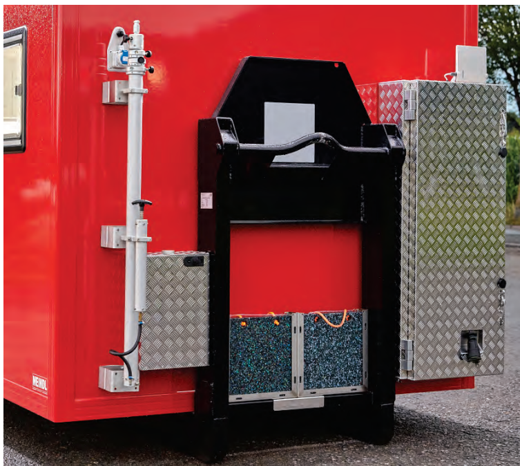
Abbildung 35: Entkoppelter Aufnahmebügel mit großflächigem Anstoßschutz.
