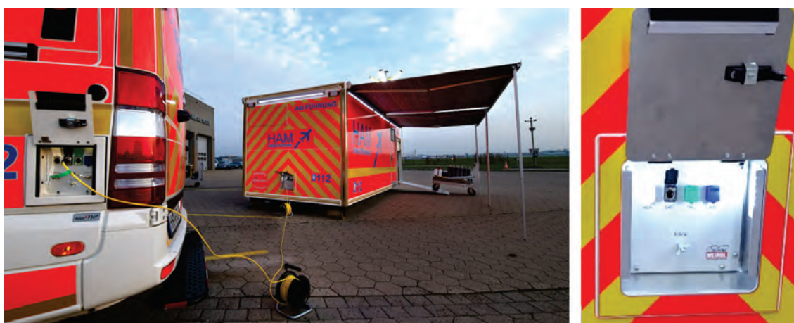
Abbildung 47: Verbindung ELW-1 zu AB Führung, Detail – MEINDL-Übergabeeinheit.
