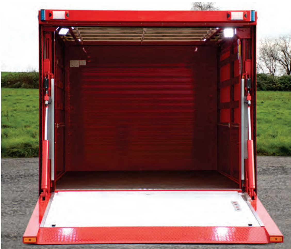
Abbildung 11: Detail – Die Ladefläche ist komplett in ganzer Höhe nutzbar – hier stören keine innen montierten Technikeinbauten wie z.B. das Hydraulikaggregat des Vertikalliftes oder der Kompressor des optionalen Lichtmastes. Diese sind außen montiert!
