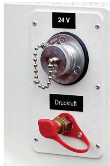
Abbildung 76: Energieeinspeisung 24 V und Druckluft (einfache Ausführung).
