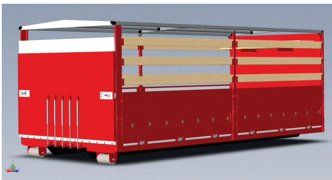
Abbildung 6: AB Transport als geschlossener Pritschenaufbau. 3D-Entwurfszeichnung.
