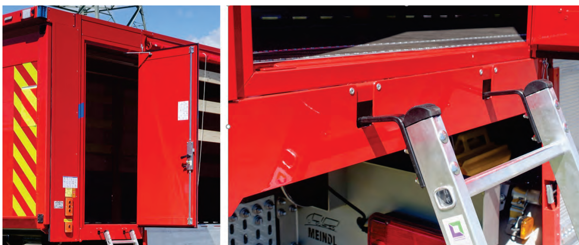
Abbildung 37: Seitentür hinten rechts, einhängbare Auftrittleiter.
