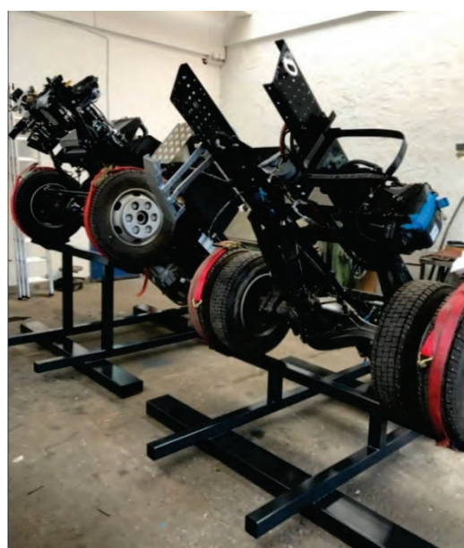
Abbildung 8: Baugruppen des Fahrzeuges in Segmenten unter Tage transportiert.
