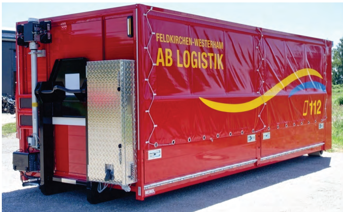
Abbildung 7: Ausführung mit seitlich vertikal geteilter Rollplane und seitlichen Bordwänden als überfahrbare Rampen (dadurch bedingt Bordwandverschlüsse in Spannhakenausführung). Hier: Stirnwand in unverkleideter Ausführung.
