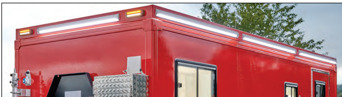
Abbildung 69: Dachgalerie umlaufend (hier mit Umfeld- und Positionsbeleuchtung).
