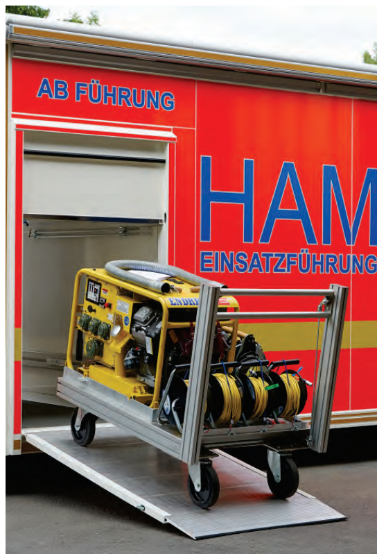
Abbildung 31: Detail – Links im Bild: Silent-Stromerzeuger auf MEINDL-Schwerlastauszug. Rechts im Bild: Alternativ kann der Stromerzeuger auf einem Rollcontainer verlastet werden. Durch eine Verbindungsleitung zum AB führt diese Lösung im Innenraum zu einer deutlichen Geräuschminderung.
