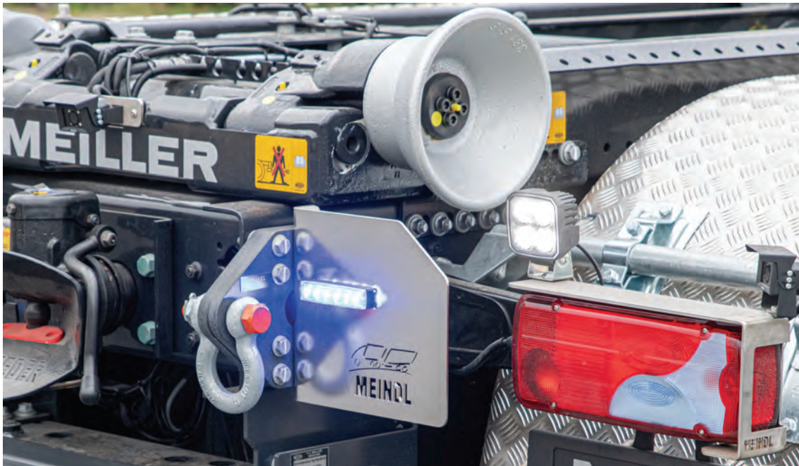
Abbildung 45: Detail – Edelstahlhalterung für die Aufnahme von Heckblitzern und MEINDL-Edelstahl-3D-Heckleuchtenschutz.
