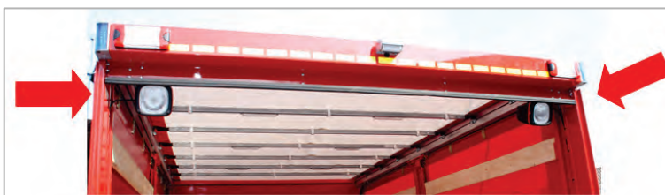
Abbildung 39: LED-Arbeitsstellenscheinwerfer im Heckportal, schwenkbar.
