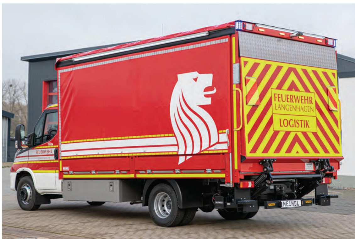
Abbildung 4: Detail – seitliche Schiebeplane mit Spannvorrichtung hinten, Ladebordwand mit optionalem Aluminium-Riffelblech-Verschleißschutz. Rückfahrkamera auf einem Abstandshalter, damit auch das Fahrzeugheck in der Kameraansicht sichtbar ist.
