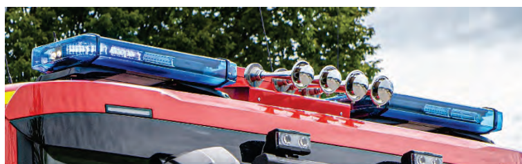
Abbildung 59: Geteilter Warnbalken, Hänsch DBS 850 LED mit Zusatz-Blitzern.
