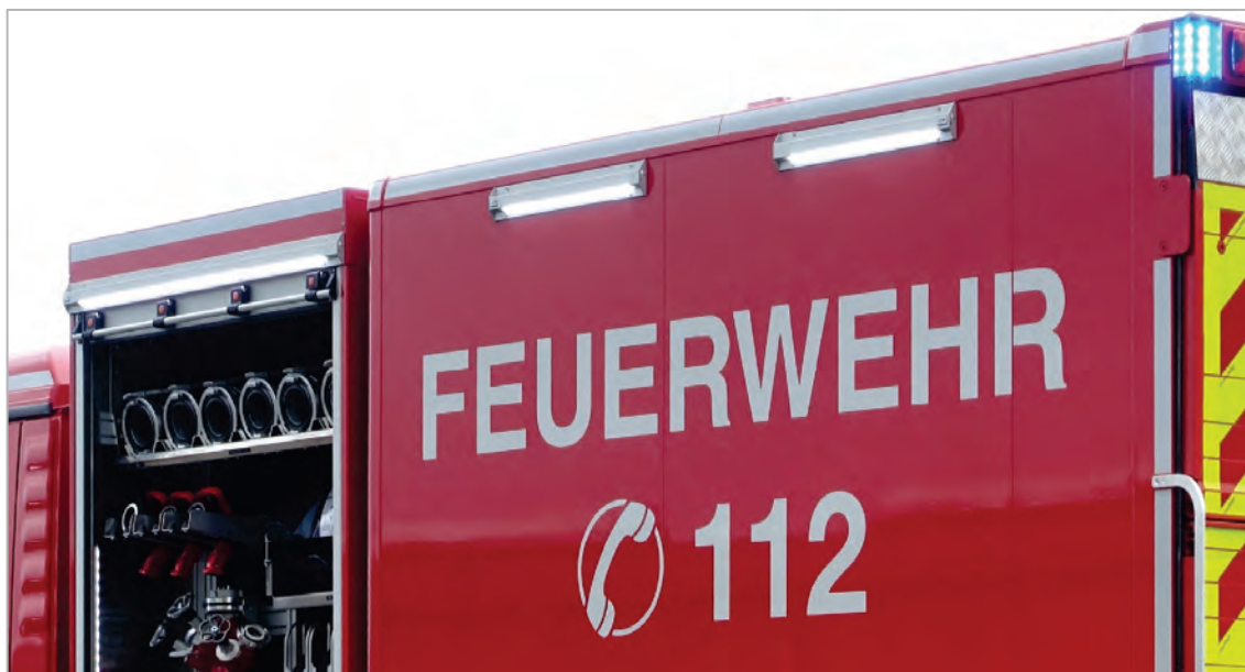
Abbildung 89: LED-Lichtstreifenelemente Fabr. LDR, seitlich.
