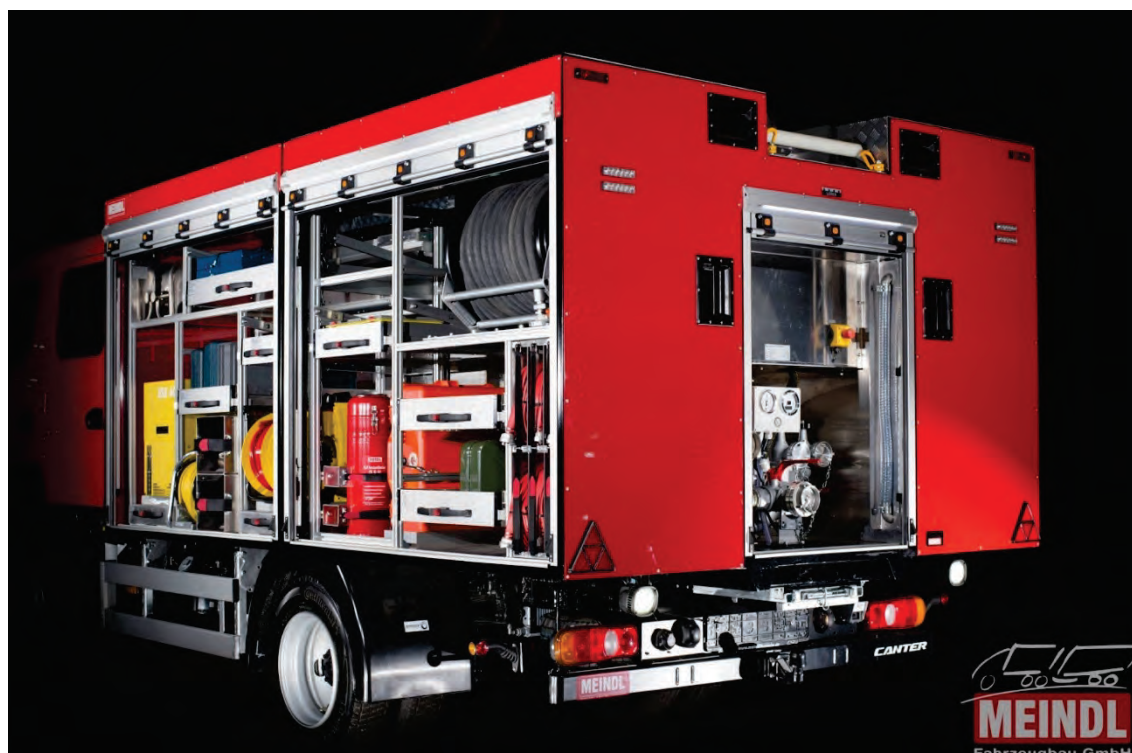
Abbildung 2: Fahrzeuggesamtansicht von hinten. Gut erkennbar – die Unterteilung des Aufbaus in ein vorderes und ein hinteres Segment.
