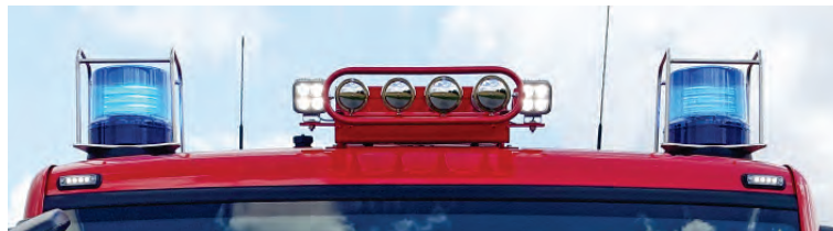
Abbildung 58: RKL rund, Hänsch NOVA LED, hier mit optionalem Astschutz.
