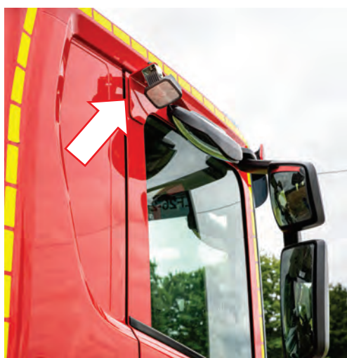
Abbildung 34: Detail – Links: Manövrierscheinwerfer hinten oben an der Tür montiert (bei einigen Fahrzeugen sind an den Spiegelsokeln Abbiegesensoren verbaut, wodurch die Montageposition an den Spiegelhalterungen nicht möglich ist). Rechts: Manövrierscheinwerfer hinter dem Fahrerhaus unten angeordnet.
