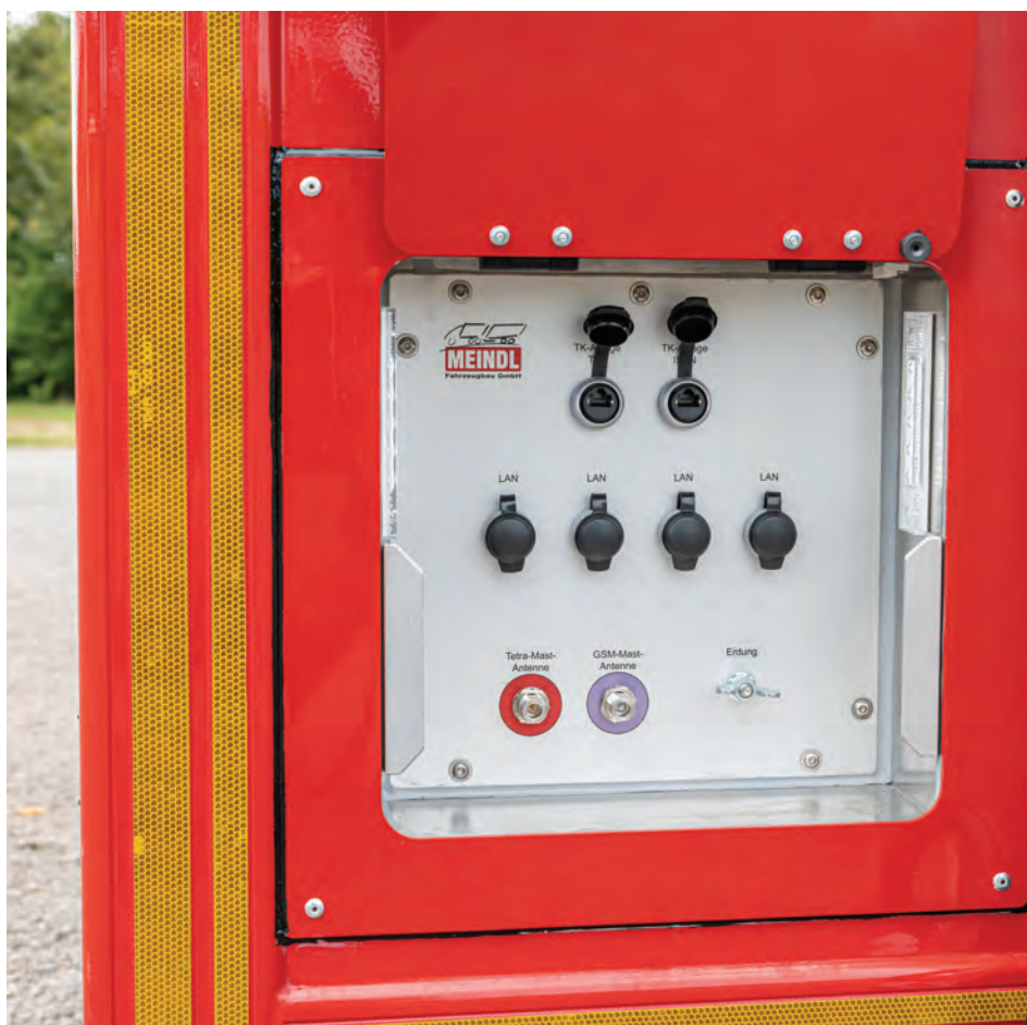
Abbildung 28: Detail – MEINDL-Übergabeeinheit mit LuK-Anschlussfeld. Es sind hier zusätzliche Anschlüsse nach Ihren Vorgaben möglich. Der Zugang erfolgt durch eine abschließbare Klappe, das Anschlussfeld ist automatisch nach Öffnen der Klappe beleuchtet.
