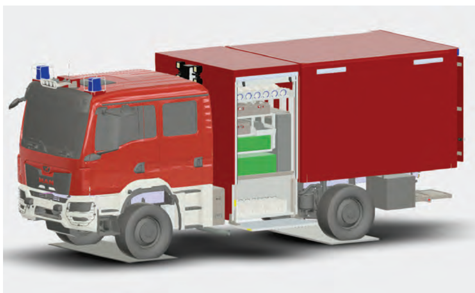
Abbildung 22: 2010507 Gerätewagen GW-L2, abgesetzte Bauweise für höchste Geländetauglichkeit, Aufbauausführung: Kofferaufbau mit seitlich demontierbaren festen Schlauchfächern und einzelnen Schlauchtüren links und rechts der Ladebordwand.
