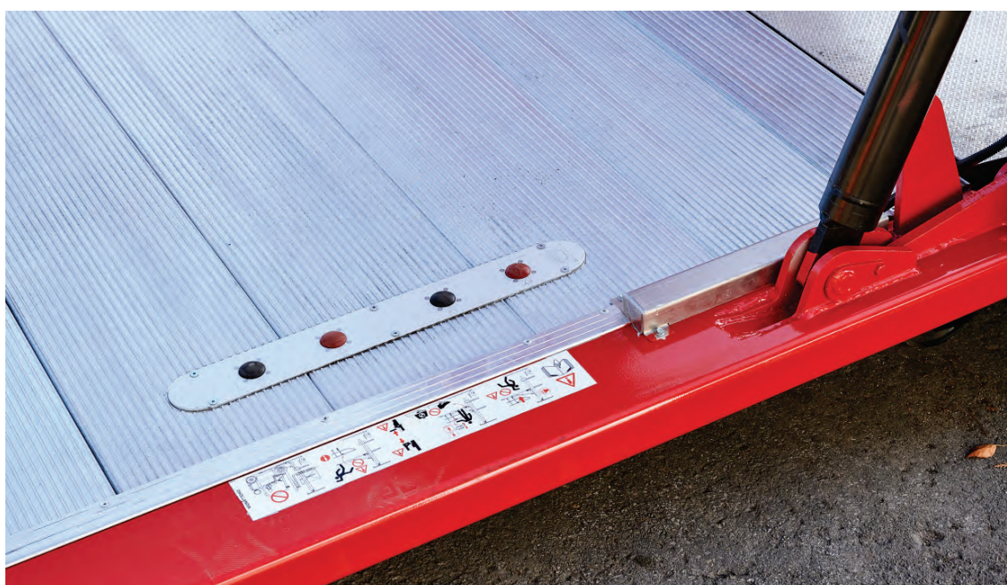
Abbildung 17: Detail – Fußsteuerung in der Plattform (Serie).
