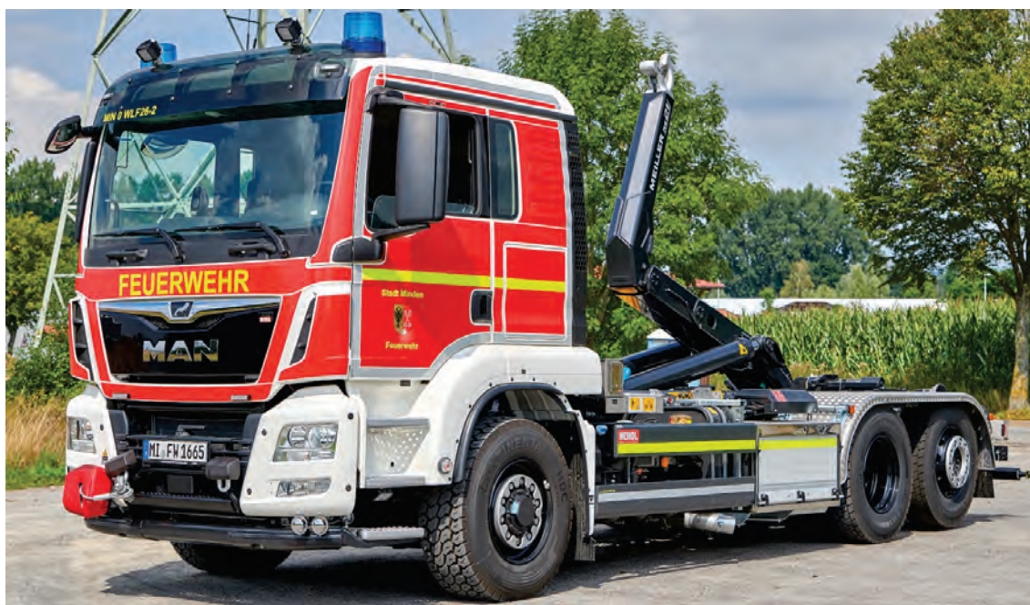
Abbildung 2: WLF 26/6900 auf MAN TGS-Fahrgestell mit HydroDrive (1. Achse hydraulisch angetrieben) und maschineller Zugeinrichtung ROTZLER TREIBMATIC TR 030 ( \geq 50 kN Nennzugkraft).
