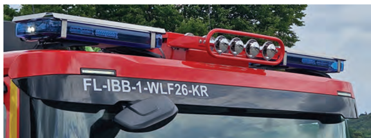
Abbildung 61: Astschutz, Edelstahl (Schraubversion) für Hänsch DBS 850 LED.
