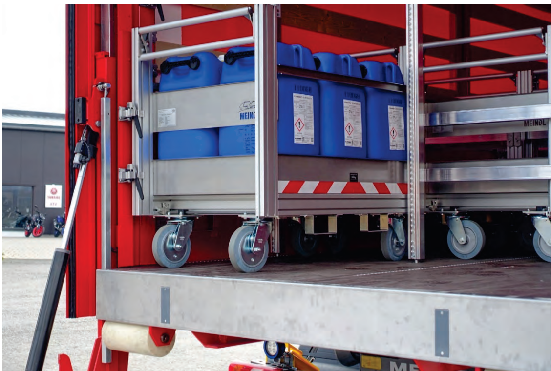
Abbildung 12: Detail – Glatter Edelstahl-Bodenabschluss, Heckportal, Kunststoff-Ablaufrollen.
