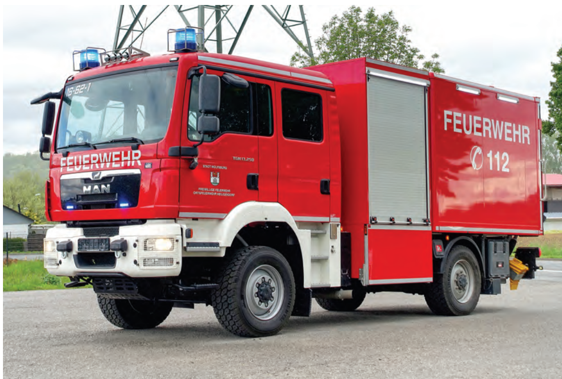
Abbildung 24: GW-L2 auf MAN TGM 4x4-Fahrgestell mit Staffelnkabine. Ausführung Kofferaufbau (hier FerroFoam®-Bauweise), tiefgezogener separater Geräteraum für höchste Geländetauglichkeit. MEINDL-Kraftstofftank und Batterieanlage schafft Platz für große tiefgezogene Geräteräume.
