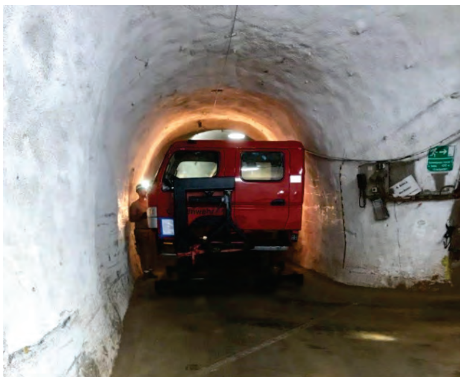
Abbildung 6: Transport des Segmentes „Fahrerhaus“ unter Tage.
