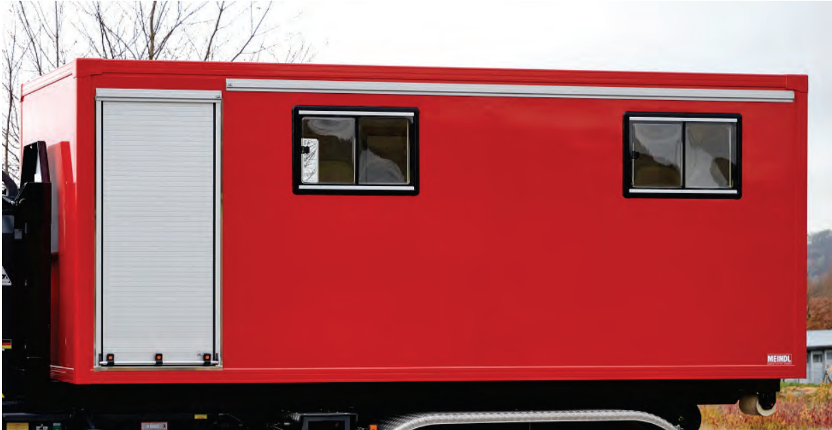
Abbildung 1: AB Besprechung mit vorderen abgetrennten Geräteräumen mit Rollläden, Kunststoff-Sandwichbauweise. LED-Umfeldbeleuchtung über die gesamte Aufbauhöhe.
