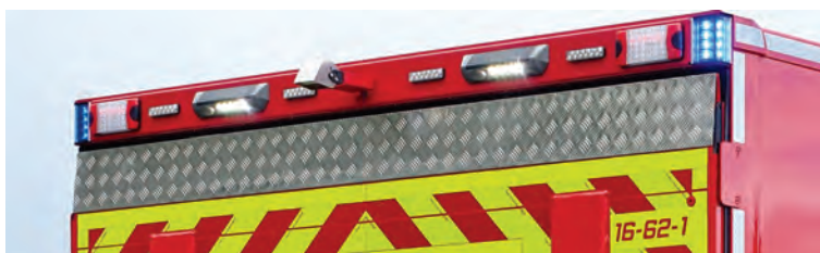
Abbildung 69: Feststehende Heckkonsole – Ladebordwand geschlossen.
