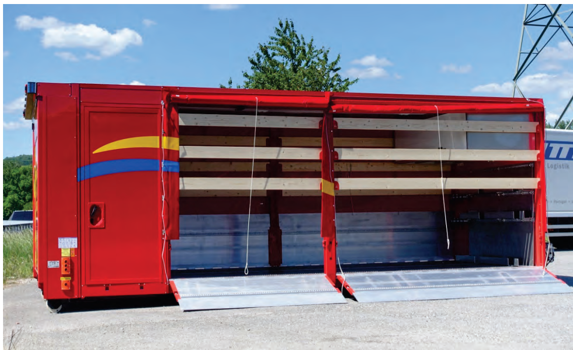
Abbildung 9: Detail – Seitliche Rollplanen geöffnet. Nach Lösen der Planen seitlich und unten rollen diese durch eingelassene Drehfedern selbsttätig nach oben hin auf.
