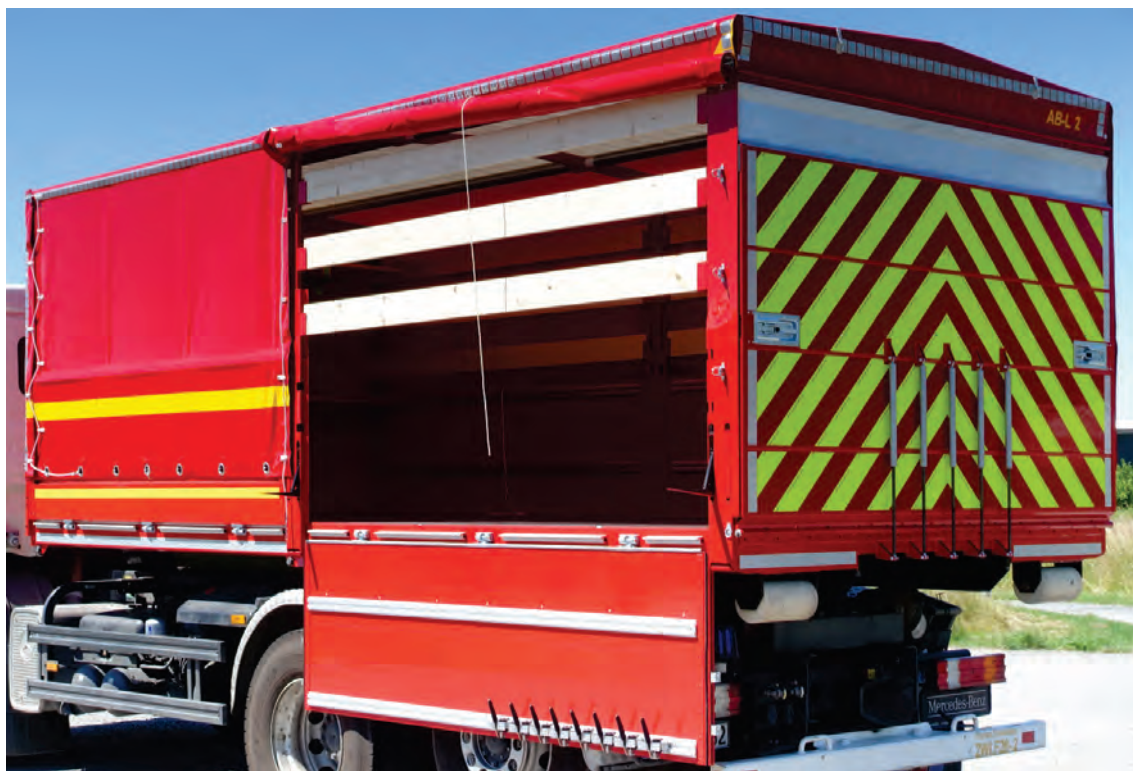
Abbildung 9: Detail – Seitliche Rollplanen geöffnet. Nach Lösen der Planen seitlich und unten rollen diese durch eingelassene Drehfedern selbsttätig nach oben hin auf.
