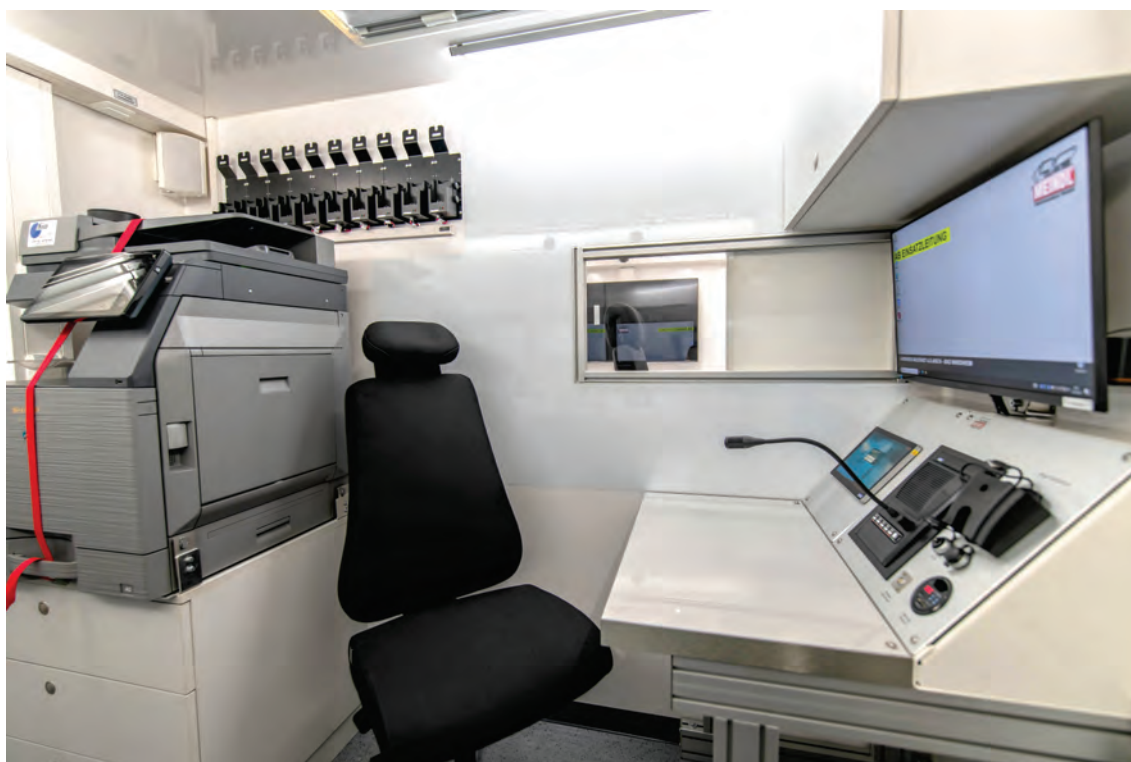
Abbildung 20: Detail – AB ELW 2 Kommunikationsraum: Einzel-Funkarbeitsplatz, links im Bild DIN-A3-Multifunktionsgerät mit den Funktionen: drucken, kopieren, scannen und faxen.
