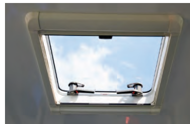
Abbildung 52: Standard-Dachfenster mit Rollos für Insektenschutz und Rollos für Sonnenschutz.
