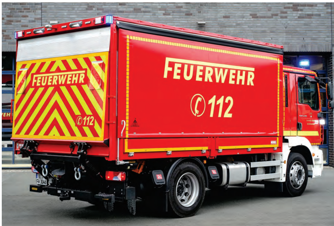
Abbildung 1: GW-L1 auf MAN TGM 4x2-Fahrgestell. Ausführung Pritschenaufbau mit Schiebeplane. Planenbefestigung mit „unsichtbaren“ Edelstahlspannern auf den seitlichen Bordwänden (schwimmend gelagert), dadurch ist eine glattflächige Planengestaltung möglich.
