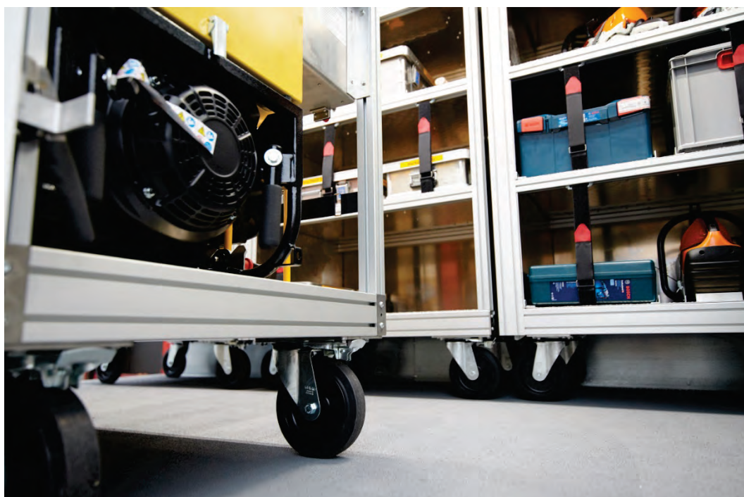
Abbildung 37: Detail – Ladeflächenboden kunststoffbeschichtet mit eingearbeitetem Granulat für höchste Rutschfestigkeit (>R11).
