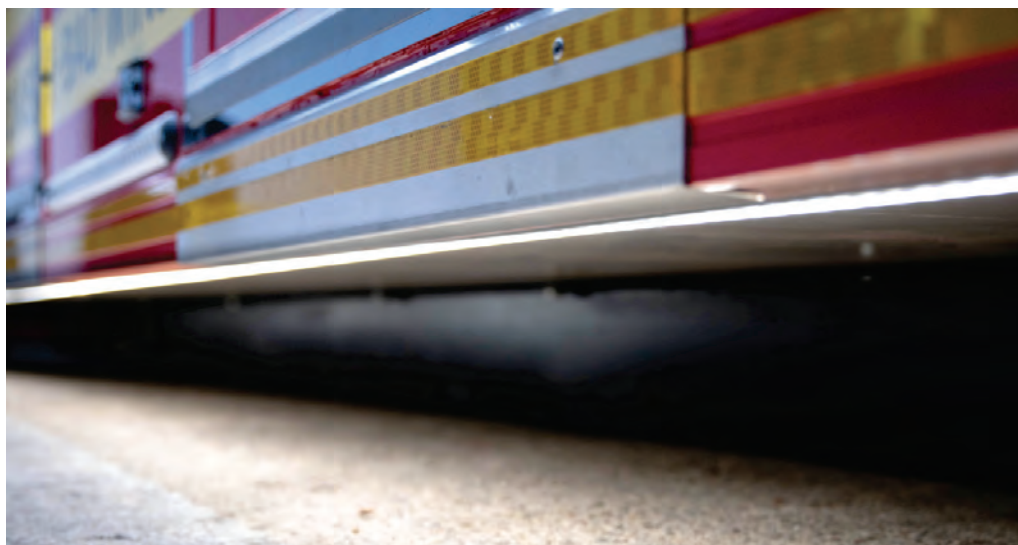
Abbildung 30: Detail – Unterflurbeleuchtung des Abrollbehälters als LED-Band über die gesamte Länge.
