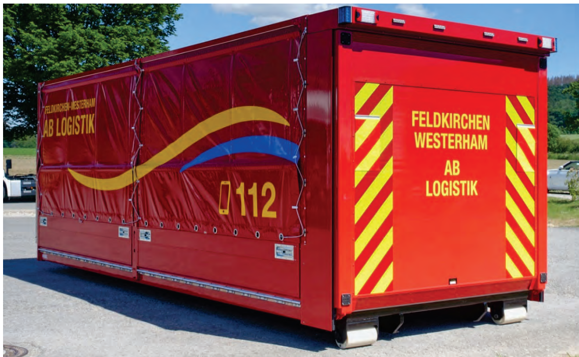
Abbildung 8: Durch seitliche Rollplane bedingt (anders als bei Schiebeplanen) kein glattes Erscheinungsbild der Plane.
