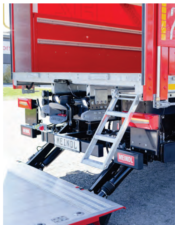
Abbildung 11: Detail – Feuerverzinkter Unterbau für optimalen Korrosionsschutz. Optionale Aufrittleiter – die Ladebordwand kann bei ausgezogener Leiter genutzt werden!
