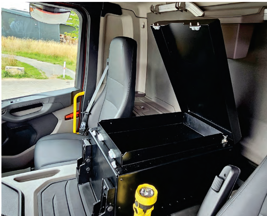
Abbildung 25: Detail – MEINDL-Konsolenkasten. Je nach Fahrgestell und Ihren Wünschen zur Aufnahme der Zentralelektrik, der Funktechnik und ggf. des Kompressors der Warnanlage oder nur als Ablage für DIN-A4-Ordner. Hier im Bild zur Unterbringung der Zentralelektrik mit oberer entnehmbarer Ablageschale. Der Deckel wird an beliebiger Stelle durch Friktionsscharniere gehalten.
