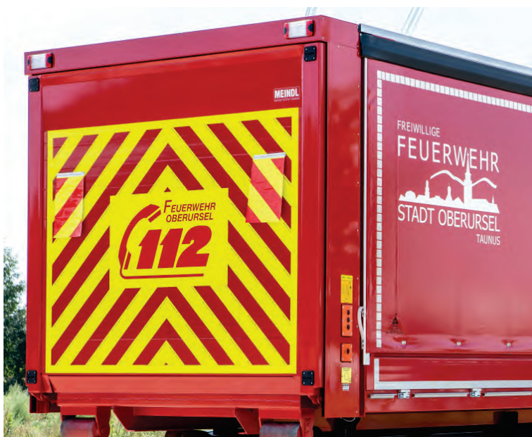
Abbildung 50: Heckschraffur-Kennzeichnung, seitliche Konturmarkierung, Beschriftung nach Vorgabe.
