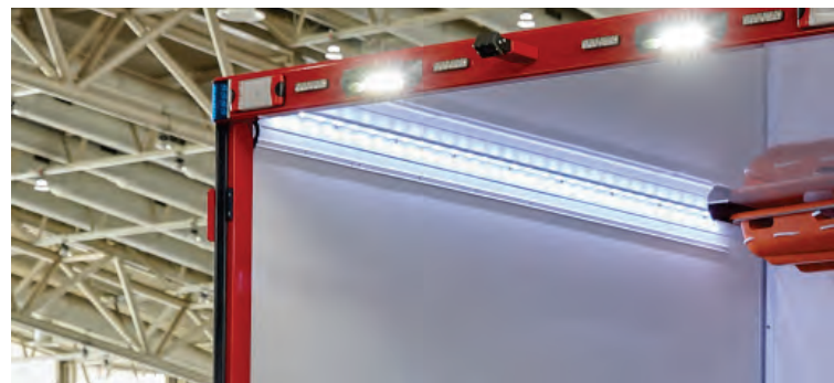
Abbildung 87: LED-Laderaumbeleuchtung (hier bei Ausführung Kofferaufbau).
