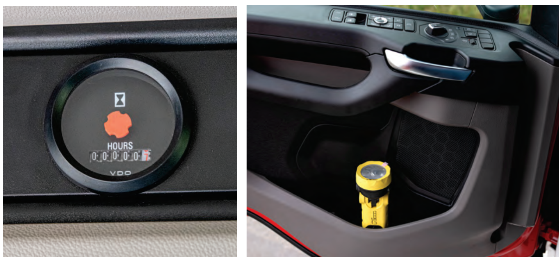
Abbildung 29: Detail – Links: Betriebsstundenzähler der Wechselladeranlage. Rechts: Ladehalterung für eine Adalit-Handlampe, montiert in der Türverkleidung (nicht bei allen Fahrzeugtypen darstellbar).
