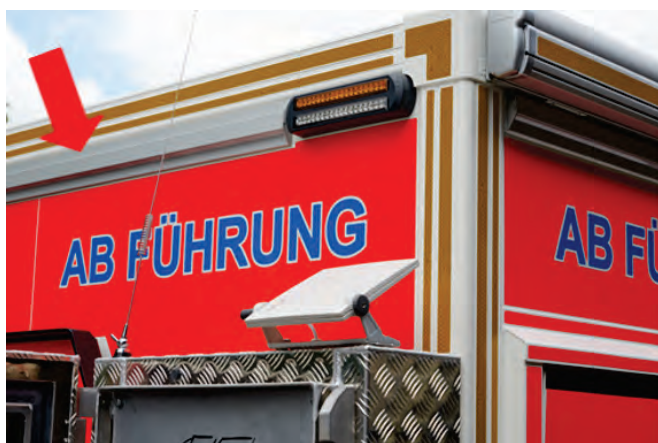
Abbildung 44: LED-Lichtstreifenelement Fabr. LDR, vorn und seitlich.
