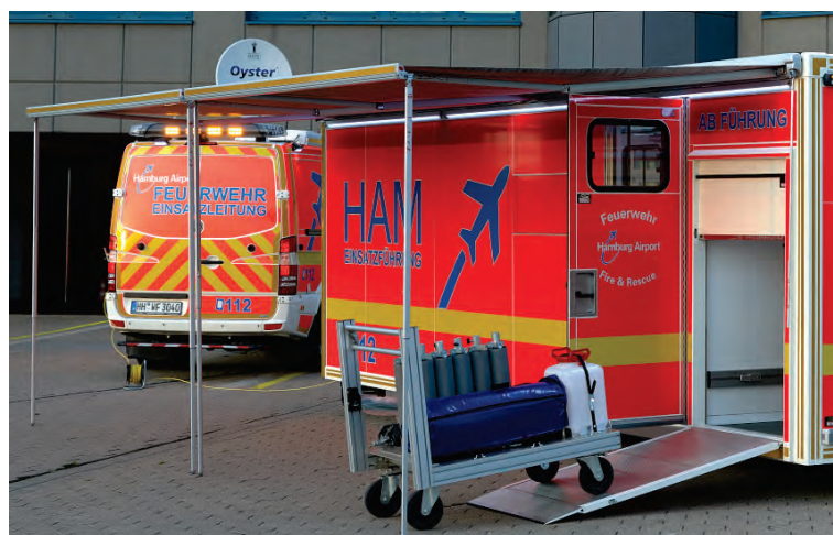
Abbildung 70: Seitlich montierte Markise mit Abstützung.
