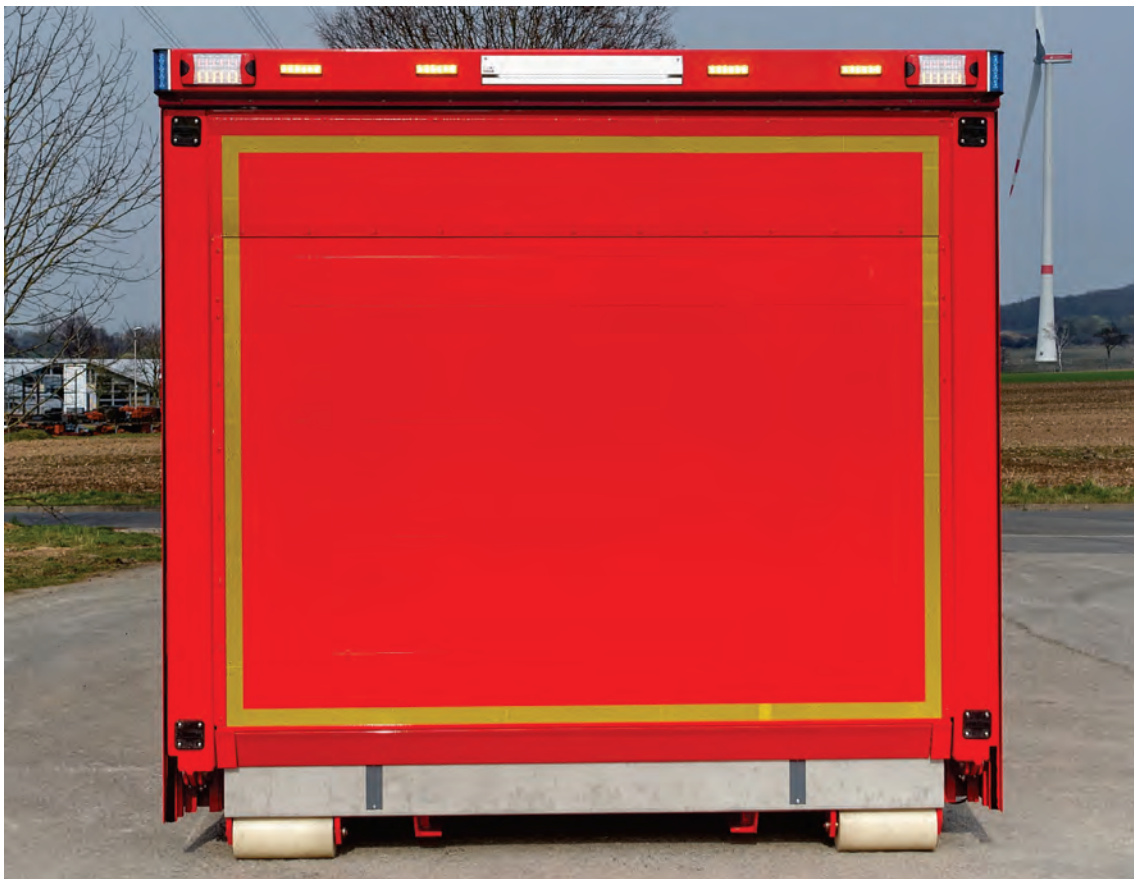
Abbildung 4: Heckansicht – glatte Ausführung der Plattform des Vertikalliftes, gut für Beschriftungen geeignet.
