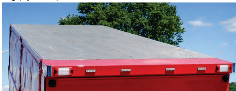
Abbildung 24: Festes Aluminiumdach in Alu-Gerstenkorn.
