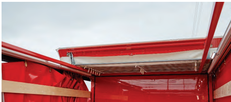
Abbildung 23: Schiebendach nach vorne hin geöffnet.
