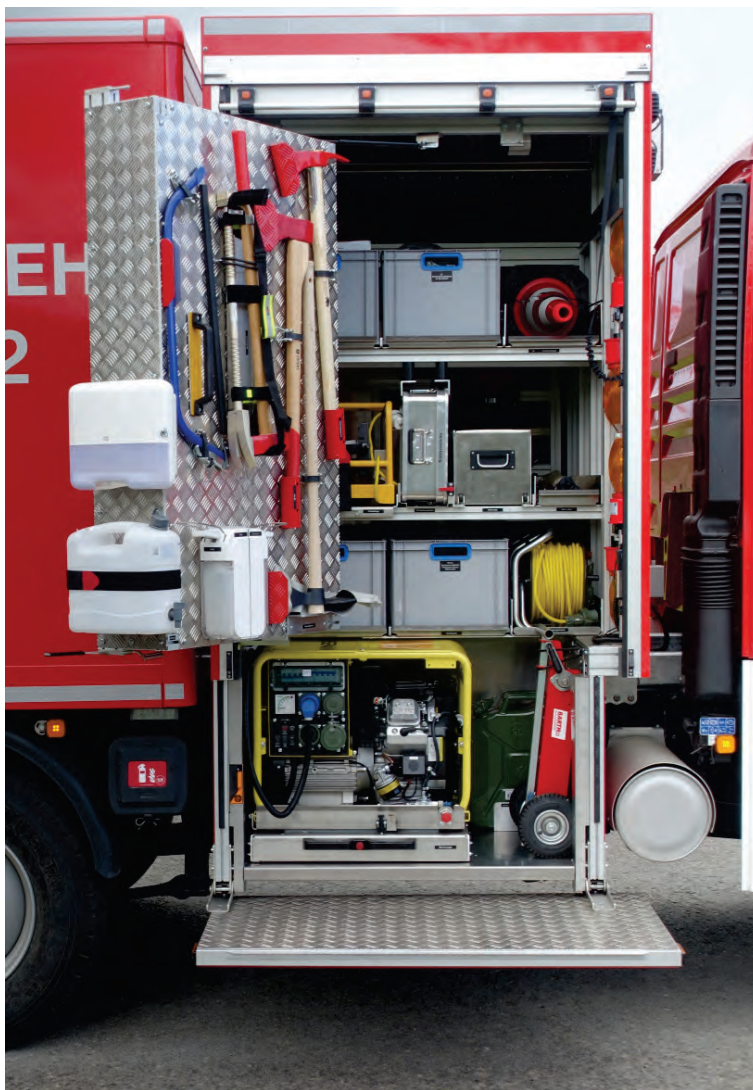
Abbildung 52: Schwenkwand mit MEINDL-Komfort-Verriegelung.
