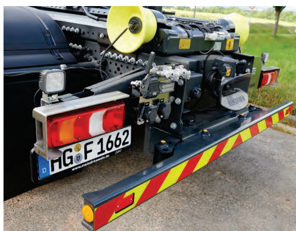
Abbildung 78: Hydraulisch verstellbarer Heck-Unterfahrschutz, hier eingefahren.
