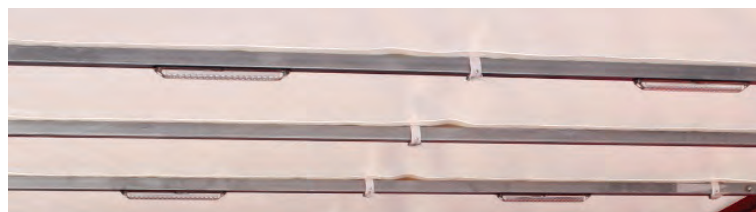
Abbildung 41: LED-Laderaumbeleuchtung (hier bei Ausführung Planendach).
