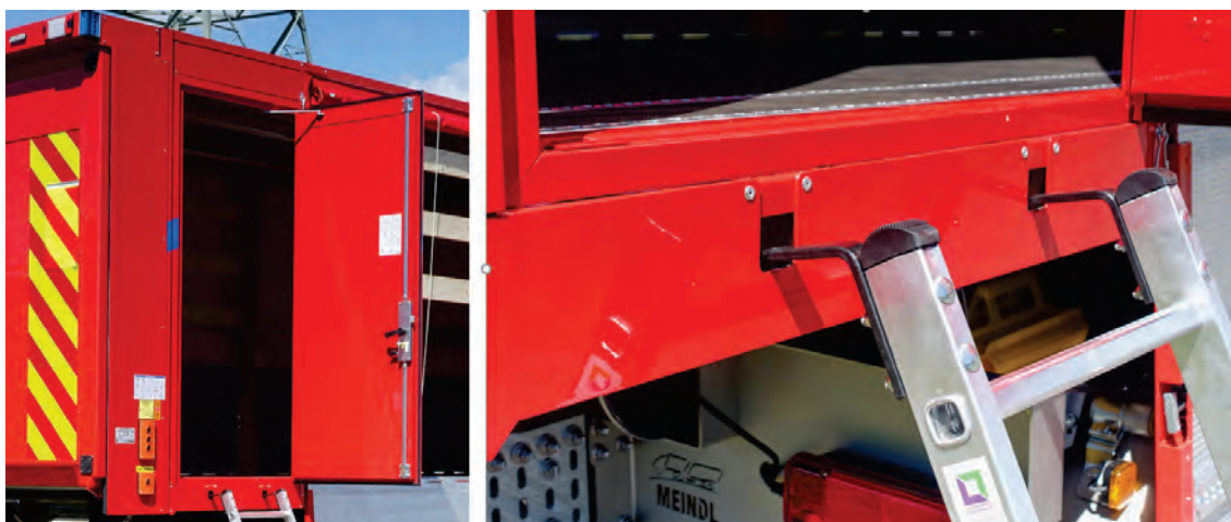
Abbildung 38: Seitentür hinten rechts vor dem Vertikallift, einhängbare Auftrittleiter.
