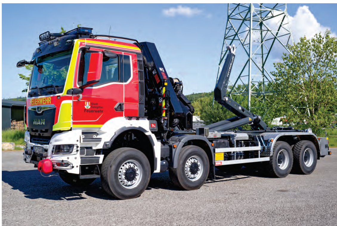
Abbildung 4: WLF 32/6900 auf MAN TGS-Fahrgestell mit Allradantrieb, hier mit 18 tm-Ladekran und maschineller Zugeinrichtung ROTZLER TREIBMATIC TR 030 ( \geq 50 kN Nennzugkraft).
